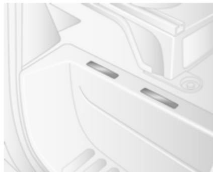
Le numéro d'identification du véhicule peut également être lu derrière un cache en plastique amovible sur le seuil de porte avant droite. Déclipser les couvercles à l'aide d'un tournevis à lame plate pou y accéder.
