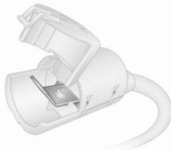
Si la batterie du véhicule est déchargée, la borne de démarrage par câbles auxiliaires permet le démarrage du véhicule sans devoir accéder à la batterie à l'intérieur du véhicule.
