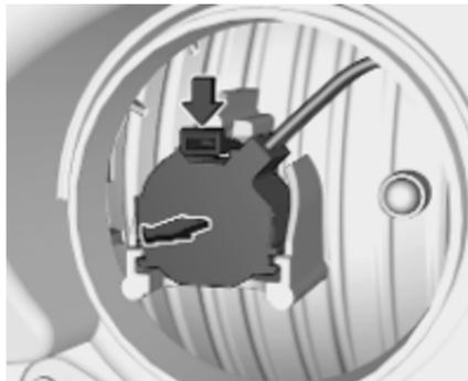
2. Pousser le clip de retenue vers le bas et tirer la douille d'ampoule vers l'arrière.
