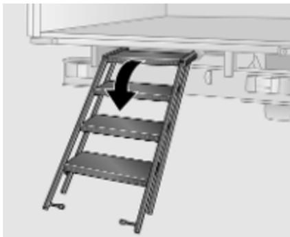
Déplier l'échelle et fixer la marche inférieure en position. Vérifier que le loquet s'engage bien et que les marches sont bien fixées avant de monter.
