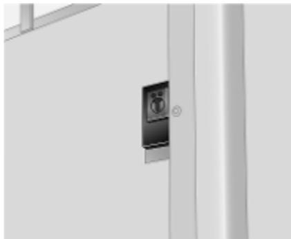
Appuyer sur le commutateur : l'éclairage fonctionne pendant environ 10 minutes.
