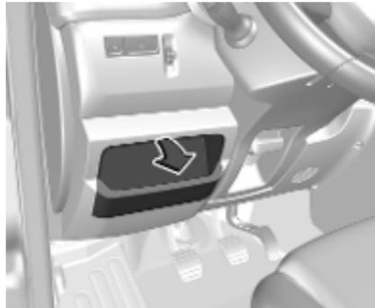
Située derrière le panneau de garnissage. Tirer sur la partie supérieure du panneau de garnissage pour l'enlever.
