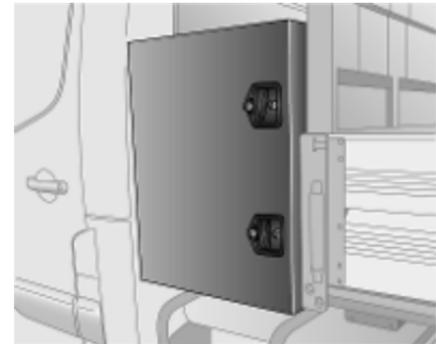
Déverrouiller à l'aide de la clé fournie et tourner les loquets pour ouvrir.
