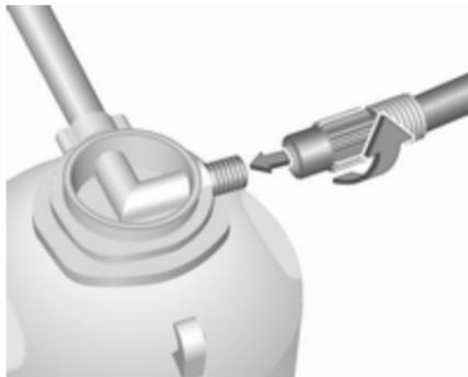
4. Visser le flexible à air du compresseur sur le raccord de la bouteille de produit d'étanchéité.
