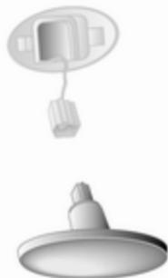
2. Débrancher le connecteur de l'ensemble de lampes.
