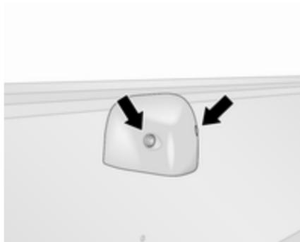
1. Déposer les deux vis du couvercle de la lentille.
