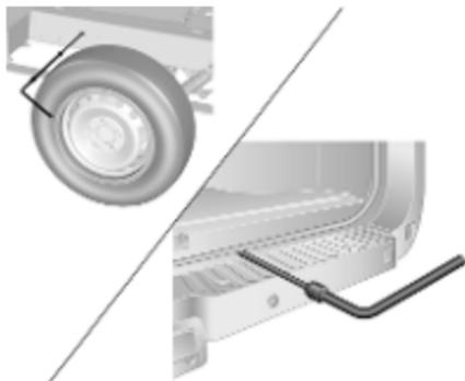
Pour libérer la roue de secours, desserrer le câble en raccordant la clé de roue et les adaptateurs (en fonction du véhicule) à la position oblongue illustrée et abaisser complètement la roue en tournant la clé dans le sens horaire.
