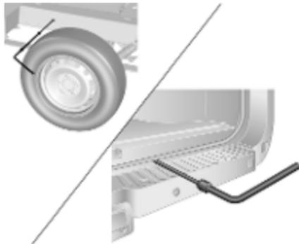
Serrer ensuite le câble à l'aide de la clé de roue et des adaptateurs en l'insérant dans la fente illustrée ci-dessus et en tournant la clé en sens antihoraire jusqu'à ce que la roue soit totalement relevée et fixée.
