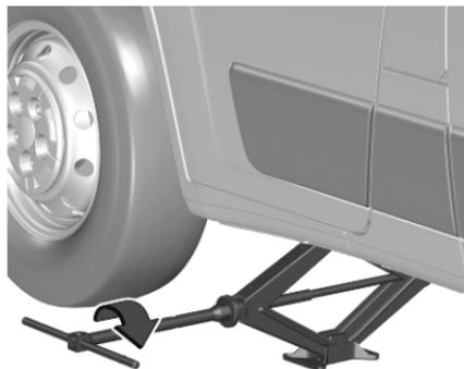
Avec le cric correctement aligné, tourner la clé de roue jusqu'à ce que la roue soit dégagée du sol.
