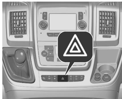
Pour les enclencher, appuyer sur
