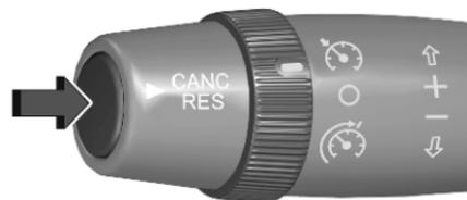
Enfoncer la pédale de frein, la pédale d'embrayage ou appuyer sur le bouton. Le régulateur de vitesse est en mode pause. Le véhicule est conduit sans régulateur de vitesse.
