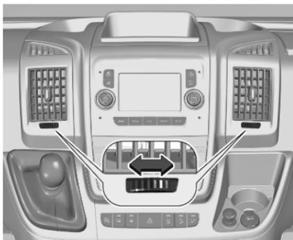
Régler le débit d'air venant de la bouche d'aération en tournant la molette. La bouche est fermée lorsque la roue moletée est tournée pour être fermée vers la gauche ou la droite.
