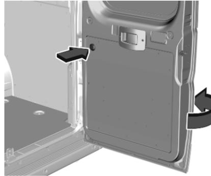
Pour ouvrir les portes à 180° ou plus (selon le modèle), libérer les béquilles de verrouillage en appuyant sur le bouton. Faire basculer les portes pour les ouvrir dans la position souhaitée.
