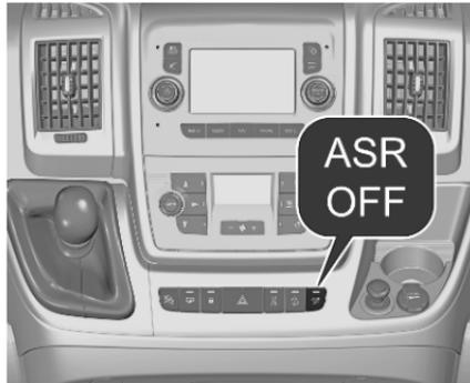
Le système antipatinage (TC) peut être désactivé chaque fois que nécessaire en appuyant sur **ASR OFF**.
