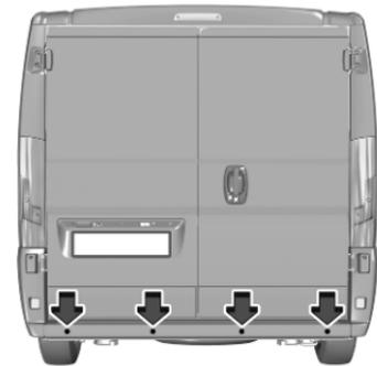
Le système avertit le conducteur des obstacles potentiellement dangereux présents derrière le véhicule à une distance allant jusqu'à 50 cm par des signaux sonores, lorsque la marche arrière est sélectionnée.
