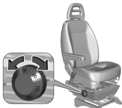
Tourner le bouton pour régler la sensibilité du siège à suspension en fonction du poids du conducteur.
