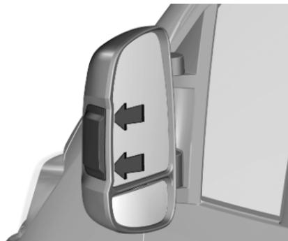
1. Déposer les deux vis de fixation.
