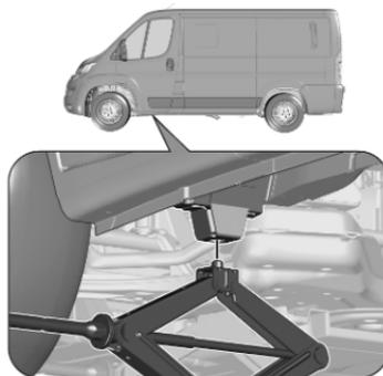
3. S'assurer que le cric est correctement positionné sous le point de levage du véhicule concerné, près de la roue avant.
