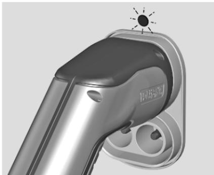
La DEL située au-dessus du port de charge s'allume pour indiquer que la fiche du véhicule est verrouillée.
