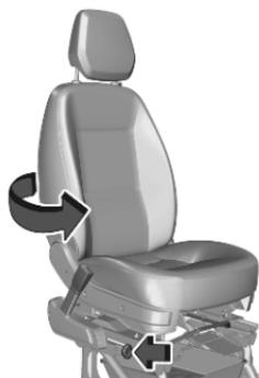
Appuyer sur le bouton de commande et faire pivoter le siège.
