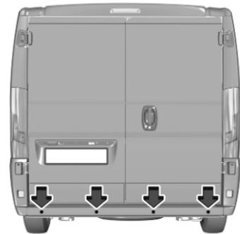
Le système utilise des signaux sonores pour avertir le conducteur de la présence d'obstacles potentiellement dangereux derrière le véhicule pendant que la marche arrière est engagée.
