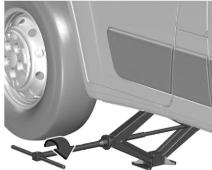
Avec le cric correctement aligné, tourner la clé de roue jusqu'à ce que la roue soit dégagée du sol.
