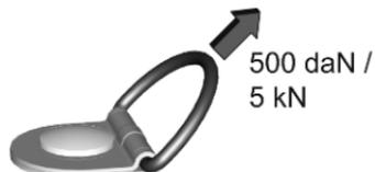
Les anneaux d'arrimage servent à sécuriser les objets pour éviter qu'ils ne glissent, par exemple avec des sangles de serrage ou le filet à bagages.
