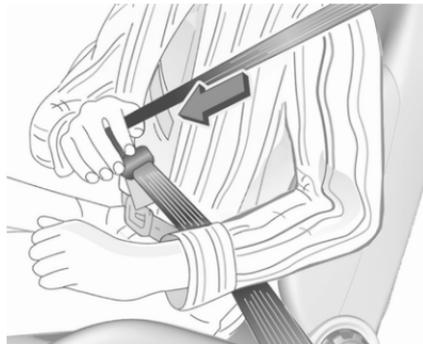
Tirer la ceinture de sécurité hors de l'enrouleur, la guider sur le corps sans la vriller et insérer la languette de verrouillage dans la boucle. S'assurer que la sangle est bien serrée sur le corps pendant la conduite.
