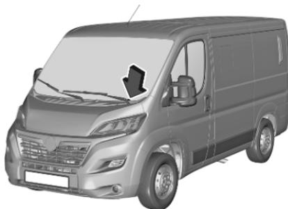
Le numéro d'identification du véhicule est en relief sur le tableau de bord, visible à travers le pare-brise.
