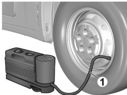
1. Dévisser le bouchon de valve du pneu défectueux.
