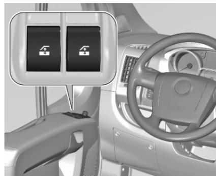
Manipuler le commutateur de la vitre respective en l'enfonçant pour ouvrir ou en le relevant pour fermer.
