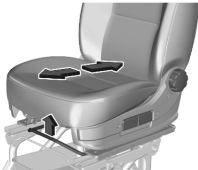
Tirer la poignée, déplacer le siège et relâcher la poignée. Essayer de déplacer le siège vers l'arrière et l'avant pour s'assurer que le siège est verrouillé en place.
