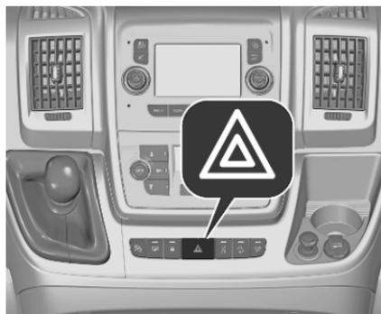
Pour les enclencher, appuyer sur
