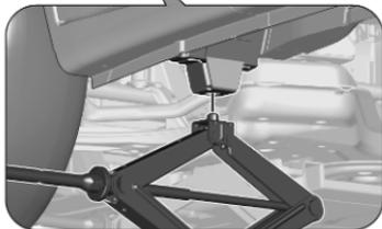
3. S'assurer que le cric est correctement positionné sous le point de levage du véhicule concerné, près de la roue avant.
