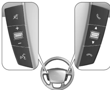
Les commandes au volant peuvent être utilisées pour les fonctions audio et téléphone.
