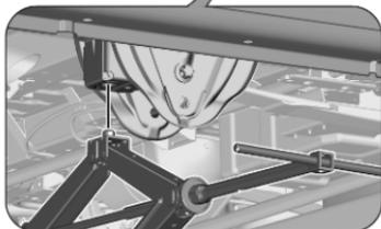
4. S'assurer que le cric est correctement positionné sous le point de levage du véhicule concerné, près de la roue arrière.
