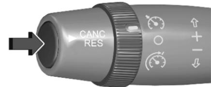
Appuyer sur le frein, la pédale d'embrayage ou appuyer sur le bouton à l'extrémité du levier. Le régulateur de vitesse est en mode pause. Le véhicule est conduit sans régulateur de vitesse.
