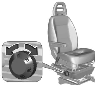
Tourner le bouton pour régler la sensibilité du siège à suspension en fonction du poids du conducteur.
