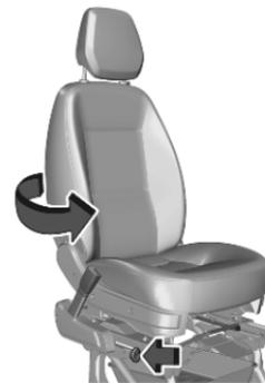
Appuyer sur le bouton de commande et faire pivoter le siège.
