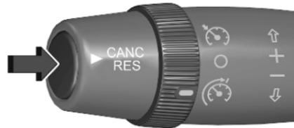
Appuyer sur le bouton à l'extrémité du levier pour activer le système.
