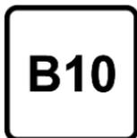
Carburant diesel respectant la norme EN16734 mélangé à un biocarburant respectant la norme EN14214 (avec possiblement jusqu'à 10 % d'ester méthylique d'acide gras)
