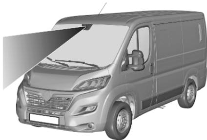
L'alerte de collision avant utilise la caméra avant du pare-brise pour détecter un véhicule qui précède directement devant, dans la trajectoire du véhicule.
