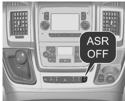
Le système antipatinage peut être désactivé, chaque fois que c'est nécessaire : appuyer sur **ASR OFF**.
