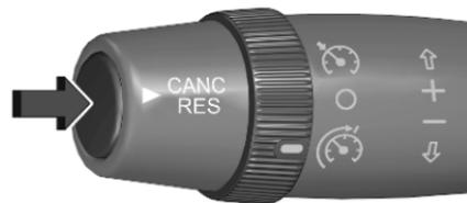
Appuyer sur le bouton à l'extrémité du levier pour désactiver la fonctionnalité. Le limiteur de vitesse est en mode pause et un message s'affiche.
