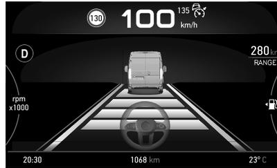
Lorsque les mains sont retirées du volant, le système ne se désactive pas automatiquement, mais après quelques secondes : certains écrans dédiés apparaissent successivement sur l'écran du tableau de bord, pour avertir le conducteur qu'il doit remettre ses mains sur le volant (voir la description ci-dessous).
