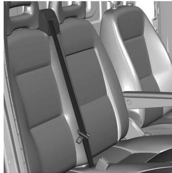
La banquette avant biplace est équipée d'une ceinture de sécurité embarquée (enrouleur sur le siège) avec trois points d'ancrage pour la position centrale.
