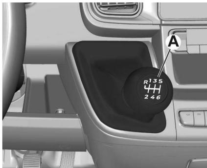
Pour engager la 6<sup>e</sup> vitesse (selon équipement), actionner le levier en le poussant vers la droite afin d'éviter d'engager la 4<sup>e</sup> vitesse par erreur. Il en va de même pour le passage de la 6<sup>e</sup> à la 5<sup>e</sup> vitesse.
