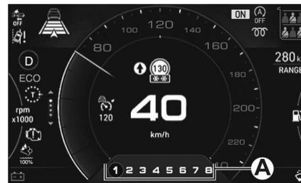
Grâce au GSI, le conducteur est informé que le changement de vitesse permettra de réduire la consommation de carburant.
