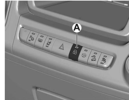
Il s'agit d'un dispositif de sécurité qui empêche le fonctionnement des poignées intérieures.
