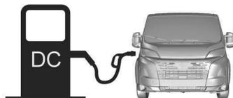
Dans certains pays, un adaptateur CHAdeMO fourni dans le sac à outils peut être nécessaire pour la connexion à une station de courant continu.
