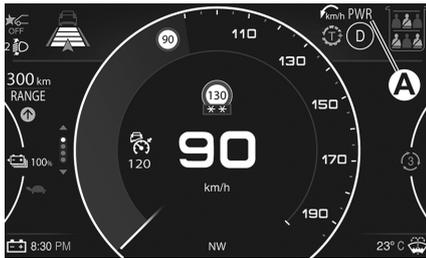
La fonction "Mode de conduite", utilisant l'électronique embarquée, agit sur la transmission et s'interface avec le tableau de bord. L'engagement de la fonction du mode de conduite requis est indiqué sur l'écran du tableau de bord. le mode "Normal" est automatiquement activé au démarrage du moteur.
