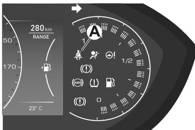
À une vitesse supérieure à 20 km/h, si l'un des passagers arrière détache sa ceinture de sécurité, le voyant d'avertissement correspondant s'allume, accompagné d'un signal sonore pendant environ 105 secondes. Une fois ce temps écoulé, le voyant reste allumé jusqu'au rebouclage de la ceinture de sécurité.
