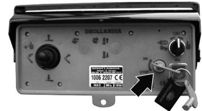
Un **coupe-batterie** intégré dans le panneau de commande externe. L'interrupteur permet à l'opérateur de mettre en marche ou d'arrêter la batterie principale du hayon
