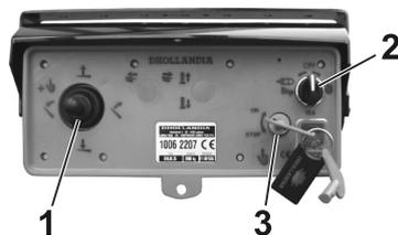
Tourner dans le sens horaire pour mettre la batterie en marche. Tourner dans le sens anti-horaire pour couper la batterie
