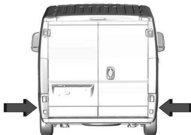
Le système avertit le conducteur de la présence de véhicules dans la zone de détection en allumant, du côté concerné, le voyant d'avertissement lumineux situé sur le rétroviseur extérieur, ainsi qu'un avertissement sonore. Lorsque le véhicule démarre, le voyant d'avertissement s'allume pour signaler au conducteur que le système est actif.
