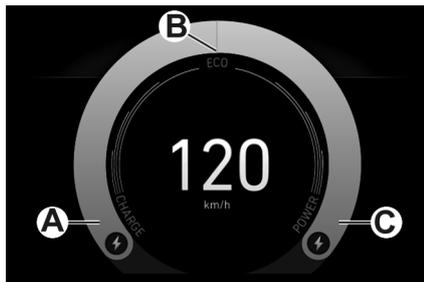
En appuyant sur les commandes au volant  $\triangle$  /  $\nabla$  et en les relâchant, un autre écran s'affiche, qui indique le mode de conduite au lieu de la vitesse. Le style de conduite est indiqué en temps réel par un curseur qui peut être positionné dans les zones suivantes :
