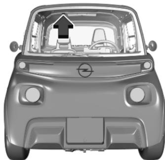
Le numéro d'identification du véhicule est estampé sur le toit à l'intérieur du véhicule.
