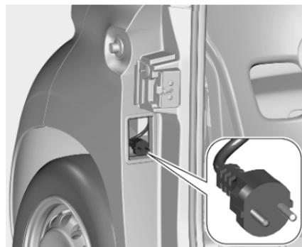
Le câble de chargement est fixé en permanence au véhicule. Il est rangé dans le cadre de porte de la porte droite.
