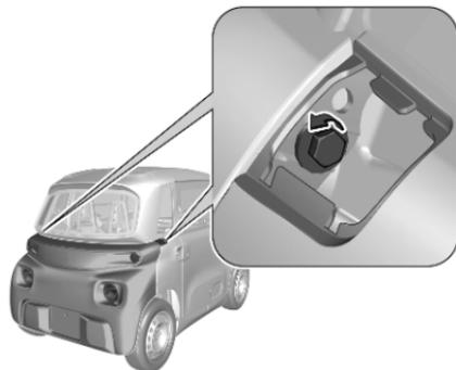
4. Déposer les deux vis de fixation latérales supérieures des volets.
