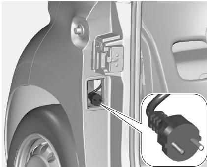
Le câble de charge est solidaire du véhicule. Il est rangé dans un logement, situé dans l'encadrement de la porte passager sous la gâche.
