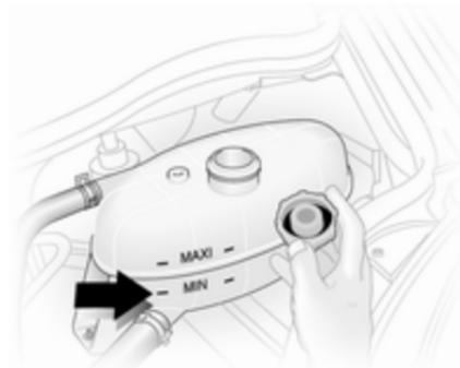
Si le système de refroidissement est froid, le niveau de liquide de refroidissement doit se trouver juste au-dessus du repère **MIN**. Faire l'appoint si le niveau est bas.
