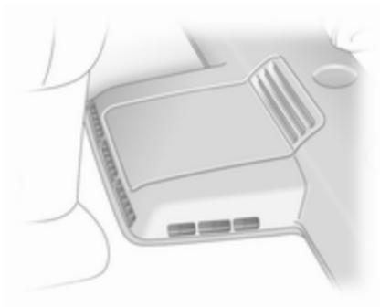
La soufflerie de chauffage de l'habitacle arriere contribue à faire circuler l'air vers l'habitacle arriere via les bouches d'aération arriere.
