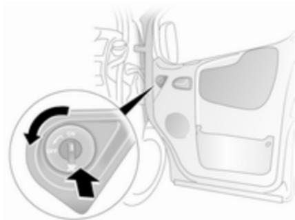
Le système d'airbags pour passager avant peut être désactivé via un commutateur situé sur la porte du passager avant.
