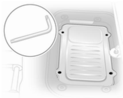
La batterie se situe sous le panneau de plancher de siège avant gauche. Soulever le recouvrement de sol et
