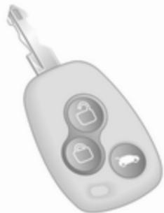
Grâce au verrouillage sélectif, l'habitacle et le coffre sont déverrouillés et verrouillés indépendamment.
