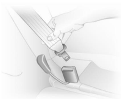
Avant de boucler la ceinture, d'abord introduire le verrou plat dans la serrure sur l'extérieur du siège.
