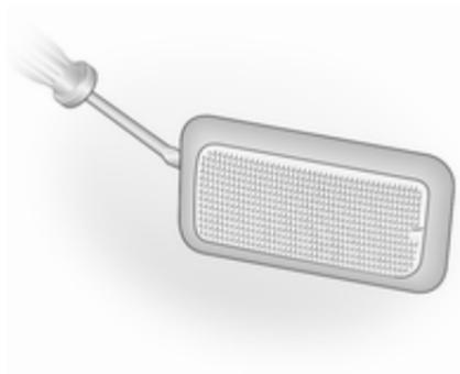
1. Enlever l'ensemble de lampe à l'aide d'un tournevis à lame plate.
