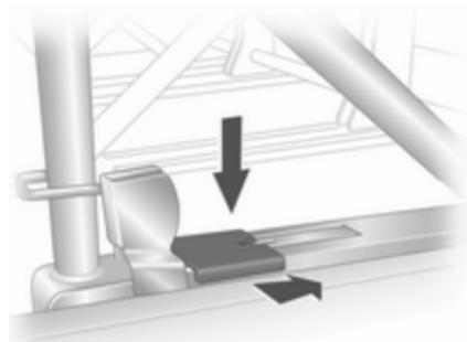
Libérer les sièges en enfonçant et en couissant vers l'avant le loquet de verrouillage situé à gauche et à droite des fixations de siège.
