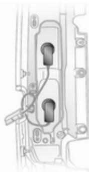
3. Pivoter la douille d'ampoule pour la détacher de l'ensemble du feu.
