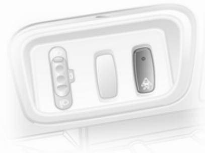
Quand le patinage des roues motrices est nécessaire, il est possible de désactiver l'ESP<sup>®</sup>Plus :
