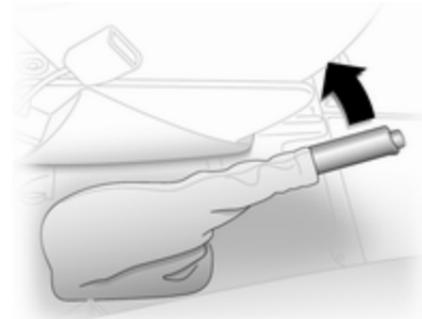
Serrer toujours le frein de stationnement sans actionner le bouton de déverrouillage. Dans une pente ou dans une côte, le serrer aussi fort que possible.
