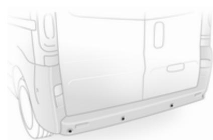
L'aide au stationnement facilite les manœuvres de stationnement en arrière en mesurant la distance entre l'arrière du véhicule et les obstacles. C'est toutefois le conducteur qui reste pleinement responsable du stationnement.
