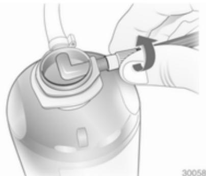
3. Visser le flexible à air du compresseur sur le raccord de la bouteille de produit d'étanchéité.
