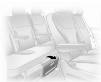
Afin de permettre de glisser de longs objets à ranger sous les sièges, il est possible de déclipser le recouvrement de garnissage du siège central.
