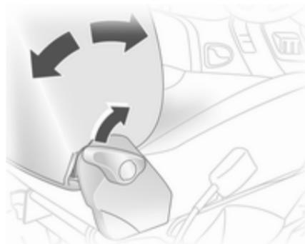
Tirer le levier, régler l'inclinaison et relâcher le levier. Laisser le siège s'encliquer. Ne pas s'appuyer sur le dossier pendant le réglage.
