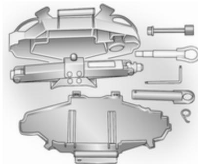
Le cric, les adaptateurs, la clé à cliquet, la clé Torx, le crochet pour cache-moyeu, l'œillet de remorquage et l'outil de sécurité pour la roue de secours sont contenus dans un boîtier qui est rangé sous le siège du conducteur.
