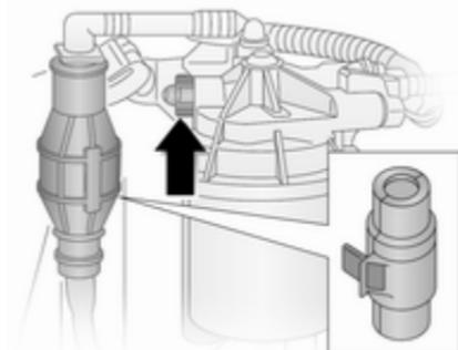
En cas de panne sèche, il sera nécessaire de purger l'air du circuit d'alimentation en gazole (diesel).
