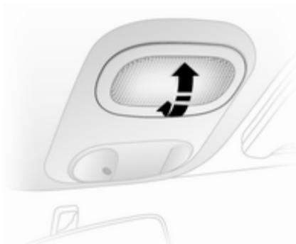
Commande en basculant la lentille.
