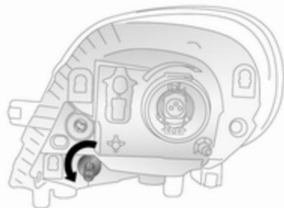
1. Enlever la douille de l'ampoule du boîtier de réflecteur en la faisant tourner de 90°.
