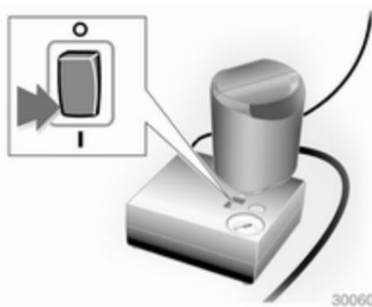
9. Placer le commutateur à bascule du compresseur sur I. Le pneu est rempli de produit d'étanchéité.
