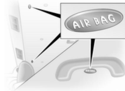
Le système d'airbags rideaux se compose d'un airbag de cadre de toit, de chaque côté du véhicule. Ceci est reconnaissable à l'inscription **AIRBAG** sur le garnissage du pavillon de toit.
