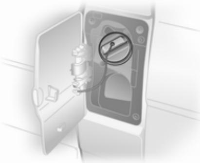
Pour déverrouiller et ouvrir le bouchon de remplissage, introduire la clé et tourner dans le sens antihoraire. Quand le plein a été effectué, replacer le bouchon de remplissage et tourner la clé aussi loin que possible dans le sens horaire.
