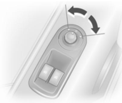
Sélectionner le rétroviseur extérieur correspondant et le régler.
