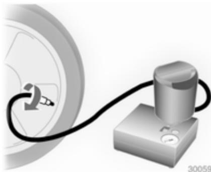
6. Visser le flexible de remplissage sur la valve du pneu.
