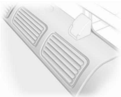
Le débit d'air est réparti entre les bouches d'aération centrales et droites pour une distribution optimale.
