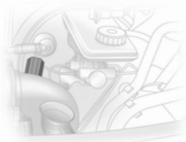
Sur certains modèles, un témoin est placé dans le système d'admission du moteur et indique si l'entrée d'air vers le moteur est obstruée.
