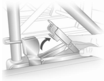
Avec les deux loquets relevés, pousser l'unité de siège vers l'arrière et les dégager des points d'ancrage au sol. Le siège peut maintenant être soulevé.
