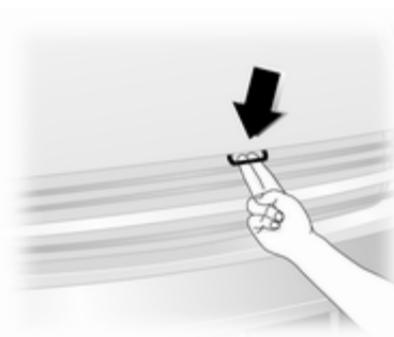
Tirer le verrou de sécurité et ouvrir le capot moteur.
