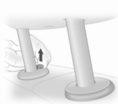
Pour déposer les appuis-tête, tirer le loquet et tirer l'appui-tête vers le haut. Ranger les appuis-tête en les attachant dans le coffre. Ne pas rouler avec l'appui-tête enlevé si le siège est occupé.
