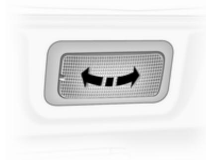
Commande en basculant la lentille.
