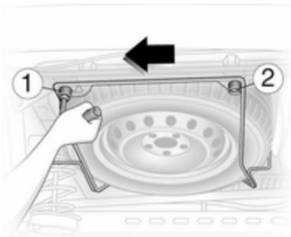
La roue de secours est montée sous le soubassement arrière et peut être attachée à l'aide d'une vis de sécurité qui ne peut être enlevée qu'à l'aide de l'outil fourni.
