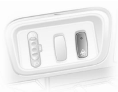
Quand le patinage des roues motrices est nécessaire, il est possible de désactiver l'antipatinage :
