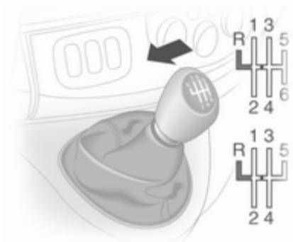
Pour passer la marche arrière, avec le véhicule à l'arrêt, enfoncer la pédale d'embrayage, soulever la bague du levier sélecteur puis engager le rapport au-delà du point dur.
