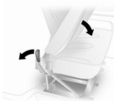
Pour faciliter l'accès aux sièges arrière, rabattre le dossier de siège vers l'avant. Si nécessaire, libérer la ceinture de sécurité à deux verrous plats de sa serrure.
