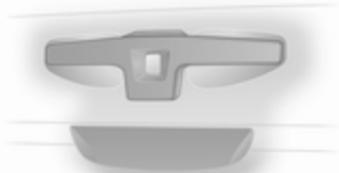
Après un déverrouillage à l'aide de la télécommande radio, appuyer sur le bouton du hayon et soulever le hayon en position totalement ouverte.
