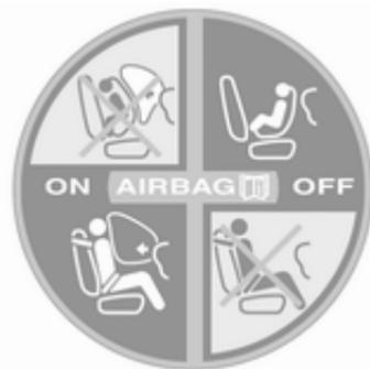
Le système de désactivation d'airbag est signalé par une étiquette sur le côté du tableau de bord, visible quand la porte du passager avant est ouverte.
