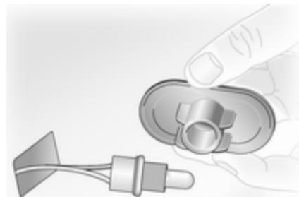
1. Libérer les clips en utilisant un tournevis à lame plate et soulever l'ensemble de feu à partir de l'ouverture.
