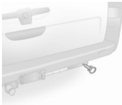
Les véhicules équipés d'un dispositif d'attelage disposent d'un trou taraudé pour l'œillet de remorquage amovible. Visser l'œillet de remorquage, fourni avec l'outillage du véhicule, à fond dans le trou taraudé.
