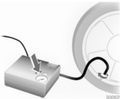
16. Reprendre la route sans délai afin que le produit d'étanchéité se répartisse uniformément dans le pneu. Après un trajet d'environ 10 km, mais pas plus de 10 minutes, s'arrêter et contrôler la pression du pneu à l'aide du compresseur. À cet effet, visser directement le flexible d'air sur la valve du pneu et le compresseur.
