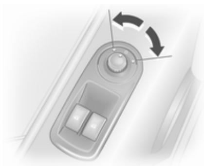
Sélectionner le rétroviseur extérieur concerné en tournant la commande vers la gauche ou la droite. En position centrale, aucun rétroviseur n'est sélectionné.
