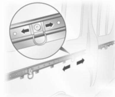
Les rails d'ancrage pour le chargement sont disposés dans le coffre et procurent des points d'ancrage réglables pour arrimer la cargaison.
