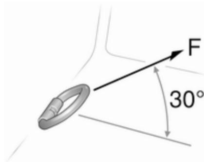
Les anneaux d'arrimage sont conçus pour attacher des objets afin qu'ils ne glissent pas, p. ex. en utilisant des sangles d'arrimage ou un filet à bagages.
