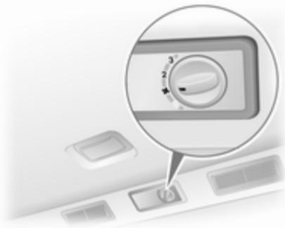
Le débit d'air est déterminé par la soufflerie. La température de l'air est contrôlée à l'aide de la commande de température sur le tableau de bord.
