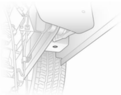
3. Soulever le véhicule en plaçant le téton de la tête du cric sous le logement de levage qui est le plus proche de la roue concernée.
