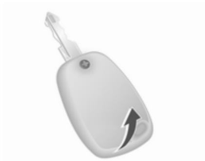
Enlever la vis et ouvrir le logement de pile en introduisant une pièce de monnaie dans la rainure et en la pivotant.
