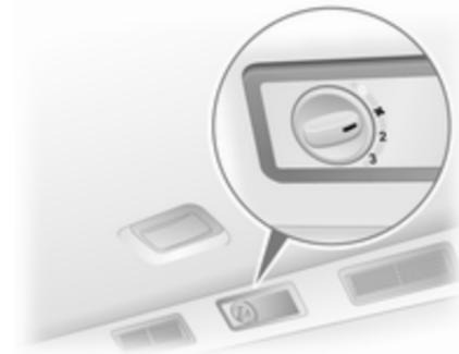
La soufflerie de climatisation arriere contribue à faire circuler l'air vers l'habitacle arriere via les bouches d'aération arriere.
