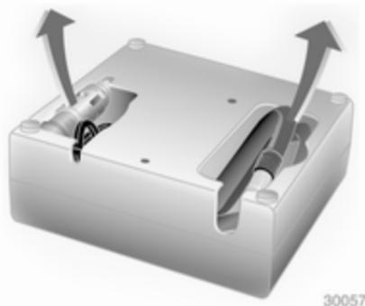
1. Sortir le compresseur du kit de réparation des pneus.
