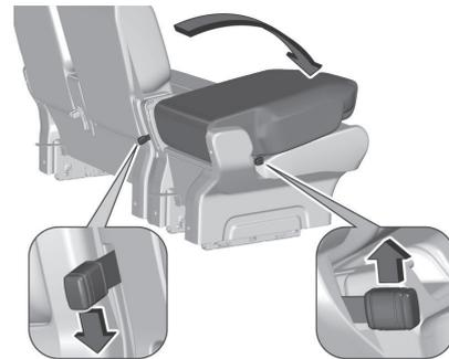
3. Tirer sur le levier avant ou pousser sur le levier arrière pour débloquer le dossier.
