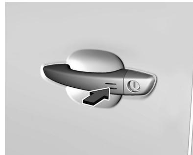
Appuyer sur l'une des poignées de porte ou sur le bouton du hayon. Toutes les portes, le coffre et la trappe de remplissage de carburant seront verrouillés.
