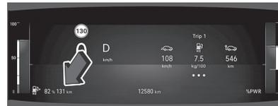
L'autonomie combinée (batterie haute tension et réservoir d'hydrogène) est affichée.
