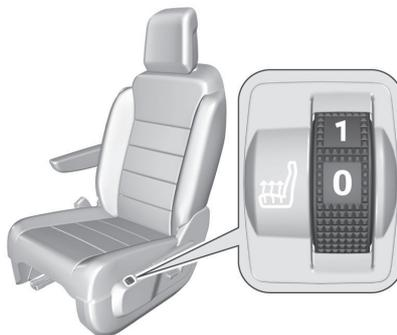
La molette de chauffage de siège se trouve au niveau du siège ou sur le tableau de bord.
