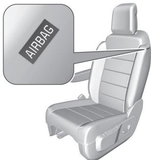
Le système d'airbags latéraux se compose d'un airbag dans chacun des dossiers de siège avant.
