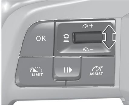
La vitesse présélectionnée peut être modifiée en déplaçant la molette sur  $\curvearrowright$  pour augmenter ou sur  $\curvearrowleft$  pour diminuer la vitesse. Déplacer la molette à plusieurs reprises pour modifier la vitesse par petits incréments ; déplacer et maintenir pour modifier la vitesse par grands incréments.
