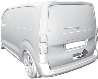
Après le déverrouillage, presser le bouton du hayon et ouvrir le hayon.
