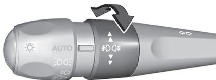
Faire tourner la bague de commande une fois pour activer ou désactiver le phare antibrouillard avant.
