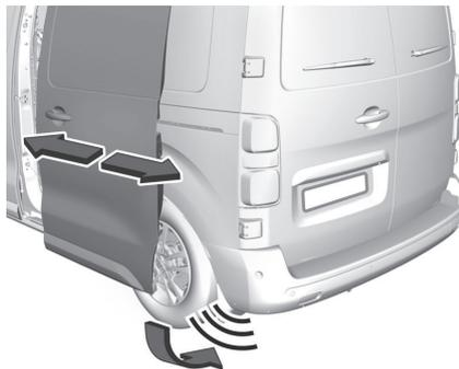
Pour ouvrir ou fermer une porte coulissante, bouger le pied d'avant en arrière sous le pare-choc arrière du côté de la porte.
