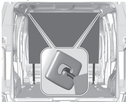
1. Des ouvertures de pose sont placées des deux côtés du cadre de toit. Ouvrir les couvercles s'ils sont présents.
