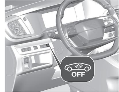
Désactiver la surveillance de l'habitacle quand des animaux sont laissés dans le véhicule en raison de la grande quantité de signaux ultrasoniques ou de leurs mouvements déclenchant l'alarme. Le désactiver également quand le véhicule est à bord d'un ferry ou d'un train.
