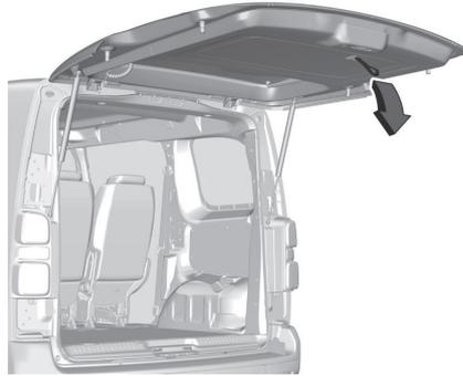
Pour abaisser le hayon, utiliser la poignée intérieure. Pousser le hayon d'en haut jusqu'à ce qu'il soit totalement fermé.
