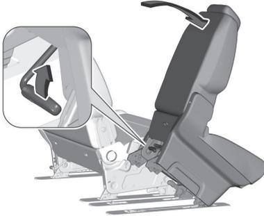
Tirer sur le levier de déblocage et basculer le siège vers l'avant. Pour rétablir la position d'origine, basculer le siège vers l'arrière jusqu'à ce qu'il se bloque.
