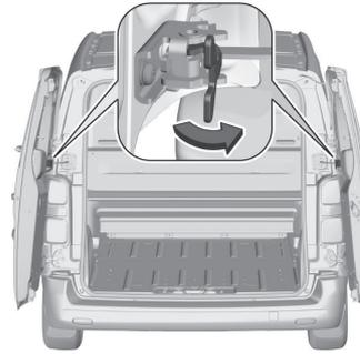
Les portes sont maintenues dans une position à 90°, grâce à des arrêteurs. Pour ouvrir les portes à 180°, pousser le loquet et faire pivoter la porte dans la position désirée.
