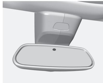
L'éblouissement causé par les véhicules qui suivent est automatiquement réduit en conduite de nuit.
