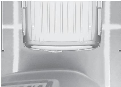
La caméra enregistre les environs du véhicule pendant la manœuvre pour reconstruire une vue depuis le haut du véhicule dans son environnement proche. Le véhicule peut alors être manœuvré autour des obstacles proches.
