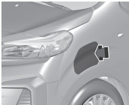
2. Appuyer sur la trappe du port de charge pour le dégager.
