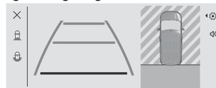
La première ligne horizontale représente une distance d'environ 30 cm au-delà du bord du pare-chocs arrière du véhicule. Les lignes horizontales supérieures représentent des distances d'environ 1
