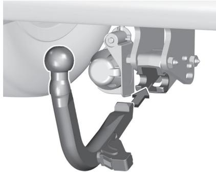
2. Insérer la barre d'attelage dans l'ouverture et pousser fermement jusqu'à la butée.
