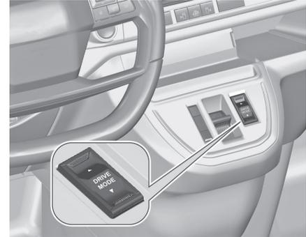
Pour sélectionner le mode de conduite correspondant, utiliser le commutateur à bascule indiqué. Les modes de conduite peut également être sélectionnés à la page Menu qui s'ouvre à l'écran d'information après avoir actionné le commutateur à bascule.
