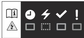
Le début de la charge est indiqué par le clignotement en vert de l'indicateur d'état sur le port de charge et sur son boîtier de commande, le cas échéant.
