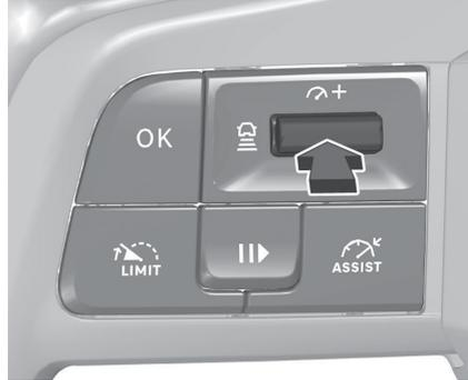
Appuyer sur le bouton pour afficher le réglage de la distance de sécurité actuel dans le centre d'information conducteur. Appuyer sur le bouton plusieurs fois pour sélectionner le réglage de sécurité. La distance de sécurité sélectionnée est indiquée par des barres entières sur l'écran du régulateur de vitesse adaptatif.
