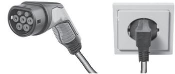
Pour charger sur une prise électrique domestique, brancher le câble de chargement au port de chargement du véhicule et à la prise électrique domestique.
