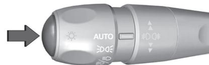
La caméra de vision arrière est activée lorsque le véhicule roule et que la vue arrière est sélectionnée à partir de l'affichage de la vue arrière ou en appuyant sur le bouton du levier. Lorsqu'une remorque est attelée, la vue arrière rapprochée n'est plus sélectionnable.
