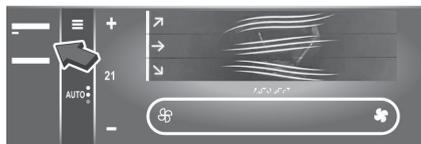
Appuyer sur **MENU** sur le panneau de commande de climatisation ou toucher
