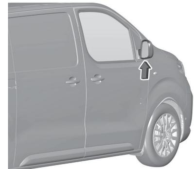
La caméra est montée au bas du rétroviseur extérieur côté passager. La zone affichée par la caméra est limitée. La distance de l'image qui s'affiche sur l'écran est différente de la distance réelle.
