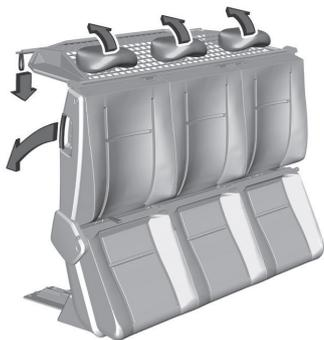
1. Pour rétablir la position d'origine de la banquette, tirer sur la boucle pour la débloquer.
