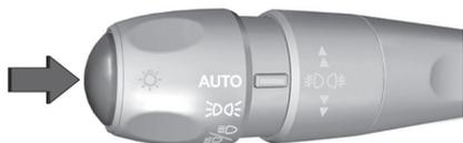
La caméra est mise en marche lorsque le véhicule roule et que la vue côté passager est sélectionnée depuis l'écran de vue arrière ou en appuyant sur le bouton du levier.
