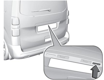
Avec la clé électronique à l'extérieur du véhicule et à une distance d'environ 1 m du hayon, appuyer sur le bouton du côté droit du hayon pour verrouiller le véhicule.
