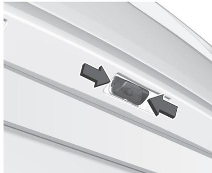
Insérer un tournevis fin, par exemple, dans l'un des renforcements du couvercle et le pousser vers l'extérieur pour le détacher.
