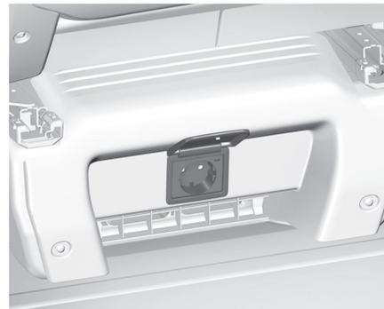
Une prise de courant 220V peut se trouver sous le siège passager avant. La puissance maximale absorbée ne doit pas dépasser 120 W.
