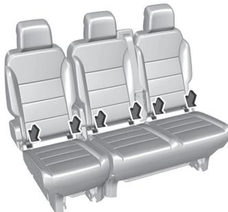
Une sangle de fixation supérieure ou une jambe d'appui doit être utilisée en plus des supports ISOFIX.
