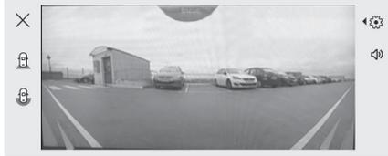
La vue à 180° facilite le recul hors d'un emplacement de stationnement, rendant possible d'observer l'approche des véhicules, des piétons et des cyclistes.
