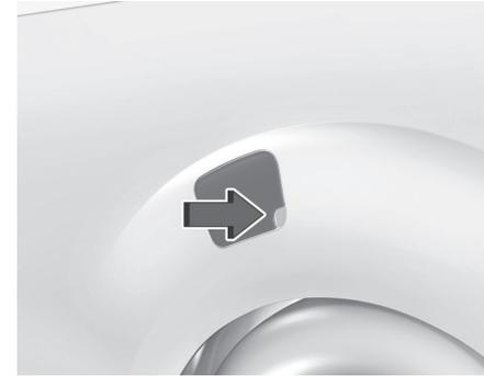
Si le véhicule est équipé d'un système de clé électronique, la trappe à carburant peut uniquement être ouverte si le véhicule est déverrouillé. Selon version, relâcher la trappe à carburant en appuyant sur le volet ou en tirant dans le coin inférieur droit.
