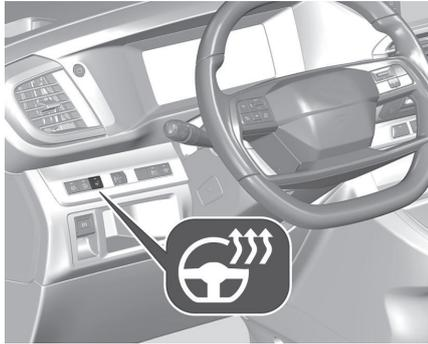
Activer le chauffage en appuyant sur
