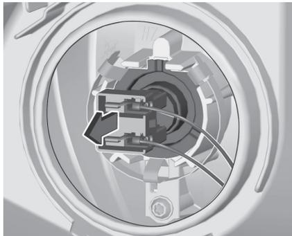
2. Appuyer sur le loquet et retirer la douille de l'ampoule du logement de réflecteur.
