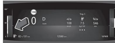
Indique le niveau d'hydrogène dans le réservoir.
