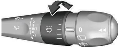
Avec le levier d'essuie-glace en position **INT**, il est possible de sélectionner cinq niveaux de fréquence en tournant la bague.
