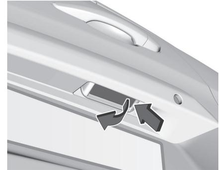
Insérer un tournevis dans l'un des renforcements du couvercle et le soulever en faisant levier.
