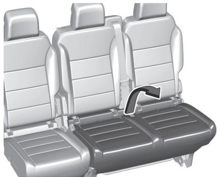
Il peut exister une boîte de rangement sous la banquette centrale et la banquette de gauche. Soulever l'assise du siège.
