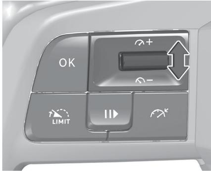
Si le système est actif, la vitesse présélectionnée peut être modifiée en déplaçant la molette sur  $\curvearrowright$  pour augmenter la vitesse ou sur  $\curvearrowleft$  pour la réduire. Déplacer la molette à plusieurs reprises pour modifier la vitesse par petits incréments ; déplacer et maintenir pour modifier la vitesse par grands incréments.
