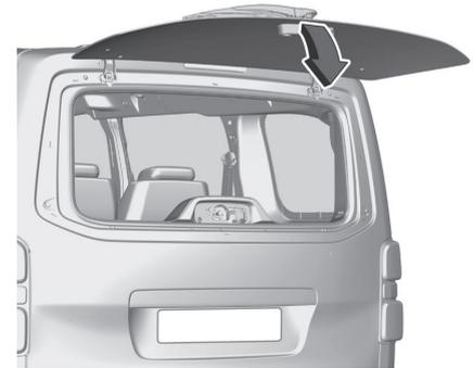
Appuyer au centre de la vitre jusqu'à la fermeture complète.
