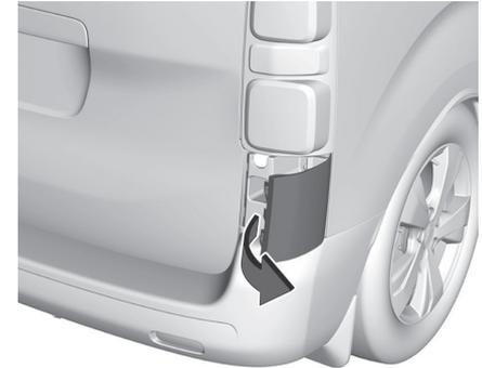
1. Véhicules avec un couvercle cachant la vis inférieure de l'ensemble de feu arrière : retirer le couvercle en dégageant délicatement ses pattes de fixation avec un tournevis et en inclinant légèrement le couvercle vers l'extérieur.
