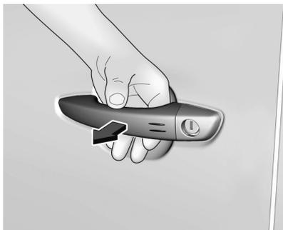
Passer la main derrière la poignée de porte de l'une des portes avant, des portes coulissantes, des portes à charnière ou appuyer sur le bouton du hayon.
