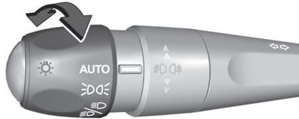
Quand la molette de réglage est en position **AUTO**, le système bascule automatiquement entre les feux de jour et les phares, en fonction des conditions d'éclairage extérieur et des informations communiquées par le système d'essuie-glaces.
