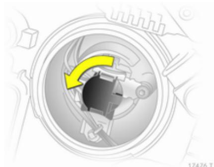
3. Faire tourner la douille de l'ampoule dans le sens antihoraire pour la désenclenquer. Retirer la douille de l'ampoule du réflecteur.
