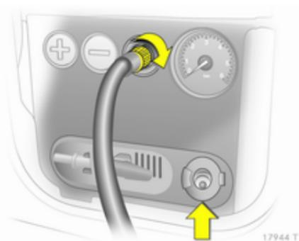
6. Visser le flexible d'air à l'orifice du compresseur.
