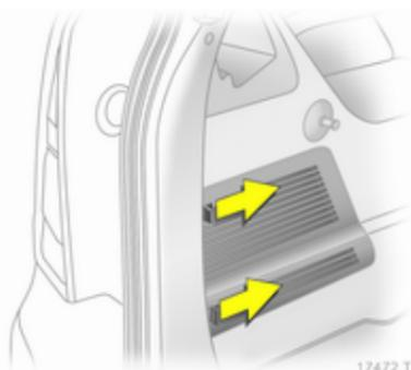
La boîte à fusibles se trouve derrière un cache. Pousser les languettes de blocage vers l'avant et retirer le cache.
