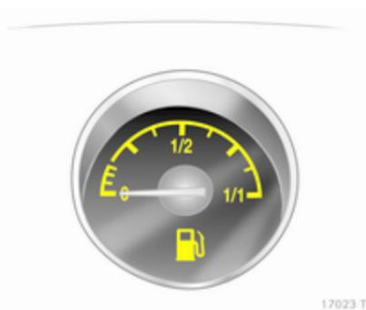
Affiche le niveau de remplissage de carburant ou la pression de gaz dans le réservoir en fonction du mode de fonctionnement.
