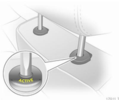
En cas de collision arrière, les appuis-tête actifs basculent un peu vers l'avant. La tête est mieux soutenue par l'appui-tête et le risque de blessures au niveau des vertèbres cervicales est réduit.
