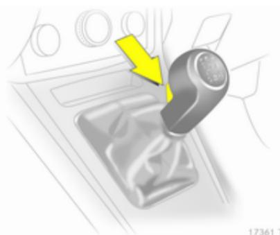
Marche arrière : lorsque le véhicule est à l'arrêt, appuyer sur le bouton de déverrouillage du levier sélecteur 3 secondes après avoir enfoncé la pédale d'embrayage et engager la marche arrière.
