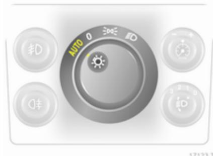
Mettre le commutateur d'éclairage sur **AUTO** : quand le moteur tourne, les feux s'allument si l'éclairage extérieur est faible.
