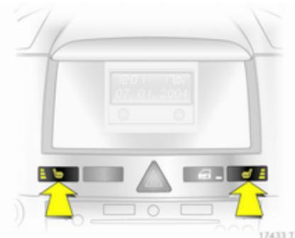
En fonction du niveau de chauffage voulu, appuyer une ou plusieurs fois sur le bouton
