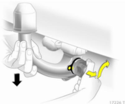
Ouvrir le volet de protection et tourner la clé en position (1) pour déverrouiller la barre d'attelage.
