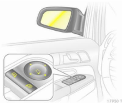
Commencer par sélectionner le rétroviseur extérieur souhaité, puis basculer la commande pour le régler.
