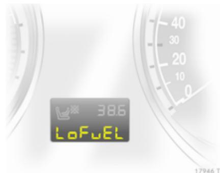
En mode gaz naturel, le message **LoFuEL** apparaît lorsque le niveau dans le réservoir d'essence est bas. Ce message peut être confirmé en appuyant sur le bouton de remise à zéro ⇨ 85.
