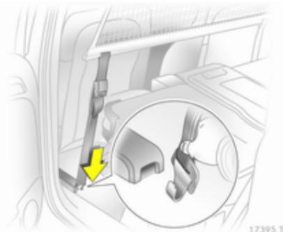
Accrocher les crochets des sangles de serrage du filet dans les fentes et tendre les sangles.
