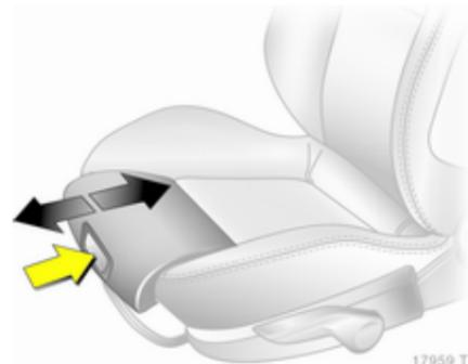
Appuyer sur le bouton et déplacer l'appui-cuisses.
