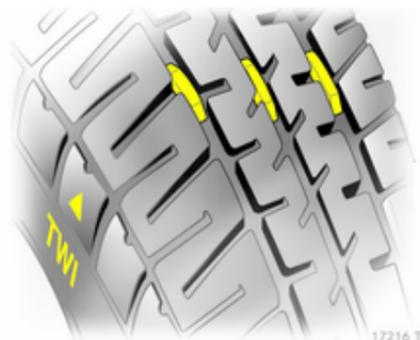
La profondeur minimale de sculpture légalement autorisée (1,6 mm) est atteinte lorsque le profil est usé jusqu'au repère d'usure (TWI = Tread Wear Indicator). La position des repères d'usure est indiquée par des marques sur les flancs du pneu.
