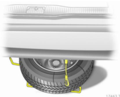
9. Soulever le support de la roue de secours et accrocher le câble de sécurité.
