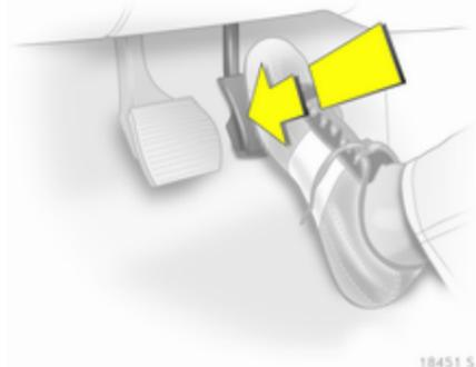
En enfouissant la pédale d'accélérateur au-delà du point de résistance, un rapport inférieur est sélectionné en fonction du régime moteur.
