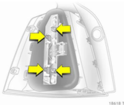
4. Désencliqueter les languettes de verrouillage et enlever la douille de l'ampoule.
