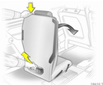
À partir du coffre, appuyer sur le bouton en haut du dossier de siège et abaisser le dossier. Tirer le siège en haut vers l'arrière à l'aide de la poignée et ensuite, le basculer vers l'avant jusqu'à ce qu'il soit encastré dans le plancher du véhicule. Tenir le siège par la poignée pendant toute la phase de basculement.
