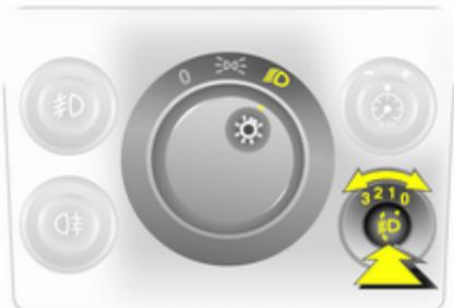
Adapter la portée des phares à la charge du véhicule pour éviter l'éblouissement : sortir le bouton en appuyant dessus et le tourner dans la position souhaitée.
