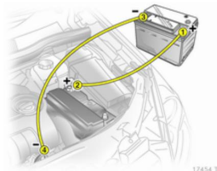
Séquence de raccordement des câbles :
