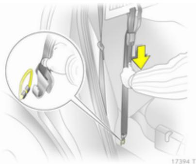
Accrocher les crochets des sangles de serrage du filet dans les anneaux d'arrimage du plancher et tendre les sangles.
