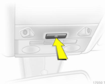
Couper la surveillance de l'habitacle et de l'inclinaison du véhicule quand on laisse des animaux à l'intérieur, parce que des signaux à ultrasons à volume élevé ou des mouvements déclencheraient l'alarme. Les couper également quand le véhicule se trouve dans un ferry ou sur un train.
