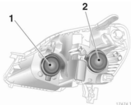
Phares avec systèmes séparés pour les feux de route 1 (ampoules intérieures) et les feux de croisement 2 (ampoules extérieures).
