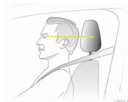
Le milieu de l'appui-tête doit se trouver à hauteur des yeux. Si cela s'avérait impossible pour des personnes de très grande taille, l'appui-tête doit être réglé sur la position la plus haute.
