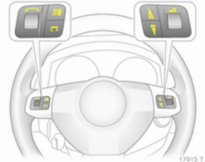
Les fonctions de l'Infotainment System et de l'Info-Display peuvent être commandées à partir du volant.
