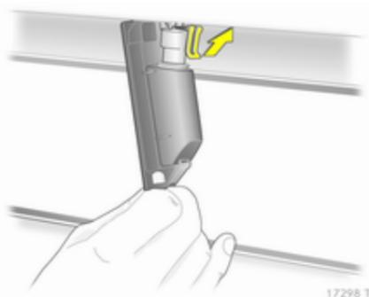
2. Sortir le boîtier de l'ampoule par le bas en veillant à ne pas tirer sur le câble.
