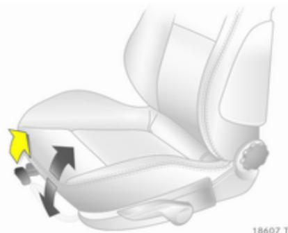
Tirer le levier, régler l'inclinaison en modifiant la pression du corps. Relâcher le levier et encliqueter le siège en place de manière audible.
