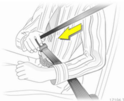
Tirer la ceinture hors de l'enrouleur, la guider sur le corps sans la vriller et insérer le verrou plat dans la serrure de ceinture. En roulant, tendre régulièrement la sangle abdominale en tirant sur la sangle thoracique.
