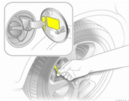
Ôter la clé de capuchon de valve de la trappe à carburant et l'utiliser pour dévisser le capuchon de valve.
