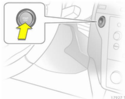
La clé électronique doit se trouver à l'intérieur du véhicule. Actionner l'embrayage et le frein, la boîte automatique se trouvant en position **P** (parking) ou **N** (neutre).
