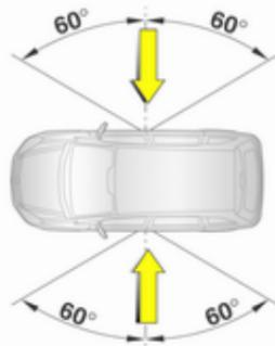
Le système d'airbags latéraux avant se déclenche en cas d'accident dans la zone d'action indiquée à partir d'une certaine gravité. Le contact doit être mis.
