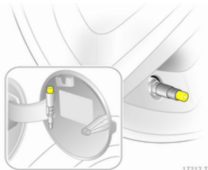
Sur les véhicules avec système de surveillance de la pression des pneus, visser l'adaptateur sur la valve.
