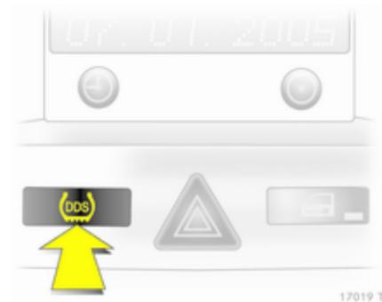
Après une correction de la pression de gonflage ou un changement de roue, il faut initialiser le système : mettre le contact, enfoncer et maintenir le bouton **DDS** pendant 4 secondes environ, le témoin (D) clignote trois fois.
