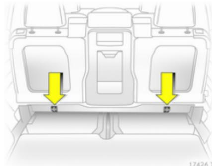
Fixer le système de sécurité pour enfants Top-Tether aux œillets de fixation de la deuxième rangée de sièges. La sangle doit alors passer entre les deux tiges de guidage de l'appuie-tête.
