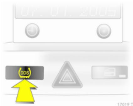
Après un changement de roue, le système doit être initialisé : gonfler les pneus à la pression prescrite, mettre le contact, appuyer sur le bouton **DDS** et le maintenir enfoncé pendant 4 secondes environ, le témoin (D) clignote trois fois.
