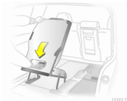
Basculer le siège vers l'arrière jusqu'à ce qu'il soit redressé et encliqueté de manière audible. Soutenir le haut du dossier d'une main.
