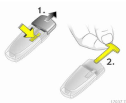
Si la télécommande radio est également défectueuse, la porte du conducteur peut être verrouillée ou déverrouillée à l'aide de la clé de secours contenue dans la clé électronique : appuyer sur le mécanisme de verrouillage et enlever le capuchon en appliquant une légère pression. Pousser la clé de secours vers l'extérieur en dépassant le cran d'arrêt et la sortir.
