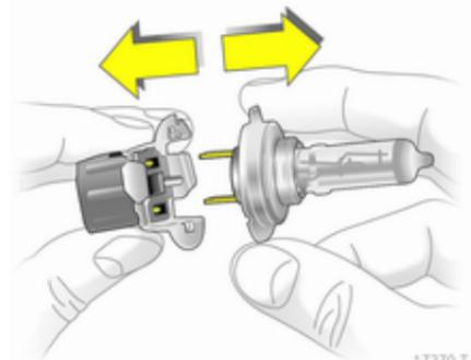
4. Détacher l'ampoule de sa douille et remplacer l'ampoule.
