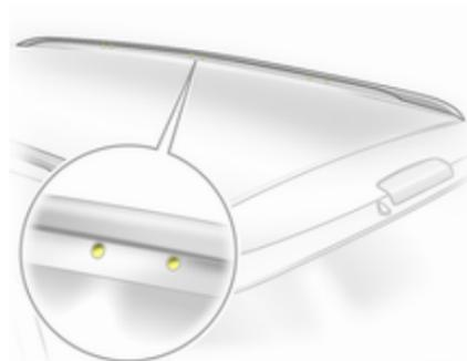
Pour fixer la galerie de toit, insérer les boulons de montage dans les orifices indiqués sur l'illustration.
