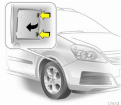
Le remplacement des ampoules des feux avant est réalisé via des ouvertures dans le passage de roue avant :
