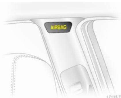
Le système d'airbags rideaux se compose d'un airbag de cadre de toit, de chaque côté du véhicule. Ceci est reconnaissable aux inscriptions **AIRBAG** sur les montants de toit.
