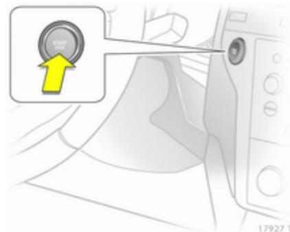
Appuyer sur le bouton **Start/Stop**. Le contact est mis. Le blocage du démarrage et le blocage de la direction sont désactivés.
