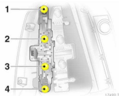
5. Pousser légèrement l'ampoule dans la douille, la tourner dans le sens antihoraire, l'enlever et remplacer l'ampoule.
