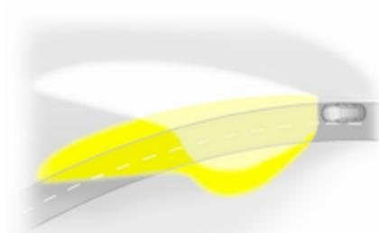
Le faisceau lumineux pivote en fonction de la position du volant et de la vitesse.
