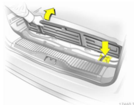
Le cric et l'outillage du véhicule se trouvent dans un sac dans le compartiment de rangement situé dans le plancher du coffre où il est attaché par une sangle en caoutchouc.
