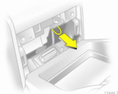
4. Tirer sur la boucle et sortir le levier sélecteur de la position **P** ou **N**. En repassant de nouveau en position **P** ou de **N**, le levier sélecteur se verrouille. Faire corriger la cause de la coupure de courant par un atelier.
