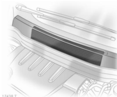
Les entrées d'air dans le compartiment moteur, à l'extérieur devant le pare-brise, ne doivent pas être encombrées. Le cas échéant, enlever les feuilles, les saletés ou la neige.
