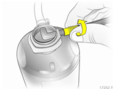
2. Dérouler le flexible d'air du support et le visser sur l'orifice de la bouteille de produit d'étanchéité.
