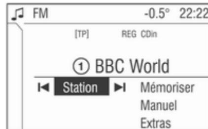
Appuyer brièvement sur la touche à bascule cruciforme ◀ ou ▶ pour écouter la station suivante dans la mémoire des émetteurs.
