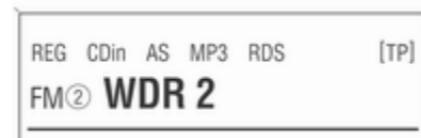
Quand la station actuellement réglée n'est pas une station RDS, la radio recherche automatiquement la station RDS recevable la plus proche pouvant être captée.
