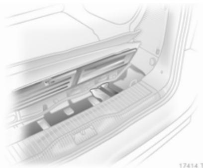
Pour ouvrir le couvercle, lever le tapis de sol. Relever l'anneau, le tourner et le soulever. Le compartiment de rangement abrite l'outillage ↻ 182 du véhicule et la barre d'attelage.
