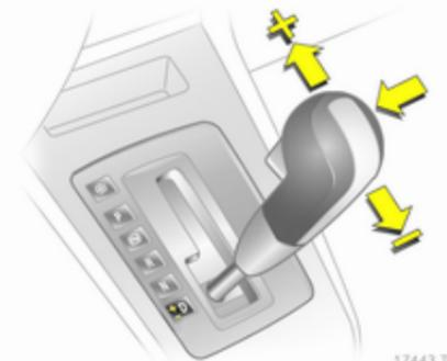
Déplacer le levier sélectionneur de la position **D** vers la gauche puis vers l'avant ou l'arrière.
