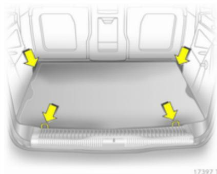
Les anneaux d'arrimage servent à sécuriser les objets pour éviter qu'ils ne glissent, par exemple avec des sangles de serrage, le filet à bagages ou le filet de sécurité.
