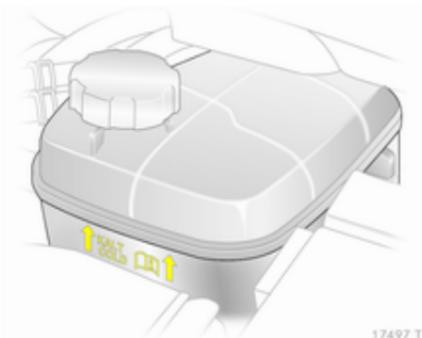
Si le système de refroidissement est froid, le niveau de liquide de refroidissement doit se trouver juste au-dessus du repère **KALT/COLD**. Faire l'appoint si le niveau est bas.
