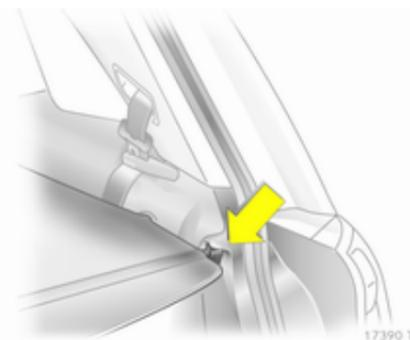
Retirer le cache-bagages des guides latéraux. Il s'enroule automatiquement.
