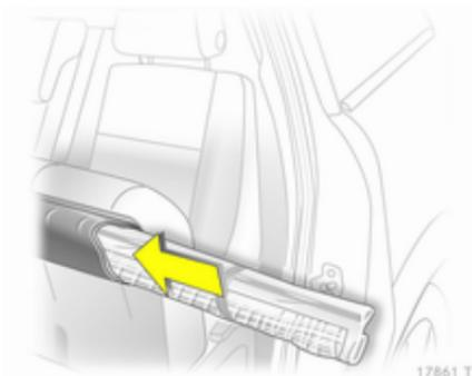
Relever l'assise de la seconde rangée de sièges ↗ 51. Glisser le filet de sécurité dans les retenues, abaisser l'assise et l'encliquer.
