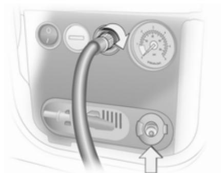
6. Visser le flexible d'air à l'orifice du compresseur.
