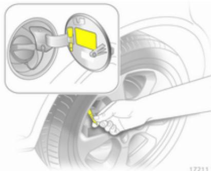
Ôter la clé de capuchon de valve de la trappe à carburant et l'utiliser pour dévisser le capuchon de valve.
