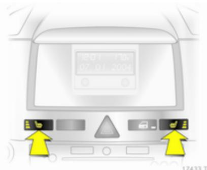
En fonction du niveau de chauffage voulu, appuyer une ou plusieurs fois sur le bouton
