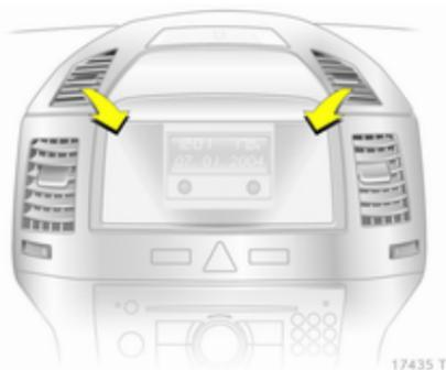
Régler la direction du flux d'air en faisant basculer et pivoter les lamelles. Pour fermer la bouche d'aération, diriger les lamelles vers le bas.
