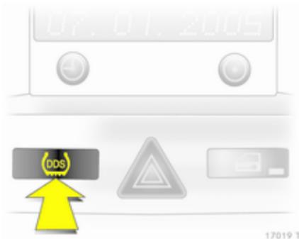
Après un changement de roue, le système doit être initialisé : gonfler les pneus à la pression prescrite, mettre le contact, puis appuyer sur le bouton **DDS** et le maintenir enfoncé pendant 4 secondes environ ; le témoin (D) clignote trois fois.
