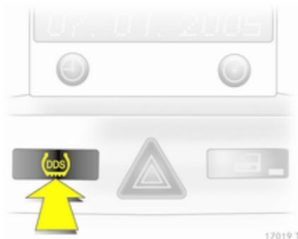
Après une correction de la pression de gonflage ou un changement de roue, il faut initialiser le système : mettre le contact, enfoncer et maintenir le bouton **DDS** pendant 4 secondes environ, le témoin (D) clignote trois fois.
