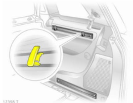
Mettre les crochets dans la position souhaitée dans les rails : pour ce faire, mettre le crochet dans la rainure supérieure du rail et l'enfoncer dans la rainure inférieure.
