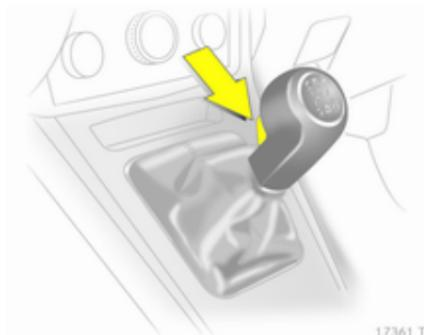
Marche arrière : lorsque le véhicule est à l'arrêt, appuyer sur le bouton de déverrouillage du levier sélecteur 3 secondes après avoir enfoncé la pédale d'embrayage et engager la marche arrière.
