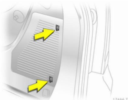
Pour le remplacement des ampoules sur le côté droit, ouvrir le couvercle latéral : pousser les languettes de verrouillage vers l'avant et retirer le couvercle.
