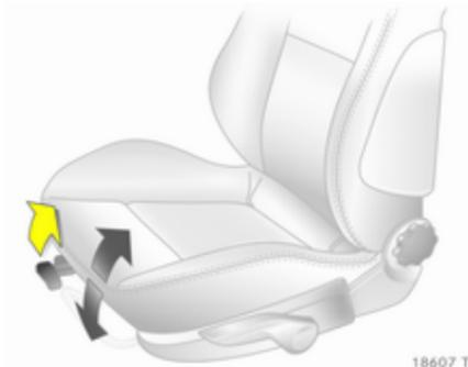
Tirer le levier, régler l'inclinaison en modifiant la pression du corps. Relâcher le levier et encliqueter le siège en place de manière audible.
