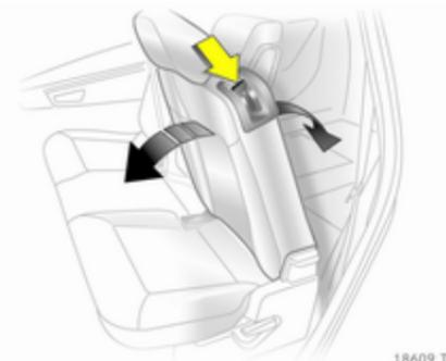
Pousser le levier de déverrouillage vers le bas, régler l'inclinaison, relâcher la poignée et encliquer le dossier.
