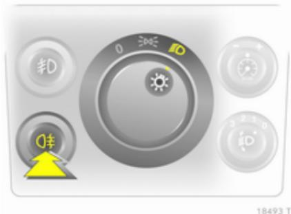
Le feu antibrouillard arrière s'allume uniquement avec le contact d'allumage mis et si les feux de position (avec les phares antibrouillard) ou les phares sont allumés.
