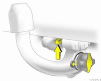
Verrouiller la barre d'attelage en tournant la clé en position (2). Enlever la clé et fermer le volet de protection.
