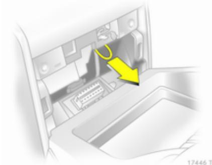
4. Tirer sur la boucle et sortir le levier sélecteur de la position **P** ou **N**. En repassant de nouveau en position **P** ou de **N**, le levier sélecteur se verrouille. Faire corriger la cause de la coupure de courant par un atelier.
