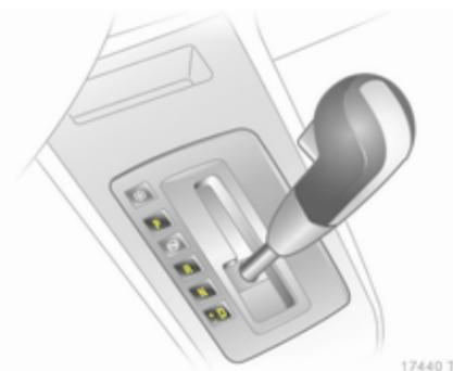
Le levier sélecteur peut uniquement quitter la position **P** ou **N** que si le contact est mis et si la pédale de frein est enfoncée (verrouillage du levier sélecteur).
