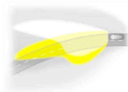
Le faisceau lumineux pivote en fonction de la position du volant et de la vitesse.
