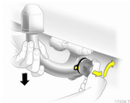
Ouvrir le volet de protection et tourner la clé en position
