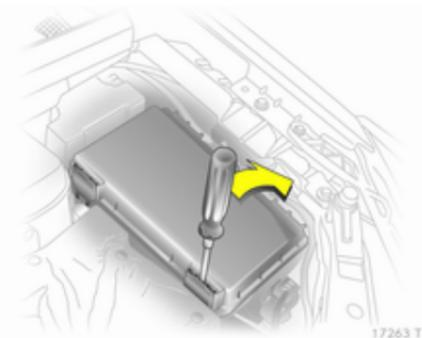
Insérer le tournevis à fond dans l'ouverture et le basculer sur le côté. Soulever le couvercle et l'enlever.
