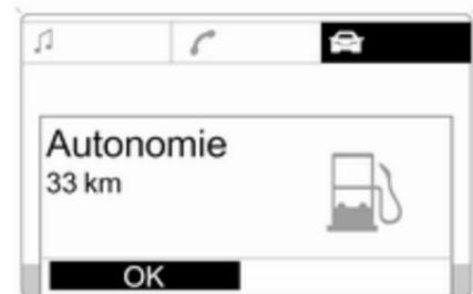
Si le niveau de carburant dans le réservoir est bas, le message **Autonomie** apparaît sur l'affichage.
