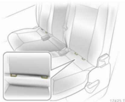
Fixer les systèmes de sécurité pour enfant ISOFIX homologués pour le véhicule aux étriers de fixation. Les positions des systèmes de sécurité pour enfant ISOFIX spécifiques au véhicule sont indiquées par IL dans le tableau.
