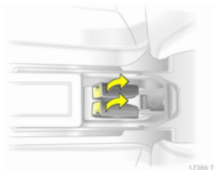
Ouvrir le couvercle du plancher entre les sièges et sortir les serrures des ceintures.
