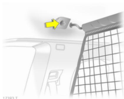
Deux orifices de montage se trouvent dans le cadre du toit : accrocher d'un côté puis enclencher la barre du filet afin de l'accrocher, presser la barre, l'accrocher d'un côté et l'encliqueter.
