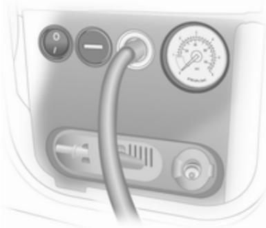
9. Mettre en route le compresseur en appuyant sur le commutateur marche/arrêt. Le pneu se gonfle en aspirant le produit d'étanchéité.
