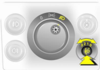
Adapter la portée des phares à la charge du véhicule pour éviter l'éblouissement : sortir le bouton en appuyant dessus et le tourner dans la position souhaitée.
