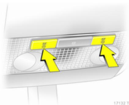
Actionnement avec les boutons
