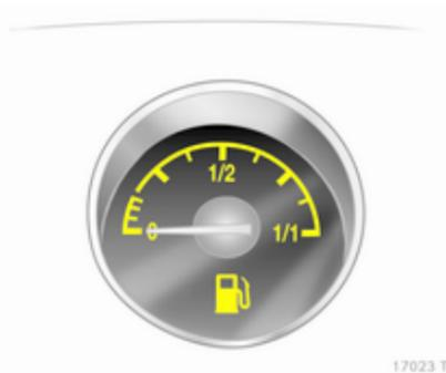
Affiche le niveau de remplissage de carburant ou la pression de gaz dans le réservoir en fonction du mode de fonctionnement.
