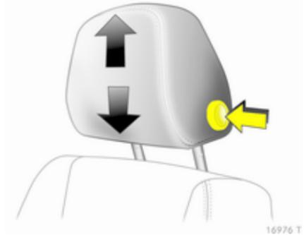
Appuyer sur le bouton, régler la hauteur et encliqueter
