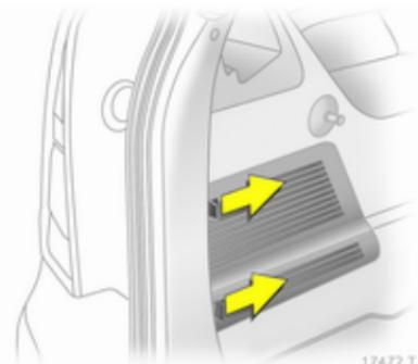
La boîte à fusibles se trouve derrière un cache. Pousser les languettes de blocage vers l'avant et retirer le cache.
