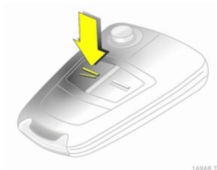
Appuyer sur le bouton
