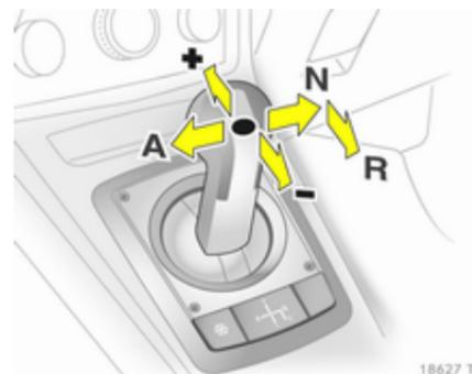
Toujours déplacer le levier sélecteur aussi loin que possible dans la direction adéquate. Quand il est relâché, il revient automatiquement en position centrale.
