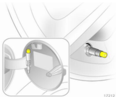
Sur les véhicules avec système de surveillance de la pression des pneus, visser l'adaptateur sur la valve.
