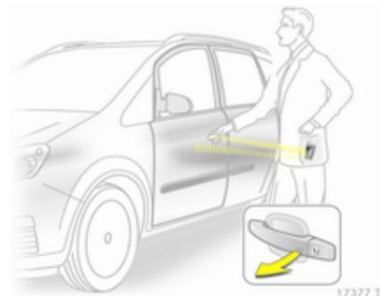
Avec la clé électronique avec soi, il suffit de tirer sur la poignée de la porte pour déverrouiller le véhicule et ouvrir la porte. Pour ouvrir le hayon, appuyer sur le bouton situé sous la moulure.
