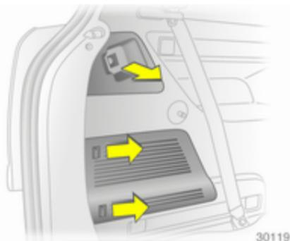
Pour le remplacement des ampoules sur le côté gauche, retirer l'attache du cache-bagages et ouvrir le couvercle latéral : pousser les languettes de verrouillage vers l'avant et retirer le couvercle.
