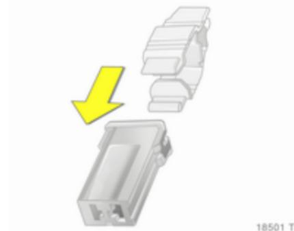
Placer la pince à fusibles par le haut ou le côté sur les différents types de fusibles et retirer le fusible.
