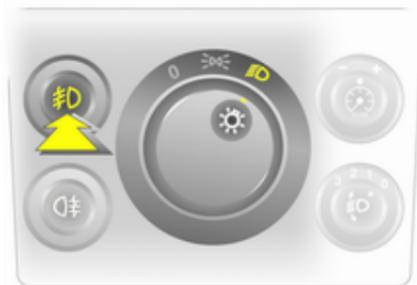
Les phares antibrouillard s'allument uniquement avec le contact mis et les feux de position ou les phares allumés.
