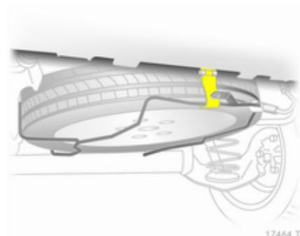
11. Serrer la vis hexagonale du compartiment de rangement dans le sens horaire à l'aide de la clé de roue.
