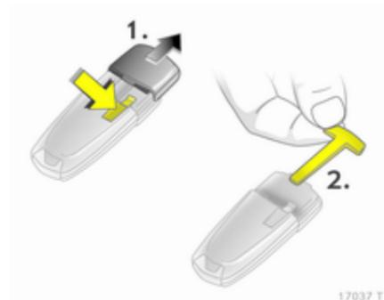
Si la télécommande radio est également défectueuse, la porte du conducteur peut être verrouillée ou déverrouillée à l'aide de la clé de secours contenue dans la clé électronique : appuyer sur le mécanisme de verrouillage et enlever le capuchon en appliquant une légère pression. Pousser la clé de secours vers l'extérieur en dépassant le cran d'arrêt et la sortir.
