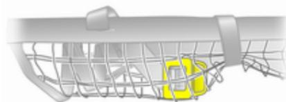
Attacher la bande Velcro en la serrant autour du filet au niveau des dispositifs de réglage de longueur. Les dispositifs de réglage de longueur et les barres du filet doivent être posés à plat l'un à côté de l'autre.
