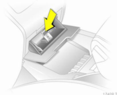
Pour vider le cendrier, appuyer sur le ressort, ouvrir complètement le cendrier et le retirer.
