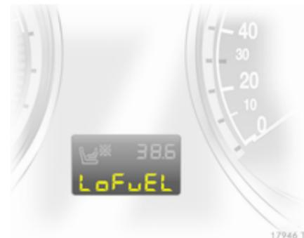
En mode gaz naturel, le message **LoFuEL** apparaît lorsque le niveau dans le réservoir d'essence est bas. Ce message peut être confirmé en appuyant sur le bouton de remise à zéro ⇨ 86.
