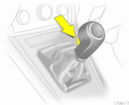
Pour engager la marche arrière lorsque le véhicule est à l'arrêt, appuyer sur le bouton de déverrouillage du levier sélecteur 3 secondes après avoir débrayé et engager ce rapport.
