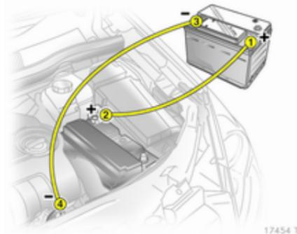
Séquence de raccordement des câbles :
