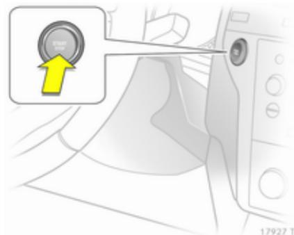
La clé électronique doit se trouver à l'intérieur du véhicule. Actionner l'embrayage et le frein, la boîte automatique se trouvant en position **P** (parking) ou **N** (neutre).
