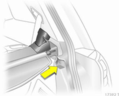
Mettre le cache-bagages à gauche dans le logement, tirer le levier de déverrouillage vers le haut et le tenir ; mettre le cache-bagages à droite et l'encliquer.
