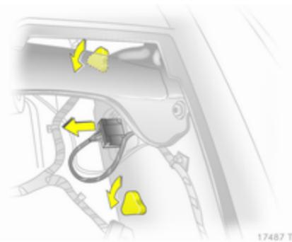
1. Comprimer la fiche et la retirer de la douille d'ampoule.
