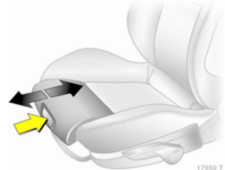
Appuyer sur le bouton et déplacer l'appui-cuisses.
