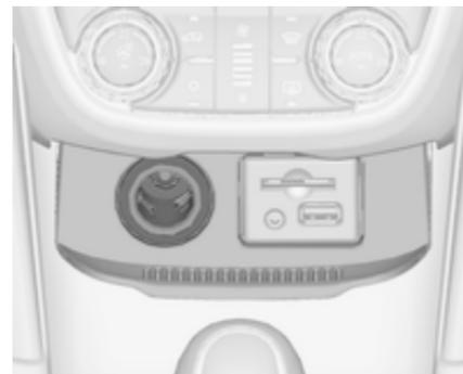
Une prise de courant 12 Volt est placée dans la console avant. Rabattre le couvercle vers le bas.
