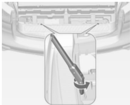
3. Poser la clé à roue sur un boulon hexagonal et la tourner dans le sens anti-horaire jusqu'à ce qu'une certaine résistance soit ressentie.
