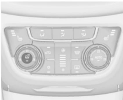
Activer le chauffage en appuyant sur le bouton
