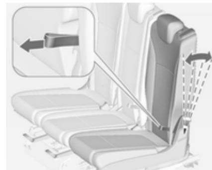
Remonter le dossier en position verticale. Régler l'inclinaison en tirant sur la sangle.
