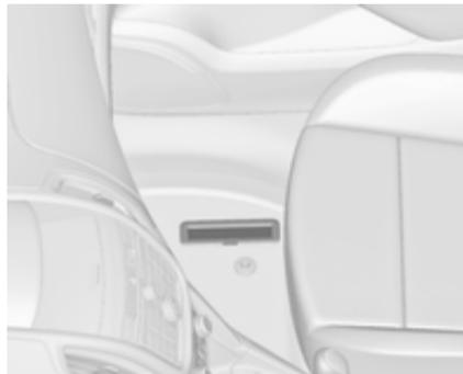
Le numéro d'identification du véhicule peut être frappé sur la plaquette d'identification et sur le plancher, sous le tapis de sol, abrité par un cache.
