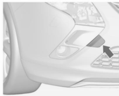
Insérer un tournevis dans la fente sur le bord bas courbe du capuchon. Déloger le capuchon en enfonçant avec précaution le tournevis vers le côté. Pour éviter tout dégât, il est recommandé de placer un chiffon entre le tournevis et le cadre.
