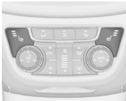
En fonction du niveau de chauffage voulu, appuyer une ou plusieurs fois sur le bouton
