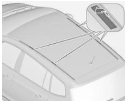
Pour fixer une galerie de toit, ouvrir les barrettes sur les bandes de toit. Insérer les dispositifs de fixation dans le dispositif de retenue comme cela est indiqué sur l'illustration.
