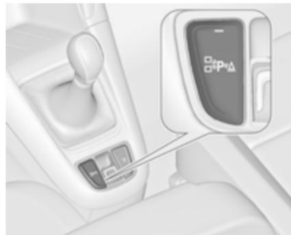
Lors de la recherche d'un emplacement de parking, il convient d'activer le système en appuyant sur le bouton
