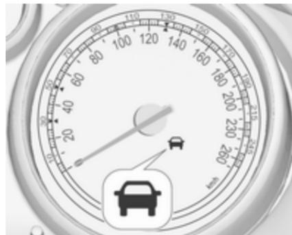
Le témoin de « véhicule à l'avant » allumé en vert
