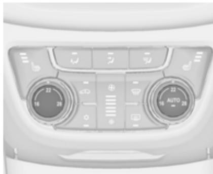
Si la température minimale **Lo** est réglée, le système de commande de climatisation fonctionne avec sa capacité maximale de refroidissement, si le refroidissement
