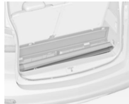
Mettre le filet de sécurité dans le rangement et fermer le couvercle.
