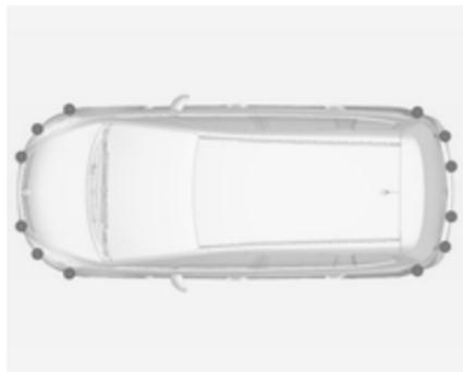
Le système avancé d'assistance au stationnement guide le conducteur dans un emplacement de parking en lui donnant des instructions sur le centre d'informations du conducteur et en émettant des signaux acoustiques. Le conducteur doit contrôler l'accélération, le freinage, la direction et les changements de vitesses.
