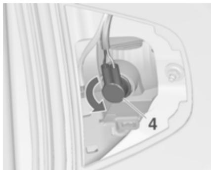
2. Tourner la douille d'ampoule dans le sens anti-horaire et l'enlever du réflecteur.
