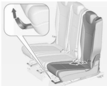
Lors de l'utilisation de systèmes de sécurité pour enfant ISOFIX sur la deuxième rangée de sièges, il est conseillé de régler le siège latéral correspondant à la troisième encoche à partir de la position arrière, pour les sièges de base. Le siège lounge, si le véhicule en est doté, doit être en position normale ↗ 46.
