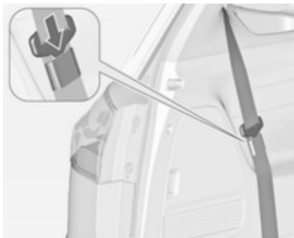
Avant d'ouvrir le cache-bagages, insérer le verrou plat de la ceinture de sécurité de chaque côté dans la poche intégrée à la ceinture.
