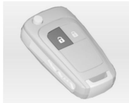
Appuyer sur le bouton
