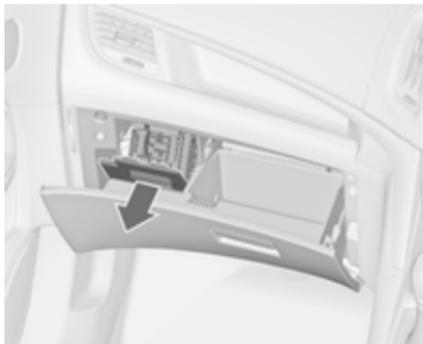
Dans les véhicules avec direction à droite, la boîte à fusibles se trouve derrière un cache dans la boîte à gants. Ouvrir la boîte à gants, puis ouvrir le couvercle et le rabattre.
