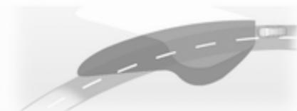
Le faisceau lumineux pivote en fonction de l'angle de braquage du volant et la vitesse, ce qui améliore l'éclairage des virages.
