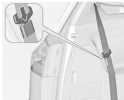
Lorsque les ceintures de sécurité ne sont pas utilisées ou lorsque les sièges sont rabattus, insérer le verrou plat de la ceinture de sécurité de chaque côté de la pochette intégrée à la ceinture.
