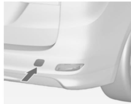
Insérer un tournevis dans la fente sur le bord bas courbe du capuchon. Dégager le capuchon en enfonçant avec précaution le tournevis vers le bas. Pour éviter tout dégât, il est recommandé de placer un chiffon entre le tournevis et le cadre.
