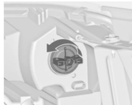
1. Faire tourner la douille de l'ampoule (3) dans le sens antihoraire pour la désencliqueter. Retirer la douille de l'ampoule du réflecteur.
