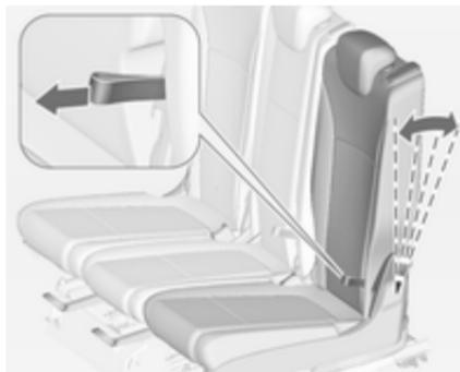
Tirer sur la sangle, régler l'inclinaison, relâcher la sangle et laisser le dossier s'encliquer.
