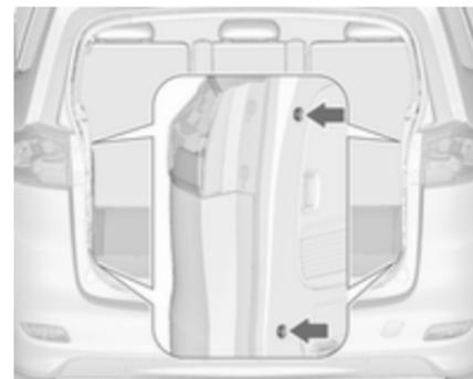
Poser directement à l'avant du hayon. Avant la pose, pousser les quatre pièces d'extrémité dans la tige de filet en faisant tourner chaque pièce dans le sens anti-horaire.
