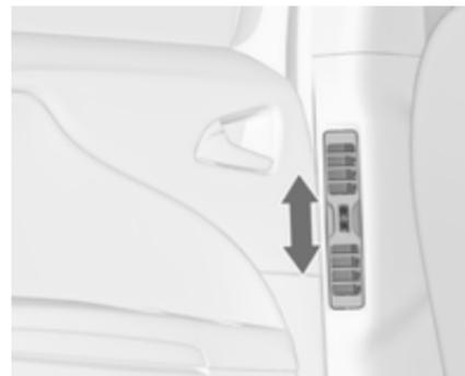
Les bouches d'aération pour les passagers arrière sont situées à gauche et à droite derrière les sièges avant.
