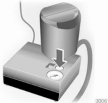
Si la pression de pneu prescrite n'est pas atteinte dans les 10 minutes, démonter le kit de réparation de pneus. Avancer ou reculer le véhicule d'un tour de roue. Brancher à nouveau le kit de réparation de pneus et poursuivre la procédure de remplissage pendant 10 min. Si la pression de gonflage prescrite n'est toujours pas atteinte, c'est que le pneu est trop fortement endommagé. Prendre contact avec un atelier
