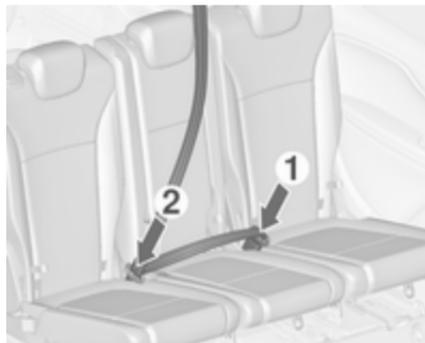
Retirer le verrou plat inférieur du dispositif de retenue et l'insérer dans la serrure gauche (1) du siège central. Guider le verrou plat supérieur avec la ceinture par-dessus la zone de genou et l'épaule (sans vriller) et l'insérer dans la serrure droite (2) du siège central.
