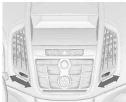
Pour ouvrir une bouche d'aération, tourner la molette sur I. Régler le débit d'air venant de la bouche d'aération en tournant la molette.
