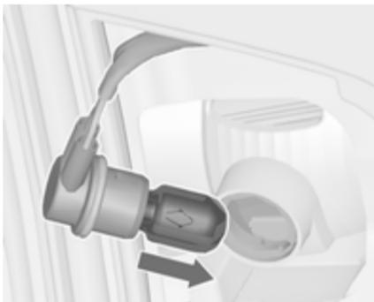
3. Retirer l'ampoule de la douille en tirant.
