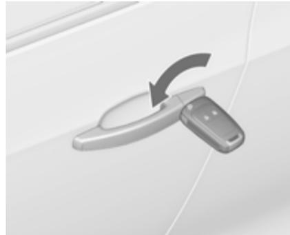
Déverrouiller manuellement la porte du conducteur en tournant la clé dans la serrure. Mettre le contact et appuyer sur le bouton de verrouillage central
