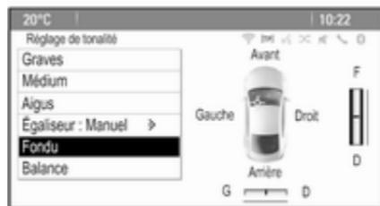
Pour régler la répartition du volume entre les haut-parleurs avant et arrière du véhicule, sélectionner **Fondu**. Effectuez le réglage désiré.
