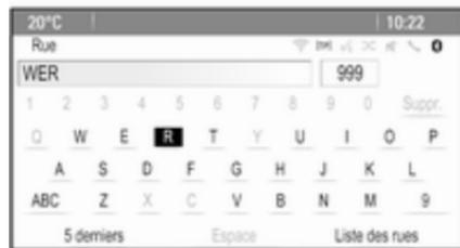
Pour modifier la disposition des lettres sur le clavier, sélectionner **ABC** sur le côté gauche du clavier. Les lettres sont maintenant disposées dans l'ordre alphabétique.
