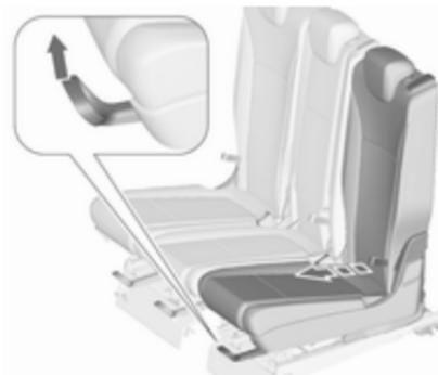
Lors de l'utilisation de systèmes de sécurité pour enfant ISOFIX sur la deuxième rangée de sièges, il est conseillé de régler le siège latéral correspondant à la troisième encoche à partir de la position arrière, pour les sièges de base. Le siège lounge, si le véhicule en est doté, doit être en position normale ⇨ 46.
