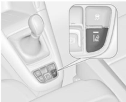
Le système d'avertissement de franchissement de ligne est activé en appuyant sur **L**. La LED allumée dans le bouton indique que le système est activé. Quand le témoin **L** du combiné d'instruments s'allume en vert, le système est prêt à fonctionner.
