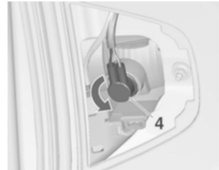
2. Tourner la douille d'ampoule dans le sens antihoraire et l'enlever du réflecteur.
