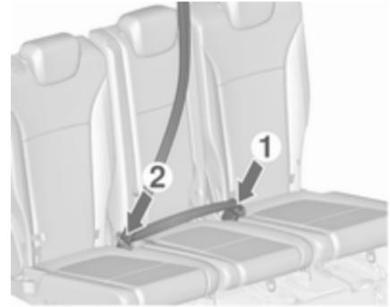
Retirer le verrou plat inférieur du dispositif de retenue et l'insérer dans la serrure gauche (1) du siège central. Guider le verrou plat supérieur avec la ceinture par-dessus la zone de genou et l'épaule (sans vriller) et l'insérer dans la serrure droite (2) du siège central.
