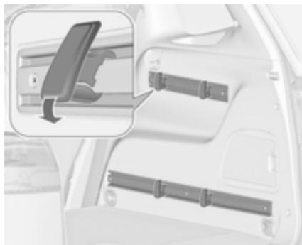
Mettre les crochets dans la position souhaitée dans les rails : pour ce faire, mettre le crochet dans la rainure supérieure du rail et l'enfoncer dans la rainure inférieure.
