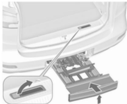
Pousser le levier de déverrouillage vers le haut et le tenir. Soulever légèrement le système de transport arrière et le pousser dans le pare-chocs jusqu'à ce qu'il s'enclique.
