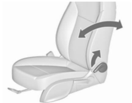
Tirer le levier, régler l'inclinaison et relâcher le levier. Laisser le siège s'encliqueter de manière audible.
