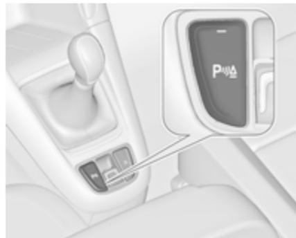
La désactivation manuelle est également possible. Pour cela, appuyer sur le bouton d'aide au stationnement **P**▲.
