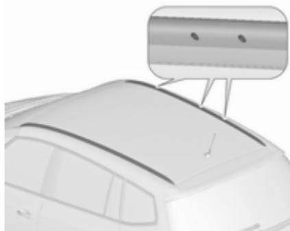
Fixer la galerie de toit dans la zone des orifices, comme cela est indiqué par les flèches sur l'illustration.
