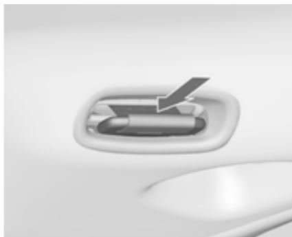
L'introduire dans la fixation de ceinture de sécurité dans le toit, avec le verrou plat inférieur tourné vers l'avant.
