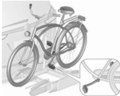
1. Faire tourner les pédales à la position illustrée et poser le vélo dans le logement de roue le plus en avant.
