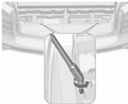
3. Poser la clé de roue sur un boulon hexagonal et la tourner dans le sens anti-horaire jusqu'à ce qu'une certaine résistance soit ressentie.
