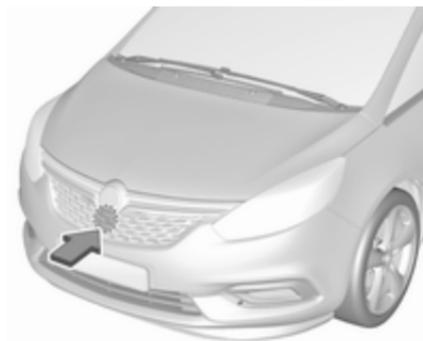
Le radar est monté derrière la calandre du radiateur sous l'emblème de la marque.
