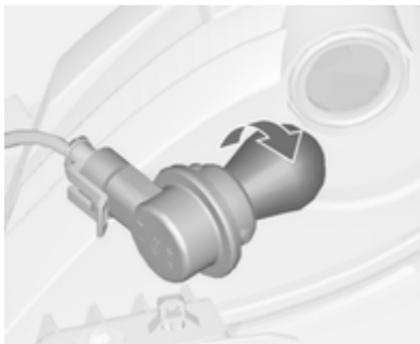
2. Retirer l'ampoule de la douille en tournant dans le sens anti-horaire.
