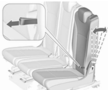
Tirer sur la boucle, régler l'inclinaison, relâcher la sangle et laisser le dossier s'encliqueter.
