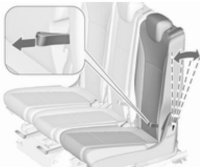
Remonter le dossier en position verticale. Régler l'inclinaison en tirant sur la boucle.
