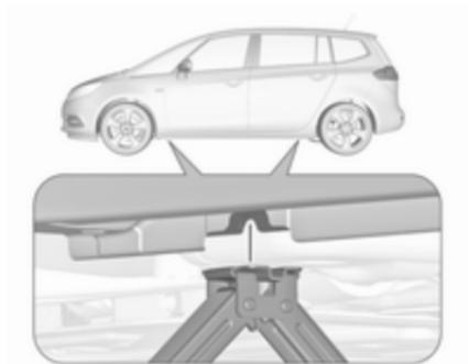
4. Vérifier que le cric est bien positionné sous le point de levage adéquat.
