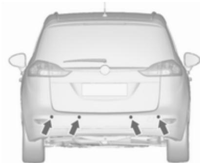
Quatre capteurs de stationnement à ultrasons sont présents dans chaque pare-chocs avant et arrière.
