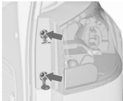
2. Retirer les vis repérées par les flèches.
