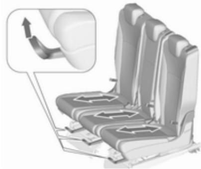
En position normale, les trois sièges de la deuxième rangée de sièges peuvent être indépendamment déplacés longitudinalement.
