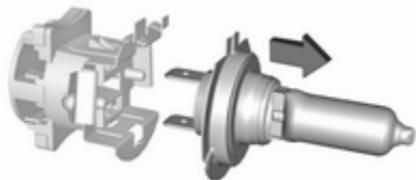
3. Retirer l'ampoule du connecteur enfichable en tirant.
