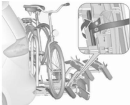
4. Passer la sangle attachée à l'adaptateur sous le levier pour faire revenir le système de transport arrière. Attacher la sangle.
