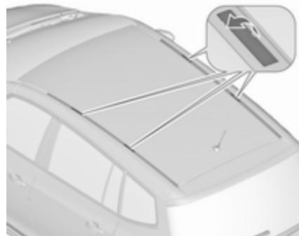
Pour fixer une galerie de toit, ouvrir les barrettes sur les bandes de toit. Insérer les dispositifs de fixation dans le dispositif de retenue comme cela est indiqué sur l'illustration.
