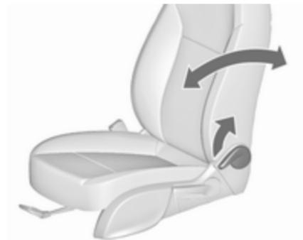
Tirer le levier, régler l'inclinaison et relâcher le levier. Laisser le dossier s'encliquer de manière audible.
