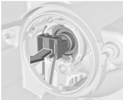
2. Retirer la douille de l'ampoule du boîtier du réflecteur.
