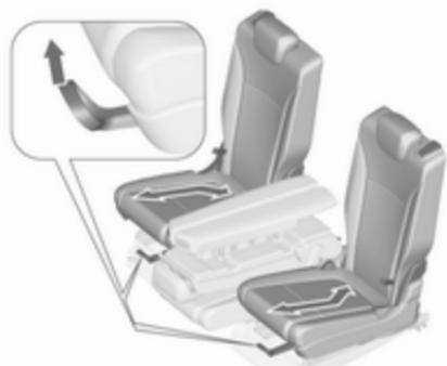
En position lounge, les sièges latéraux peuvent également être déplacés transversalement, lorsque le dossier du siège central est replié pour former un accoudoir.
