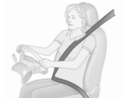
Les ceintures de sécurité sont bloquées lors d'accéléérations ou de décéléérations fortes du véhicule, ce qui assure le maintien des occupants en position assise. Le risque de blessure est ainsi sensiblement réduit.
