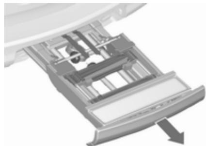
Sortir complètement le système de transport arrière jusqu'à ce qu'il se verrouille de manière audible.
