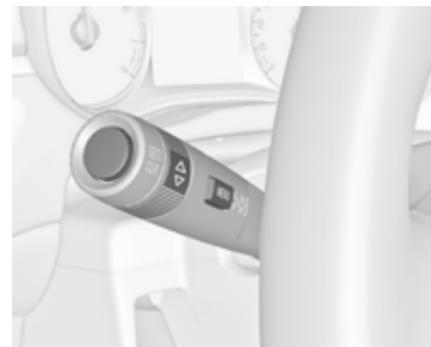
Sélectionner le menu d'informations du véhicule
