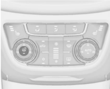
Activer le chauffage en appuyant sur
