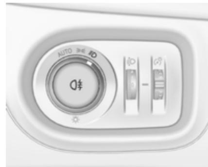
Pour les enclencher, appuyer sur Q#. Commutateur d'éclairage en position **AUTO** : l'enclenchement des feux antibrouillard arrière fera automatiquement s'allumer les phares.
