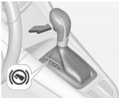
Le levier sélecteur est verrouillé en position **P** et ne peut être déplacé que lorsque le contact est mis, lorsque le
