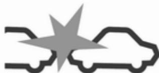
Lorsque la distance avec un véhicule en mouvement à l'avant est trop petite ou lorsque vous approchez trop rapidement d'un autre véhicule et qu'une collision est imminente, le symbole d'alerte de collision s'affiche dans le Centre d'informations du conducteur
