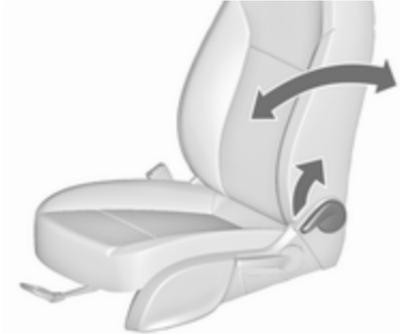
Tirer le levier, régler l'inclinaison et relâcher le levier. Laisser le dossier s'encliquer de manière audible.
