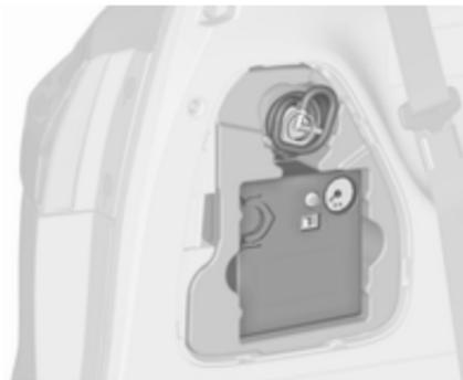
Si le véhicule est doté d'un kit de réparation des pneus, retirer la boîte complète.
