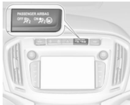
Si le témoin **ON**
