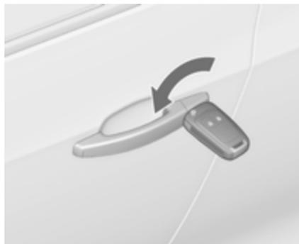
Déverrouiller manuellement la porte du conducteur en tournant la clé dans la serrure. Mettre le contact et appuyer sur
