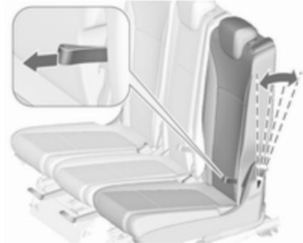
Tirer sur la boucle, régler l'inclinaison, relâcher la sangle et laisser le dossier s'encliquer.
