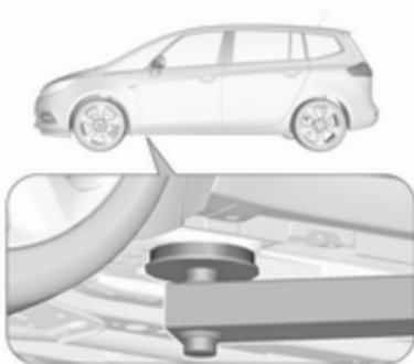
Position du bras avant du pont élévateur au niveau du soubassement.
