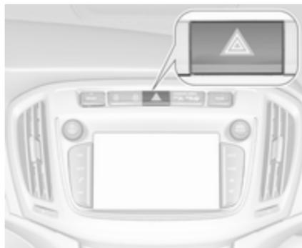
Pour les enclencher, appuyer sur
