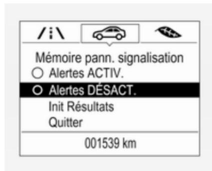
Sélectionner **Alertes ACTIV.** ou **Alertes DÉFACT.** en tournant la molette de réglage et appuyer sur **SET/CLR**.
