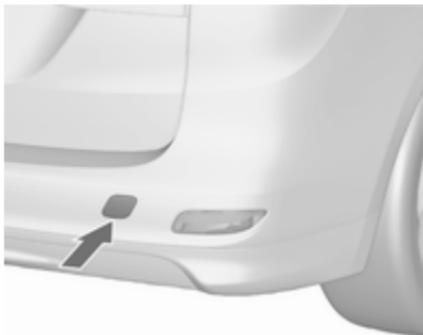
Envelopper d'un linge l'extrémité d'un tournevis plat pour ne pas endommager la peinture. Insérer un tournevis dans la fente sur le bord bas courbe du capuchon. Dégager le capuchon en enfonçant avec précaution le tournevis vers le bas. Pour éviter tout dégât, il est recommandé de placer un chiffon entre le tournevis et le cadre.
