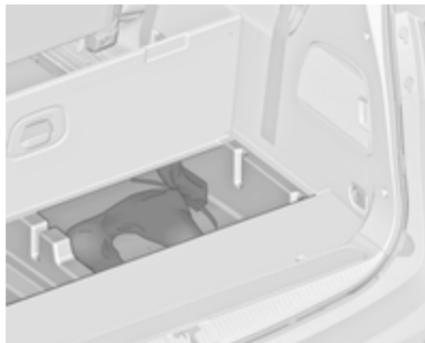
Sur la variante sans troisième rangée de sièges, des boîtes de rangement peuvent être trouvées sous le revêtement de plancher. Soulever le couvercle pour l'ouvrir.
