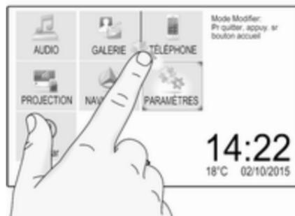
Toucher et maintenir l'élément à déplacer jusqu'à ce que des cases rouges apparaissent autour des icônes. Déplacer votre doigt jusqu'à l'emplacement souhaité et relâcher l'élément.
