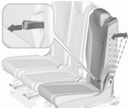
Tirer sur la boucle, régler l'inclinaison, relâcher la sangle et laisser le dossier s'encliqueter.
