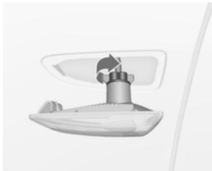
2. Faire tourner la douille d'ampoule dans le sens inverse des aiguilles d'une montre et la déposer au logement.
