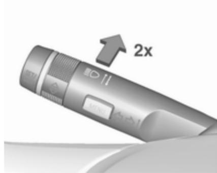
Les feux de route automatiques sont allumés en poussant deux fois le levier de clignotant lorsque le véhicule roule à une vitesse supérieure à 40 km/h.
