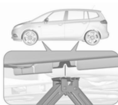
4. Vérifier que le cric est bien positionné sous le point de levage adéquat.
