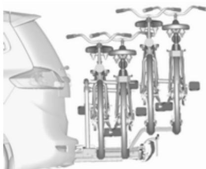
Le système de transport arrière (système Flex-Fix) permet de fixer deux bicyclettes au support de transport extensible intégré dans le plancher du véhicule. Il est possible de fixer deux vélos supplémentaires sur un adaptateur. Le transport d'autres objets n'est pas autorisé.
