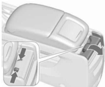
Enfoncer les deux cliquets et replier le mécanisme de verrouillage sur l'arrière de l'accoudoir.
