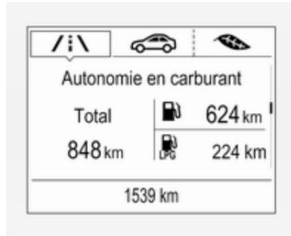
Affichage de l'autonomie approximative en carburant et pour chaque réservoir de carburant (GPL ou GNC et essence). Un niveau bas de carburant dans un des réservoirs est indiqué par **FAIBLE** dans la section correspondante.
