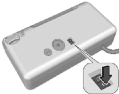
6. Mettre le commutateur à bascule du compresseur sur I. Le pneu se remplit de produit d'étanchéité.
