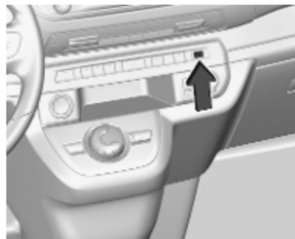
Un port USB est placé sur le tableau de bord.
