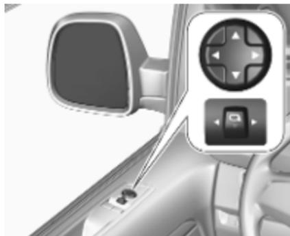
Sélectionner le rétroviseur extérieur concerné en appuyant sur le bouton
