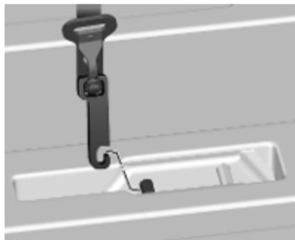
Insérer les fixations dans les ancrages du plancher des deux côtés.
