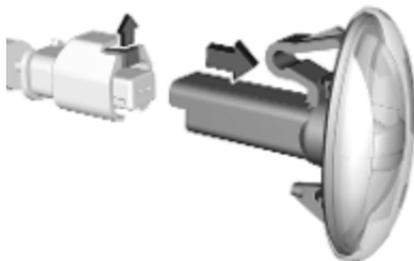
2. Tirer la patte de retenue vers le haut et retirer la douille d'ampoule du connecteur de prise.
