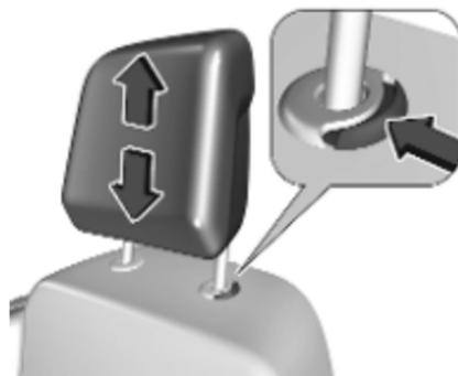
Déplacer l'appui-tête vers le haut ou le bas. Si l'appui-tête est bloqué, appuyer sur le loquet et déplacer l'appui-tête.
