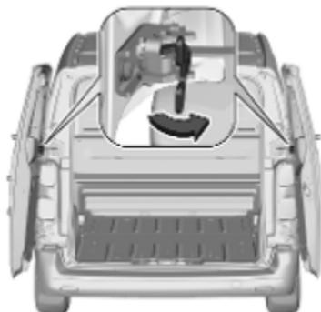
Les portes sont maintenues dans une position à 90°, grâce à des limiteurs d'ouverture. Pour ouvrir les portes à 180°, pousser le loquet et pivoter la porte à la position désirée. Avant de fermer les portes, s'assurer que les étais de verrouillage sont placés à 90°.
