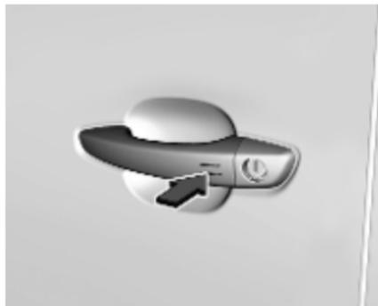
Système à clé électronique : Le déverrouillage du véhicule en appuyant sur l'une des poignées de porte avant aux marquages désactive le système antivol.
