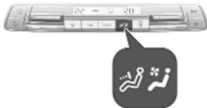
Pour activer la répartition de l'air climatisé / préchauffé via les bouches d'aération arrière, appuyer sur
