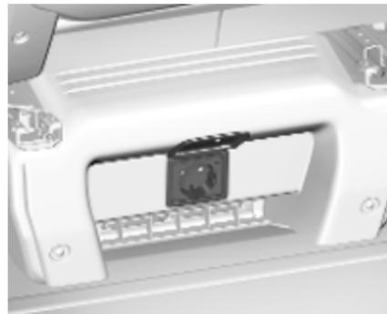
Une prise de courant de 220 V peut se trouver sous le siège passager avant.
