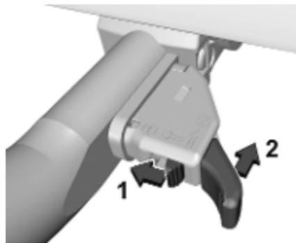
6. Déplacer 1 vers la gauche et le maintenir enfoncé, pousser 2 vers l'arrière et retirer la boule d'attelage.
