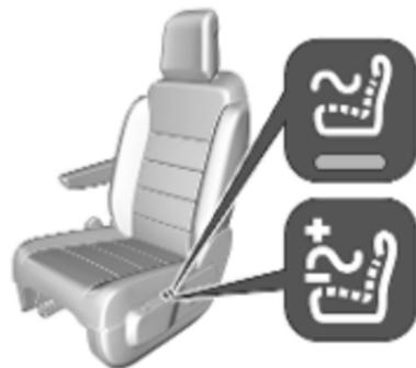
Activer la fonction de massage du dos en appuyant sur
