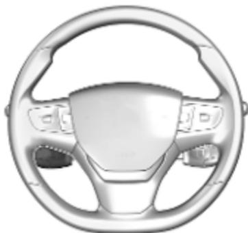
Le régulateur de vitesse, le régulateur de vitesse adaptatif et le limiteur de vitesse sont commandés par la commande d'assistance au conducteur du côté gauche de la colonne de direction.
