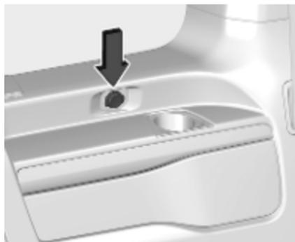
Une autre prise de courant de 12 V peut se trouver du côté inférieur gauche du pied arrière.
