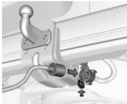
3. Connecter la prise de remorque à la douille et fixer le câble d'arrêt de rupture à l'œillet sur le support.
