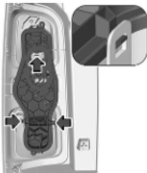
7. Dégager la patte de retenue centrale, tirer sur le support d'ampoule et désengager les pattes de retenue restantes.
