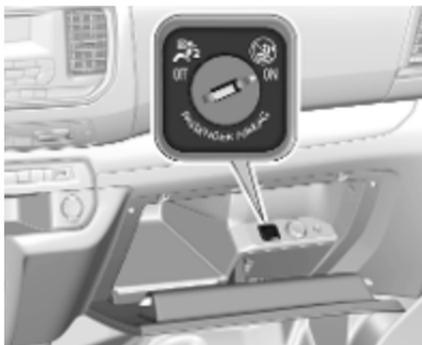
Le système d'airbag de passager avant peut être désactivé via un commutateur placé du côté passager du tableau de bord.
