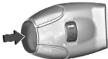
Appuyer sur le bouton pour désactiver la fonctionnalité. Le limiteur de vitesse est en mode pause et un message s'affiche. Le véhicule est conduit sans limitation de vitesse.
