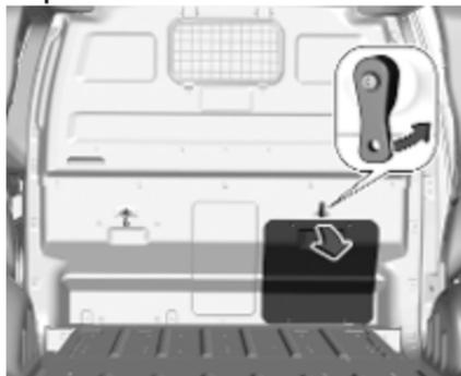
1. Relâcher le dispositif de verrouillage, abaisser le volet puis le retirer.
