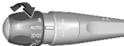
Quand la fonction de commande automatique des feux est activée et que le moteur tourne, le système bascule automatiquement entre les feux de jour et les phares, en fonction des conditions d'éclairage extérieur et des informations communiquées par le système d'essuie-glaces.
