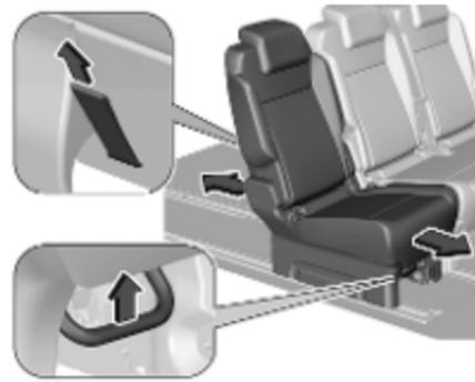
Pour débloquer le siège, tirer le levier avant vers le haut ou tirer sur la boucle à l'arrière sans dépasser le point de résistance.
