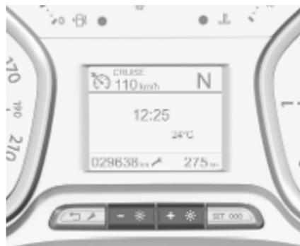
La luminosité est réglable lorsque l'éclairage extérieur est allumé.
