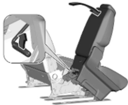
Tirer sur le levier de déblocage et basculer le siège vers l'avant.
