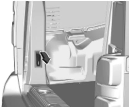
L'une des lampes de l'éclairage du coffre peut être utilisée comme lampe de poche.
