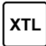
Carburant diesel paraffiné conforme à la norme EN15940 mélangé à un biocarburant conforme à la norme EN14214 (pouvant contenir jusqu'à 7 % d'ester méthylique d'acide gras).
