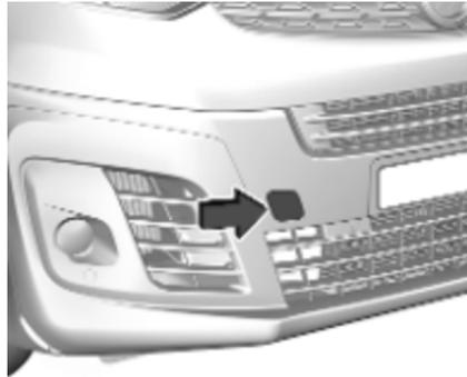
Appuyer sur le milieu de la plaque de recouvrement et faire glisser jusqu'au coin supérieur gauche pour la détacher.
