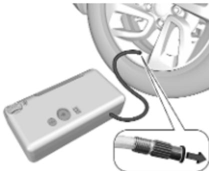
4. Dérouler totalement le flexible d'air et dévisser le capuchon du bout du flexible. Brancher le flexible à la valve du pneu défectueux.
