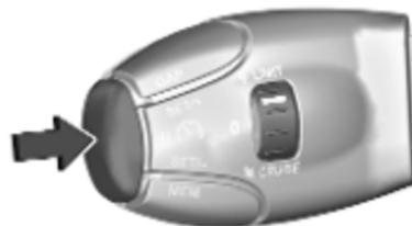
Appuyer sur le bouton pour désactiver la fonctionnalité. Le régulateur de vitesse est en mode pause et un message s'affiche. Le véhicule est conduit sans régulateur de vitesse.
