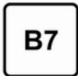
Carburant diesel respectant la norme EN590 mélangé à un biocarburant respectant la norme EN14214 (avec possiblement jusqu'à 7 % d'ester méthylique d'acide gras)
