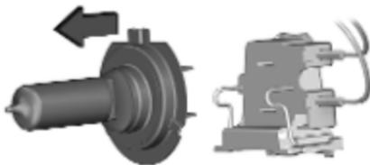
3. Séparer l'ampoule de la douille d'ampoule et remplacer l'ampoule.
