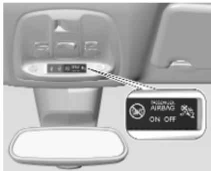
Si le témoin
