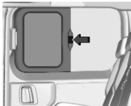
Pour ouvrir et fermer les vitres arrière, pousser le levier et faire coulisser les vitres vers l'arrière ou l'avant.
