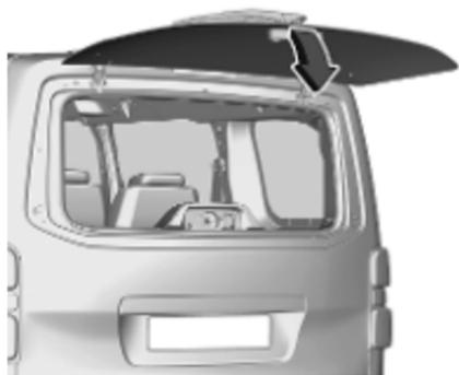
Appuyer au centre de la vitre jusqu'à la fermeture complète.
