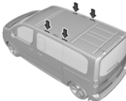
Fixer deux barres de toit en utilisant les points de fixation indiqués sur l'image.
