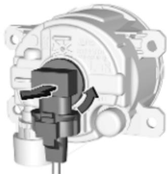
2. Tourner la douille d'ampoule dans le sens antihoraire et l'enlever du bloc optique.
