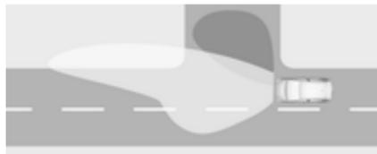
Activé à une vitesse jusqu'à 40 km/h lors de la mise hors tension. Selon l'angle de braquage ou l'activation des feux de direction, les phares antibrouillard avant éclairent la trajectoire.
