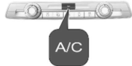
Appuyer sur **A/C** pour mettre le refroidissement en marche. L'activation est signalée par l'éclairage de la LED dans le bouton. Le refroidissement ne
