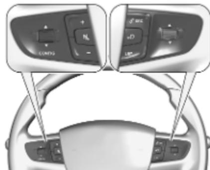
Les menus et fonctions du centre d'informations du conducteur peuvent être sélectionnés au moyen du bouton rotatif sur la tige gauche du volant.
