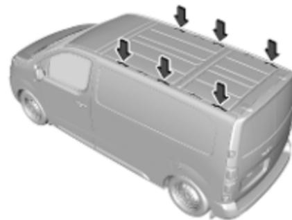
Fixer trois barres de toit en utilisant les points de fixation indiqués sur l'image.
