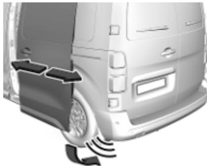
Pour ouvrir ou fermer une porte coulissante, bouger le pied d'avant en arrière sous le pare-chocs arrière du côté de la porte.
