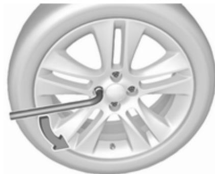
2. Placer la clé de roue et desserrer chaque boulon de roue d'un demi-tour.
