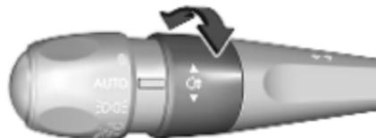
Faire tourner la bague de commande une fois pour activer ou désactiver le phare antibrouillard arrière.
