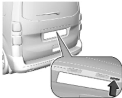
Avec la clé électronique à l'extérieur du véhicule et à une distance d'environ 1 m du hayon, appuyer sur le bouton du côté droit du hayon pour verrouiller le véhicule.
