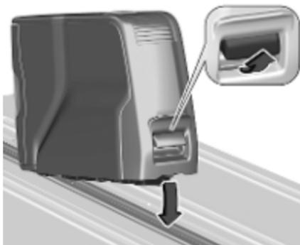
La poignée à l'avant doit être en position serrée. Placer l'arrière de la tablette multifonctions sur le rail et incliner l'avant vers le bas. Faire coulisser la tablette multifonctions jusqu'à ce qu'elle se bloque.
