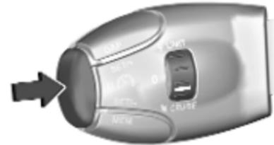
Appuyer sur le bouton pour désactiver la fonctionnalité. Le régulateur de vitesse est en mode pause et un message s'affiche. Le véhicule est conduit sans régulateur de vitesse.
