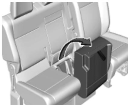
Une boîte de rangement peut être placée sous la banquette centrale à côté du siège conducteur. Lever l'assise de siège en tirant sur la poignée.
