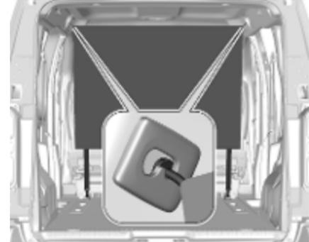
1. Des ouvertures de pose sont placées des deux côtés du cadre de toit. Ouvrir les couvercles s'ils sont présents.
