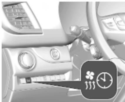
Le statut de fonctionnement du chauffage de stationnement est affiché par un témoin à LED.
