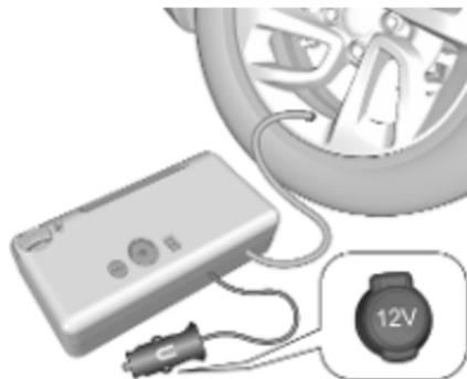
5. Brancher le câble électrique à la prise de courant 12 V à l'avant du véhicule ⇨ 101.
