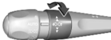
Faire tourner la bague de commande deux fois pour activer ou désactiver le phare antibrouillard arrière.
