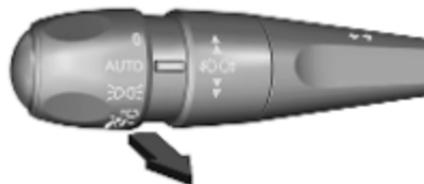
Pour allumer l'éclairage manuel de chemin, couper le contact, ouvrir la porte du conducteur et tirer sur le levier des clignotants.
