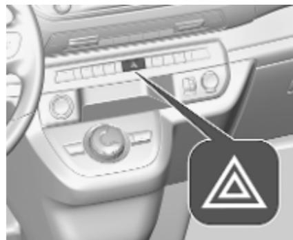
Pour les enclencher, appuyer sur
