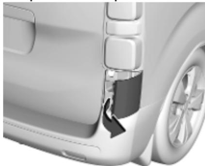
1. Véhicules avec un couvercle cachant la vis inférieure de l'ensemble de feu arrière : retirer le couvercle en dégageant délicatement ses pattes de fixation avec un tournevis et en inclinant légèrement le couvercle vers l'extérieur.
