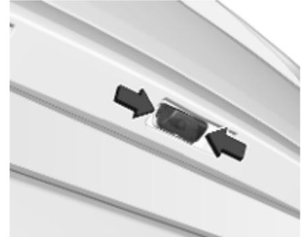
Insérer un tournevis fin, par exemple, dans l'un des renforcements du couvercle et le pousser vers l'extérieur pour le détacher. Enlever le cache.
