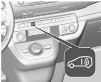
Pour activer, mettre le contact et appuyer sur
