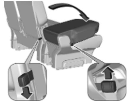
3. Tirer sur le levier avant ou pousser sur le levier arrière pour débloquer le dossier.
