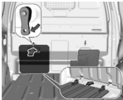
Faire tourner le dispositif de verrouillage vers le haut. Placer les charnières sur le volet dans leur logement, lever le volet et fermer le dispositif de verrouillage.
