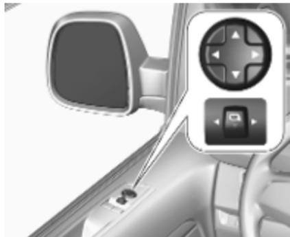
Sélectionner le rétroviseur extérieur concerné en appuyant sur le bouton
