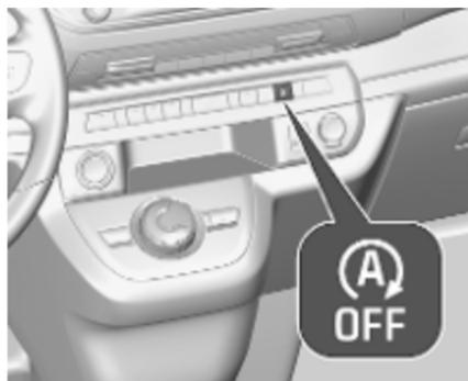
Appuyer sur (A) pour désactiver le système d'arrêt-démarrage. La désactivation est indiquée lorsque la DEL dans le bouton s'allume.
