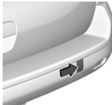
Sur le pare-choc arrière, appuyer sur le coin supérieur gauche de la plaque de recouvrement pour la détacher.
