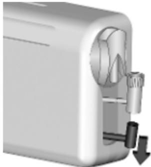
3. Tirer légèrement l'ensemble de tuyau vers l'extérieur puis débrancher le connecteur du flexible pneumatique en le faisant tourner d'un quart de tour dans le sens antihoraire.
