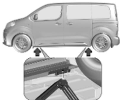
3. Vérifier que le cric est bien positionné sous le point de levage adéquat. Le positionner directement sous le point de levage de manière telle qu'il ne glisse pas.
