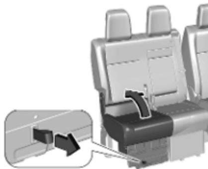
Pour lever l'assise de siège, tirer sur la boucle et lever l'assise de siège contre le dossier.
