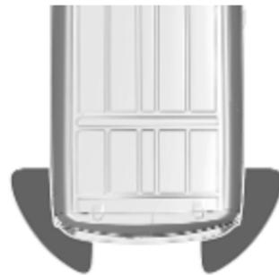
La clé électronique doit se trouver à l'extérieur du véhicule dans un rayon d'environ 1 m des détecteurs de mouvement. Selon la configuration du véhicule, la clé électronique doit être placée dans la zone correspondante. Ne pas laisser le pied trop longtemps ou le bouger trop lentement sous le pare-chocs.
