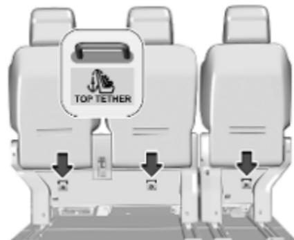
En plus des étriers de fixation ISOFIX, attacher la sangle Top-Tether aux ancrages Top-Tether.
