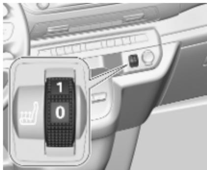
Activer le chauffage de siège en faisant tourner la molette
