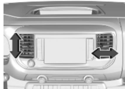
Régler la direction du flux d'air en faisant basculer et pivoter les lamelles.
