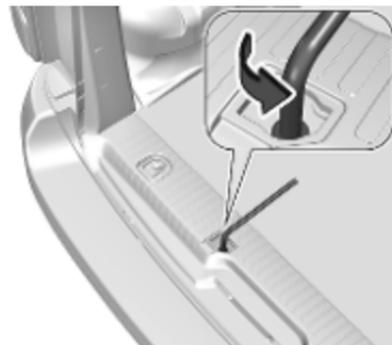
3. Placer la clé de roue sur le boulon hexagonal. Tourner dans le sens antihoraire jusqu'à ce que le support de roue de secours soit suffisamment abaissé pour permettre le décrochage du crochet.
