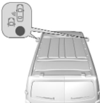
Lorsque le système détecte un véhicule dans la zone aveugle en roulant en avant, une diode s'allume dans le rétroviseur concerné.
