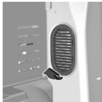
3. Véhicules avec bouche d'aération ou couvercle derrière les feux arrière, dans la garniture : Retirer la bouche d'aération ou le couvercle.
