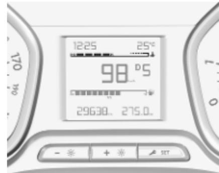
Une échelle constituée de segments blancs indique la température du liquide de refroidissement du moteur.
