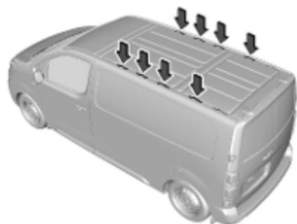
Fixer la galerie de toit en utilisant les points de fixation indiqués sur l'image.
