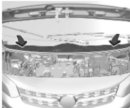
La prise d'air située à l'avant du pare-brise, dans le capot, doit être gardée propre pour permettre l'entrée de l'air. Enlever les feuilles, les saletés ou la neige.
