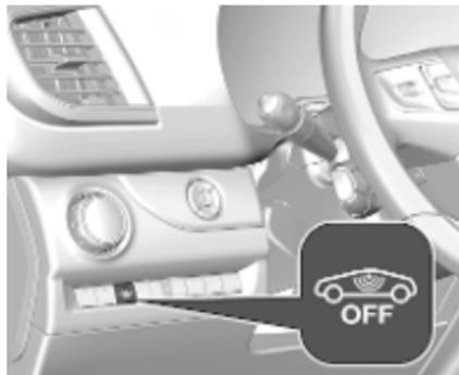
Désactiver la surveillance de l'habitacle quand des animaux sont laissés dans le véhicule en raison de la grande quantité de signaux ultrasoniques ou de leurs mouvements déclenchant l'alarme. La désactiver également quand le véhicule est à bord d'un ferry ou d'un train.
