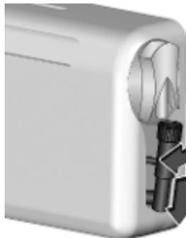
2. Débrancher le connecteur de la cartouche en le faisant tourner d'un quart de tour dans le sens antihoraire.
