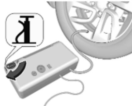
12. Prendre la route sans délai afin que le produit d'étanchéité se répartisse uniformément dans le pneu. Après un trajet d'environ 5 km mais pas plus de dix minutes, s'arrêter et contrôler la
