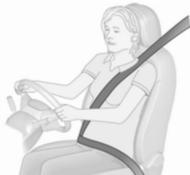
Tirer la ceinture de sécurité et l'attacher dans la boucle de ceinture. La ceinture de sécurité ne doit pas être vrillée et doit être placée près du corps. Le dossier ne doit pas être incliné trop en arrière (environ 25° maximum).
