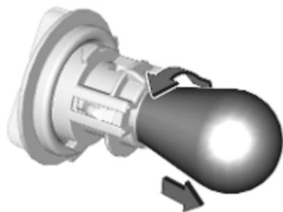
3. Enfoncer légèrement l'ampoule, la faire tourner dans le sens anti-horaire et la retirer de la douille.
