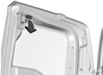
Envelopper d'un linge l'extrémité d'un tournevis pour ne pas endommager la peinture. Retirer le couvercle intérieur ou la bouche d'aération avec le tournevis.
