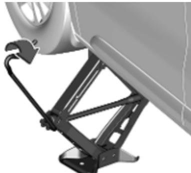
Attacher la clé de roue, aligner correctement le cric et tourner la clé de roue jusqu'à ce que la roue ait quitté le sol.
