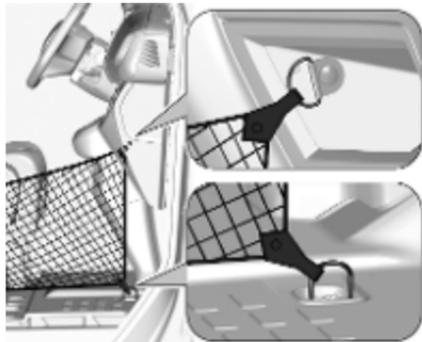
4. Attacher les crochets aux anneaux d'arrimage dans la boîte à gants et sur le plancher.
