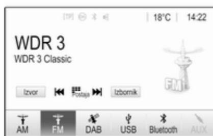
Odaberite željeno valno područje. Primat će se program zadnje reproducirane postaje na odabranom valnom području.
