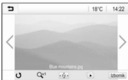
Dodirnite zaslon za skrivanje trake izbornika. Ponovno dodirnite zaslon za prikazivanje trake izbornika.
