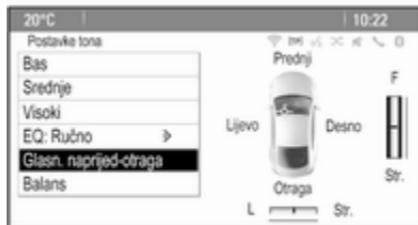
Za namještanje raspodjele glasnoće između prednjih i stražnjih zvučnika na vozilu odaberite stavku izbornika **Glasn. naprijed-otraga**. Namjestite postavku po želji.
