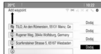
Odaberite tipku na zaslonu **Dodaj** na mjestu na kojem želite dodati točku na putu. Prikazat će se izbornik **Unos odredišta**.
