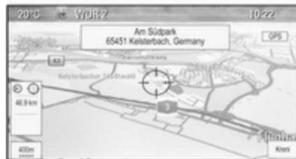
Pritisnite višefunkcijski kogačić za uključivanje tipke na zaslonu **Kreni**. Prikazat će se izbornik za potvrdu. Odaberite stavku izbornika **Počni vođenje** kako biste započeli navođenje po ruti.
