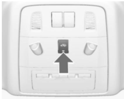
Isključite nadzor putničkog prostora i naginjanja vozila kada u vozilu ostaju životinje jer velika količina ultrazvučnih signala ili gibanje mogu aktivirati alarm. Isključite i kad je vozilo na trajektu ili u vlaku.
