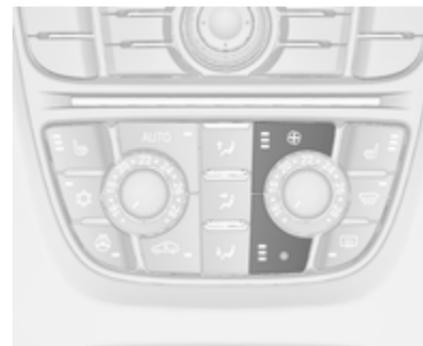
Pritisnite donji prekidač za smanjenje ili gornji prekidač za povećanje brzine ventilatora, kao što pokazuje ilustracija. Brzina ventilatora označena je brojem segmenata na zaslonu.
