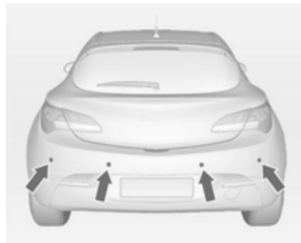
Pomoć pri parkiranju olakšava parkiranje mjerenjem udaljenosti između vozila i prepreka, i davanjem zvučnih signala.
