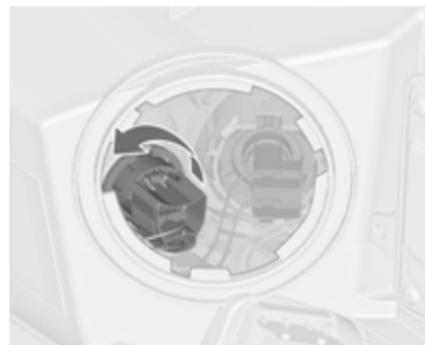
2. Držač žarulje odvrnite suprotno od smjera kazaljki na satu i odvojite ga. Izvucite žarulju iz kućišta lampe.
