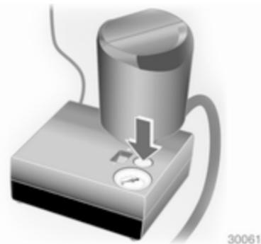
Ako propisani tlak nije postignut u roku od 10 minuta, odspojite kit za popravak gume. Pomaknite vozilo za jedan okretaj gume. Ponovno spojite kit za popravak gume i nastavite postupak pumpanja tijekom 10 minuta. Ako propisani tlak još uvijek nije
