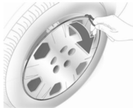
1. Otkočite čepove matica kotača pomoću odvijača i uklonite ih. Kukom skinite poklopac kotača. Alat vozila ⇨ 182.
