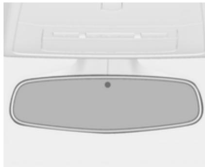
Zaslijepljenost od vozila iza Vas se po noći smanjuje automatski.
