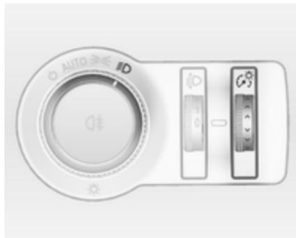
Osvjetljenje sljedećih svjetala možete podešavati kad su uključena vanjska svjetla:
