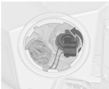
2. Držač žarulje zakrenite suprotno od kazaljke na satu za odspajanje. Izvucite sijalicu iz kućišta svjetla.
