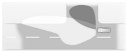
Kod oštih zavoja ili prilikom skretanja, ovisno o kutu zakreta kola upravljača ili pokazivaču smjera, dodatno se uključuje lijevi ili desni reflektor koji osvjetljava cestu pod pravim kutom u odnosu na smjer vožnje. Aktivirano je do brzine od 40 km/h.
