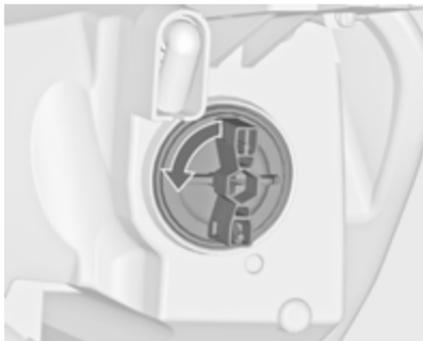
1. Držač žarulje (3) odvrnite suprotno od smjera kazaljki na satu i odvojite ga. Izvucite žarulju iz kućišta lampe.
