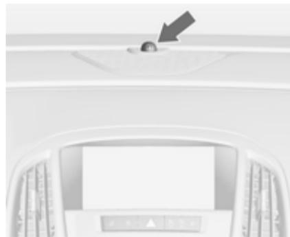
LED statusa je integriran u senzor na vrhu ploče s instrumentima.
