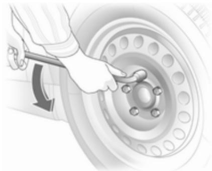
2. Postavite ključ za vijke kotača pazeći da je pravilno nasjeo i otpustite svaku maticu kotača za pola okretaja.
