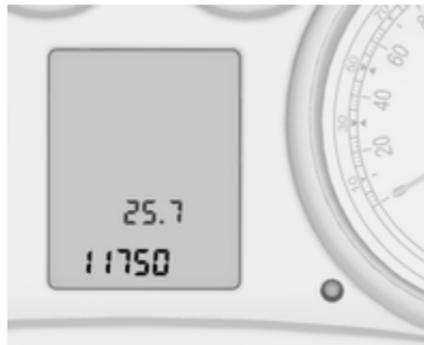
Informacijski centar vozača (DIC) se nalazi na sklopu instrumenata između brzinomjera i mjerača broja okretaja. Dostupan je kao zaslon srednje razine, zaslon visoke razine ili zaslon kombinirane visoke razine opreme.
