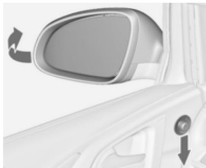
Zakrenite prekidač na **0**, zatim ga pritisnite dolje. Oba vanjska ogledala će se preklopiti.
