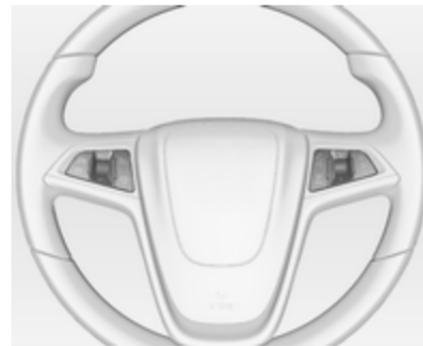
Infotainment sustavom, tempomatom i spojenim mobilnim telefonom se može upravljati kontrolama na kolu upravljača.
