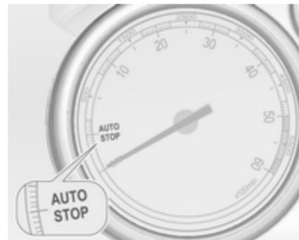
Ako se vozilo kreće malom brzinom ili stoji, a određeni uvjeti su ispunjeni, aktivirajte funkciju Autostop na sljedeći način:
