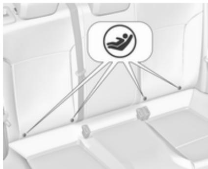
Učvrstite za vozilo odobrene ISOFIX sigurnosne sustave za dijete na ISOFIX nosače za ugradnju. Položaji ISOFIX sigurnosnog sustava za dijete specifični za vozilo označeni su s IL u tablici.
