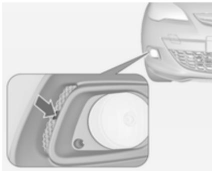
1. Odbravite poklopac odvijačem u utoru i skinite ga.
