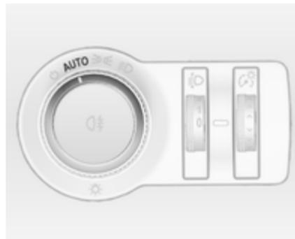
Kada je uključena funkcija automatske kontrole svjetala i motor radi, sustav se automatski prebacuje između svjetala za vožnju po danu i prednjih svjetala ovisno o uvjetima osvjetljenja i informaciji koju daje sustav senzora za kišu.
