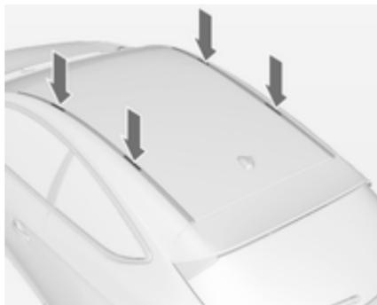
Odspojite poklopac na svakoj pričvrstnoj točki uz pomoć kovanice.
