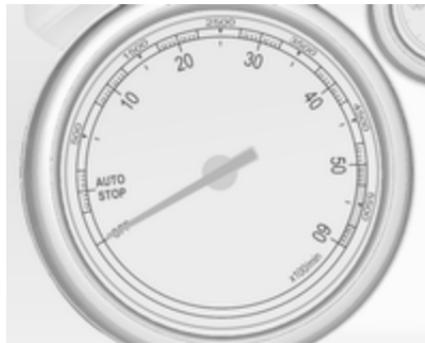
Prikazuje brzinu vrtnje motora.
