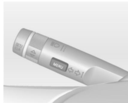
Pritisnite **MENU** prekidač za prebacivanje između izbornika ili za povratak iz podizbornika u sljedeću višu razinu izbornika.
