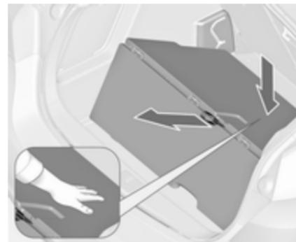
Za spuštanje poklopca, povucite remen prema natrag i istovremeno prednji srednji dio poklopca gurnite prema dolje.
