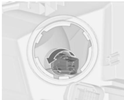
2. Držač sijalice zakrenite suprotno od kazaljke na satu i izvadite ga.
