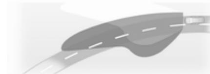
Snop svjetla se zakreće na osnovi položaja kola upravljača i brzine, poboljšavajući osvjetljenje u zavojima.
