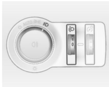
Za prilagođavanje snopa prednjih svjetala opterećenju vozila radi sprječavanja zaslepljivanja: zakrenite kotačić  $\text{D}$  u željeni položaj.
