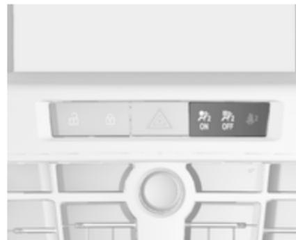
Sve dok kontrolno svjetlo
