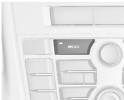
Ručno isključite sustav stop-start pritiskom na tipku **eco**. Isključenje označava isključivanje LED diode na tipki.
