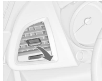
Usmjerite struju zraka zakretanjem i naginjanjem rešetki.
