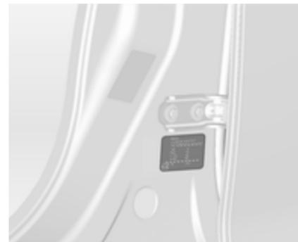
Identifikacijska pločica se nalazi na okviru prednjih lijevih vrata.
