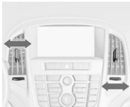
Za otvaranje otvora za provjetravanje, kodačić za podešavanje zakrenite prema većem ■ simbolu. Količinu zraka na otvoru podesite zakretanjem kodačića za podešavanje.
