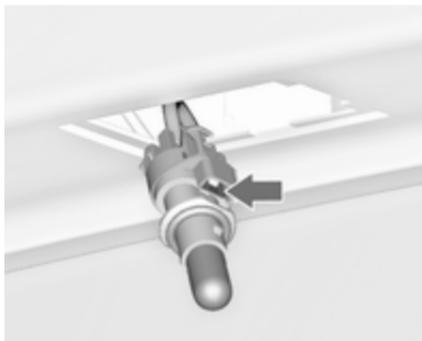
3. Odspojite osigurač i držač sijalice odvojite od konektora ožičenja.
