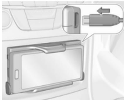
Priključite pametni telefon na držač telefona pomoću kompatibilnog priključnog kabela. U dodatnoj su opremi dostupne različite verzije priključnih kabela.
