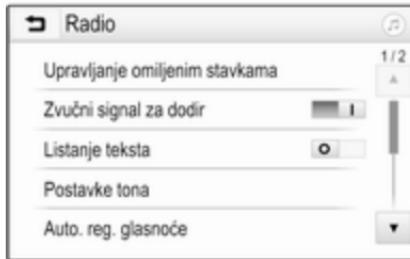
Dodirnite gumb na zaslonu pored funkcije **Zvučni signal za dodir** kako biste je uključili ili isključili.
