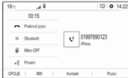
Za isključivanje mikrofona Infotainment sustava, dodirnite **Mikro OFF**.
