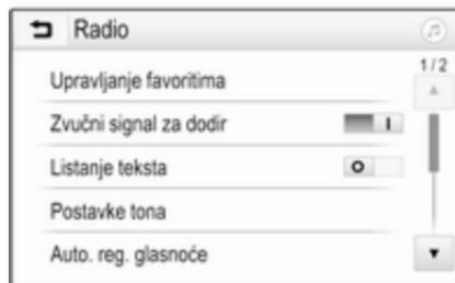
Dodirnite gumb na zaslonu pored funkcije **Zvučni signal za dodir** kako biste je uključili ili isključili.
