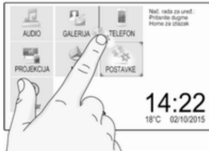
Dodirnite i držite element koji želite pomaknuti sve dok se oko ikona ne prikažu crveni okviri. Pomaknute prst na željeno mjesto i otpustite element.
