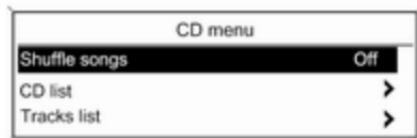
Zakrenite višefunkcijski kotačić za označavanje funkcije koja će se uključiti ili isključiti. Pritisnite višefunkcijski kotačić za prebacivanje između postavki **On (Uključeno)** i **Off (Isključeno)**.
