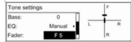
Odaberite **Fader:** (Zvuk naprijed-natrag:). Postavite željenu vrijednost.
