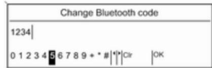
Odaberite **Change Bluetooth code** (**Promjeni kod Bluetooth uređaja**). Na prikazanom izborniku, uredite aktualni Bluetooth kod i prihvativte izmijenjeni kod korištenjem **OK**.
