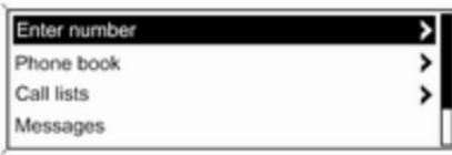
S aktivnim glavnim izbornikom telefona, pritisnite višefunkcijski kotačić za otvaranje izbornika za korištenje telefona.
