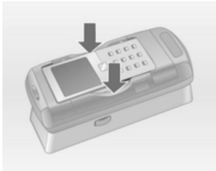
S otvorenim bočnim nosačima adaptera, okomito spustite mobilni telefon u adapter kao što je prikazano na slici iznad dok se bočni nosači ne zakače.
