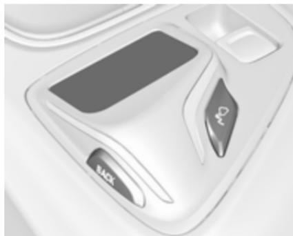
Dodirna površina je osjetljiva na dodir i tako omogućuje upravljanje dodatnim funkcijama izbornika na središnjem zaslону. Nalazi se iza ručice mjenjača.
