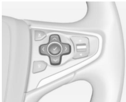
Peterosmjerni kontroler sastoji se od četiri tipke za određivanje smjera i tipke za potvrdu (✓).
