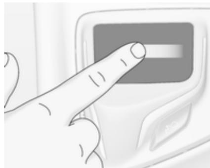
Pomaknite prst u smjeru elementa koji želite odabrati. Pokazivač će se pomicati s jednog odabranog elementa zaslona na drugi.
