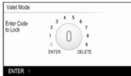
Unesite četveroznamenkasti kod i odaberite gumb **ENTER (UNESI)**. Tipkovnica s brojevima se ponovno prikazuje.
