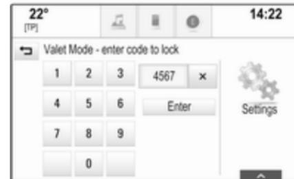
Unesite četveroznamenkasti kod i odaberite gumb **Enter (Unesi)**. Tipkovnica s brojevima se ponovno prikazuje.
