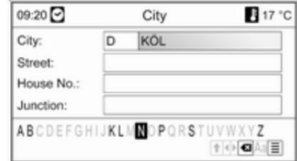
Pomoću višefunkcijskog kotačića redom označite i prihvati slova za željeni grad. Tijekom ovog procesa sustav će automatski blokirati slova koja se ne mogu dalje pojaviti u imenu grada.
