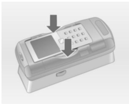
S otvorenim bočnim nosačima adaptera, okomito spustite mobilni telefon u adapter kao što je prikazano na slici iznad dok se bočni nosači ne zakače.
