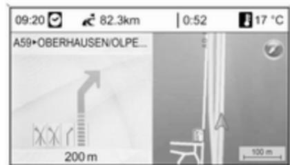
Ako je opcija **Highway lane guidance** (**Navođenje na izlazima s autocesta**) aktivirana u **Display route guidance** (**Prikaži vođenje po ruti**) izborniku (pogledajte poglavlje "Navođenje" ▷ 91), prikazuje se sljedeći tip ilustracije:
