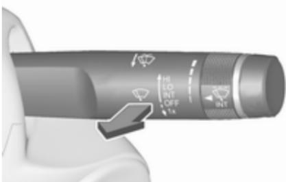
Tirare la leva. Il liquido di lavaggio viene spruzzato sul parabrezza e il tergilavavetri effettua alcuni passaggi.
