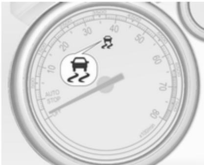
Il sistema TC è operativo dopo ogni avviamento del motore, allo spegnimento della spia .
