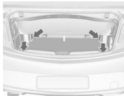
Gli occhielli di ancoraggio servono per fissare gli oggetti ed evitare che scivolino, utilizzando ad esempio delle cinghie di ancoraggio o una rete fermabagagli.
