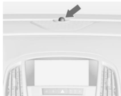
Il LED di stato è integrato nel sensore nella parte superiore del quadro strumenti.
