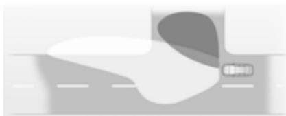
Nelle curve strette o durante le svolte, a seconda dell'angolo di sterzata o del segnale dell'indicatore di direzione, viene attivato un riflettore supplementare destro o sinistro che illumina la strada ad angolo retto
