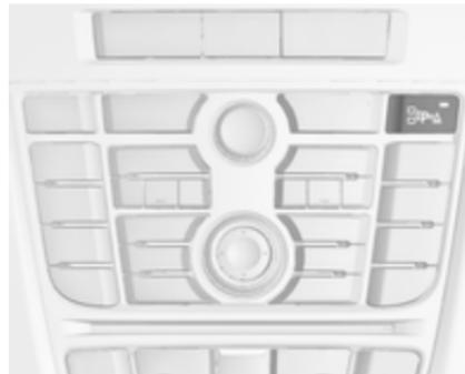
Quando si è in cerca di un parcheggio, il sistema è pronto a funzionare premendo per circa un secondo.
