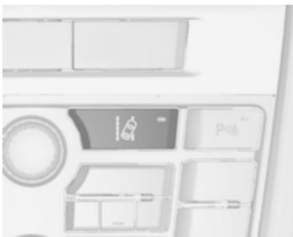
Attivare l'avvisatore di cambio accidentale della corsia di marcia premendo . Quando il sistema è inserito il LED del pulsante si accende. Quando la spia nel quadro strumenti si accende di colore verde, il sistema è pronto a entrare in funzione.
