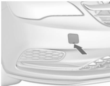
Inserire un cacciavite nella fessura sulla parte inferiore del cappello. Sganciare il coperchio muovendo con cautela il cacciavite verso il basso. L'occhiello di traino è riposto insieme agli attrezzi per il veicolo ⇨ 221.
