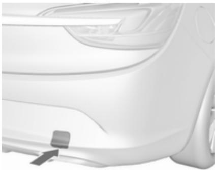
Inserire un cacciavite nella fessura sulla curvatura inferiore del cappello. Sganciare il coperchio muovendo con cautela il cacciavite verso il basso.
