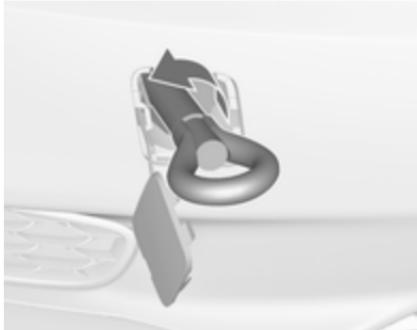
Avvitare a fondo l'occhiello di traino in senso antiorario fino all'arresto in posizione orizzontale.
