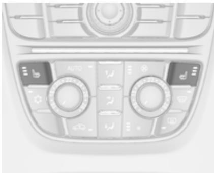
Regolare il riscaldamento sul livello desiderato premendo del relativo sedile una o più volte. I LED luminosi nel pulsante indicano l'impostazione.
