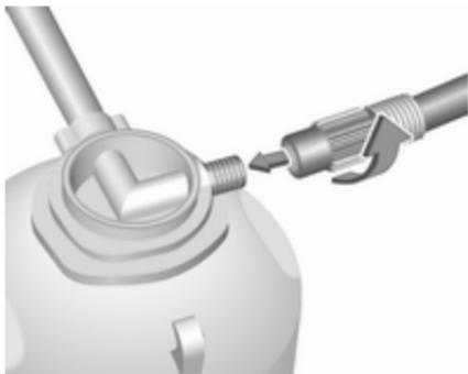
4. Avvitare i flessibile dell'aria del compressore sul raccordo della bombola del sigillante.
