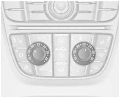
Se è impostata la temperatura minima **Lo**, il sistema di controllo del climatizzatore funziona al raffreddamento massimo, se ☀ è azionato.
