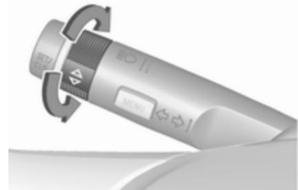
Scegliere **Impostaz.** premendo **MENU** e selezionare la voce **Rilevamento dei segnali stradali** mediante la manopola sulla leva dell'indicatore di direzione ⇔ 99.
