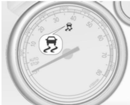
Il sistema ESC è operativo dopo ogni avviamento del motore, allo spegnimento della spia .
