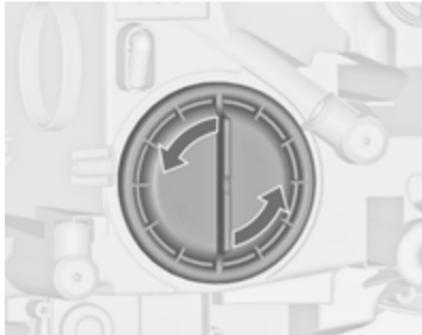
1. Ruotare il coperchio (1) in senso antiorario e rimuoverlo.
