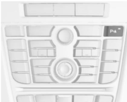
Il sistema di ausilio al parcheggio anteriore-posteriore è dotato di **P/A**. Se il veicolo è anche dotato di dispositivo di assistenza al parcheggio avanzato (consultare la seguente descrizione a parte), il sistema è dotato di **P/A**. Entrambi i sistemi saranno azionati premendo **P/A**.
