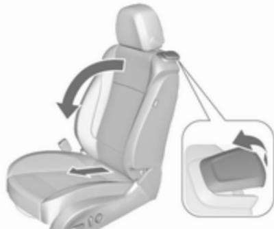
Sollevare la leva di sblocco e piegare lo schienale in avanti. Il sedile scorre automaticamente in avanti fino in battuta.
