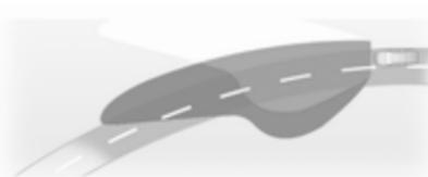
Il fascio di luce ruota a seconda dell'angolo di sterzata del volante e della velocità, migliorando la luminosità in curva.
