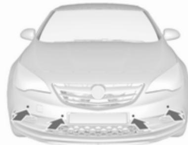
Il sistema è dotato di quattro sensori di parcheggio ad ultrasuoni ubicati nel paraurti posteriore e anteriore.
