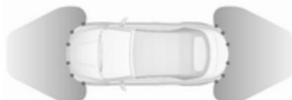
Il sistema avanzato di ausilio al parcheggio guida le manovre del conducente in uno spazio di parcheggio dando le rispettive istruzioni nel Driver Information Center e mediante segnalazioni acustiche. Il conducente deve controllare accelerazione, frenata, sterzata e cambio di marcia.
