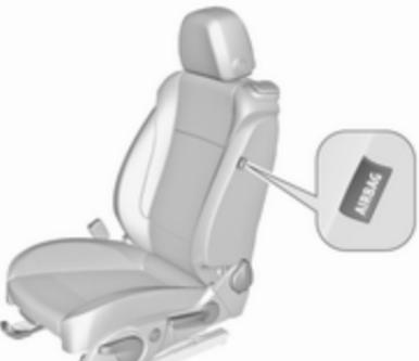
Il sistema airbag laterale è formato da due airbag, uno su ciascun bracciolo del sedile anteriore. La loro presenza viene segnalata dalla scritta **AIRBAG**.
