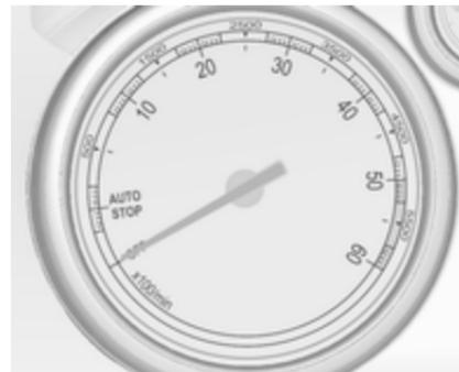
Indica la velocità di rotazione del motore.
