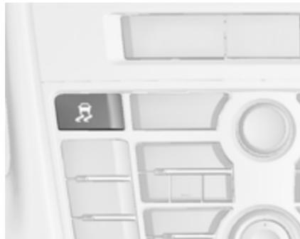
Il controllo della trazione può essere disattivato quando è richiesto lo slittamento delle ruote motrici:
