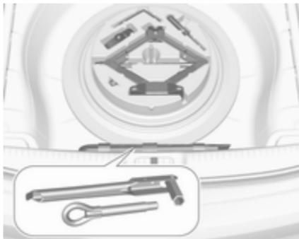
Sotto la ruota di scorta si trova una scatola e un sacchetto con attrezzi per il veicolo. La borsa porta attrezzi è fissata con un attacco alla barra di stivaggio. Rimuovere l'attacco della cassetta degli attrezzi e della borsa porta attrezzi dalla barra di stivaggio per accedere agli attrezzi nella borsa. Attrezzi per il veicolo  $\Rightarrow$  221.
