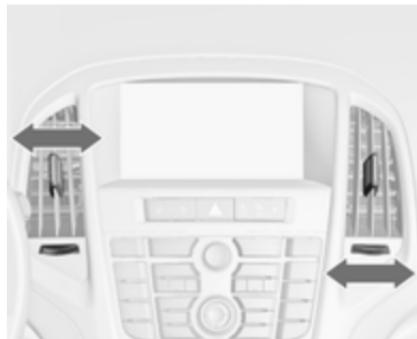
Per aprire la bocchetta, ruotare la manopola di regolazione verso il simbolo di maggiori dimensioni ▲. Regolare la quantità di aria all'uscita della bocchetta ruotando la manopola di regolazione.
