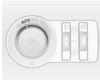
Quando la funzione di comando automatico dei fari è attivata e il motore è in funzione, il sistema passa dalle luci diurne all'accensione dei fari automaticamente, a seconda delle condizioni della luminosità esterna e delle informazioni fornite dal sistema del sensore pioggia.
