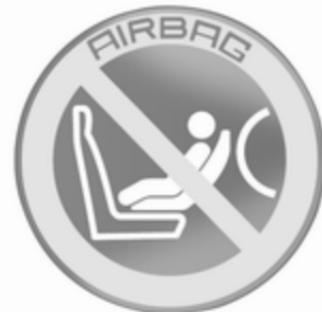
Inoltre, sul lato del quadro strumenti è presente un'etichetta di avvertenza, visibile quando la portiera del passeggero anteriore è aperta o sull'aletta parasole del passeggero anteriore.
