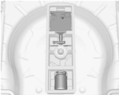
Il kit di riparazione dei pneumatici si trova in una scatola sotto la copertura del pianale nel vano di carico.
