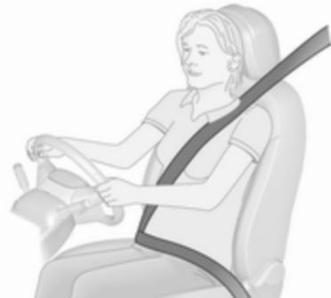
Le cinture di sicurezza sono bloccate durante le accelerazioni e decelerazioni brusche del veicolo per mantenere gli occupanti dell'auto in posizione corretta. In questo modo il rischio di lesioni si riduce notevolmente.
