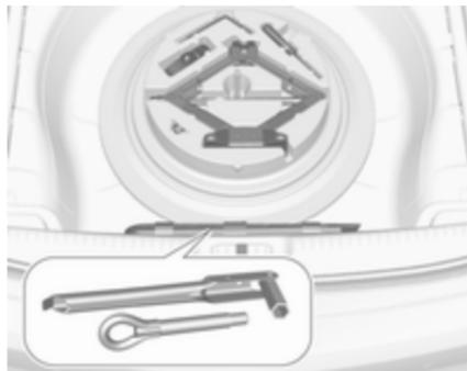
Aprire la copertura del pianale di carico. Il martinetto, gli attrezzi e una cinghia per fissare una ruota danneggiata si trovano nella cassetta porta attrezzi sotto la ruota di scorta nel vano di carico.
