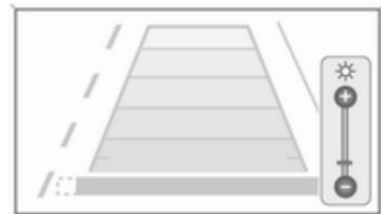
**Navi 650/Navi 950:** è possibile impostare la luminosità dapprima premendo e poi ruotando la ghiera esterna della manopola multifunzione.
