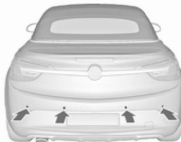
Il sistema è dotato di quattro sensori di parcheggio ad ultrasuoni ubicati nel paraurti posteriore.
