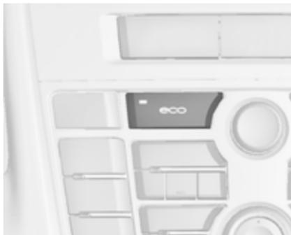
Disattivare il sistema Start-stop manualmente premendo **eco**. La disattivazione è indicata dallo spegnimento del LED presente nel pulsante.
