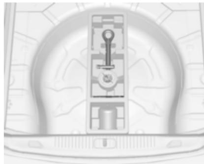
Alcuni attrezzi e l'occhiello di traino sono riposti in una cassetta porta attrezzi ubicata nel vano di carico sotto la copertura del pavimento.
