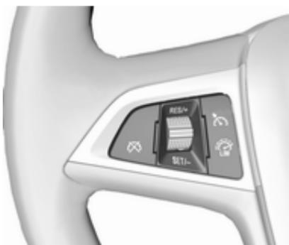
Premere . Se il controllo automatico della velocità di crociera è stato attivato prima, questo viene disinserito all'attivazione del limitatore di velocità e la spia si spegne.
