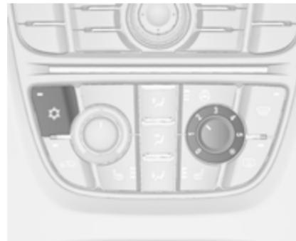
Premere per inserire il raffreddamento. Il LED del pulsante si illumina per indicare l'attivazione. Il raffreddamento funziona solamente con il motore acceso e la ventola del climatizzatore inserita.
