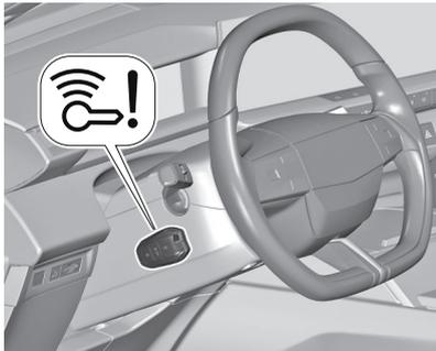
Tenere la chiave elettronica nella posizione contrassegnata sul piantone dello sterzo, come mostrato nella figura. Nei veicoli dotati di cambio manuale, mettere in folle, premere il pedale della frizione, il pedale del freno e premere **Start/Stop**.
