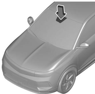
Non attaccare autoadesivi come vignette autostradali o simili sul parabrezza nell'area dello specchietto interno. Mantenere il sensore libero da polvere, sporco e ghiaccio. In caso contrario, l'area di rilevamento del sensore pioggia/ sensore luce e l'area di visione della telecamera nell'alloggiamento dello specchietto potrebbero subire limitazioni. ⇨ pagina45
