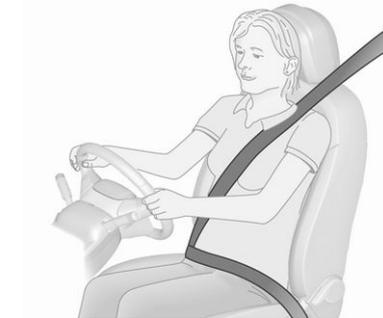
Le cinture di sicurezza sono bloccate durante le accelerazioni e decelerazioni brusche del veicolo, per mantenere gli occupanti dell'auto in posizione corretta.
