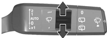
Leva del tergicristallo in posizione **AUTO**. In posizione **AUTO** Il sensore pioggia rileva la quantità d'acqua sul parabrezza e regola automaticamente la frequenza di funzionamento del tergicristalli.
