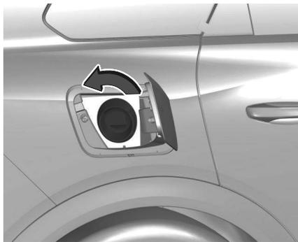
Posizionare l'ugello in posizione rettilinea rispetto al bocchettone di rifornimento e premere delicatamente per inserirlo. Per effettuare il rifornimento, attivare l'ugello della pompa.
