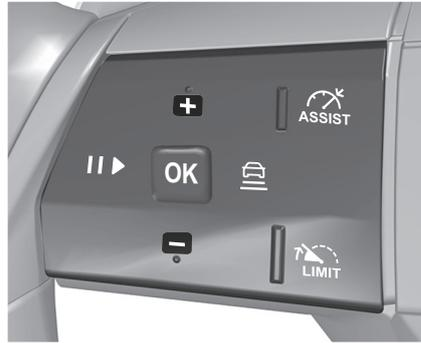
La velocità preimpostata si può modificare premendo + per aumentarla oppure - per diminuirla. Premere brevemente per modificare la velocità di 1 km/h, una pressione lunga del pulsante modifica la velocità di 5 km/h. Premere + o - per attivare.
