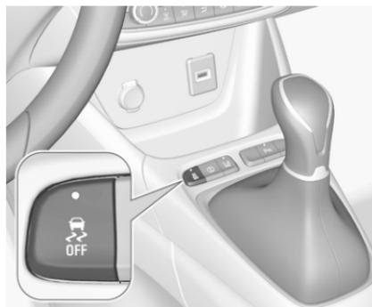
Il sistema ESC e il sistema di controllo della trazione possono essere disattivati se necessario: premere .
