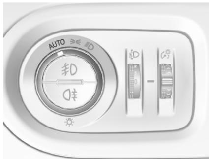
Quando la funzione di comando automatico dei fari è attivata e il motore è in funzione, il sistema passa dalle luci diurne all'accensione dei fari automaticamente, a seconda delle condizioni della luminosità esterna e delle informazioni fornite dal sistema dei tergilampi.
