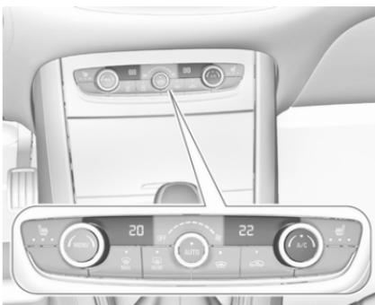
Premere **A/C** per inserire il raffreddamento. Il LED del pulsante si illumina per indicare l'attivazione. Il raffreddamento funziona solamente con il motore acceso e la ventola del climatizzatore inserita.
