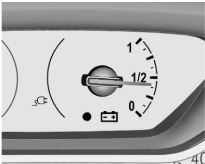
L'indicatore della batteria indica lo stato di carica della batteria ad alta tensione.
