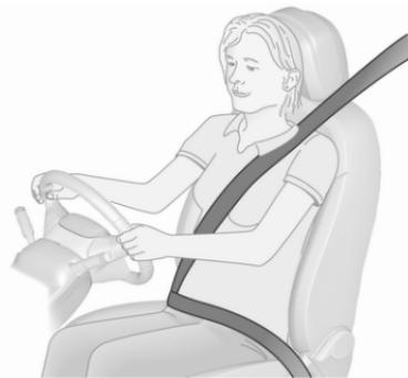
Regolare l'altezza della cintura in modo che questa poggi sulla spalla. E non sul collo o sul braccio.
