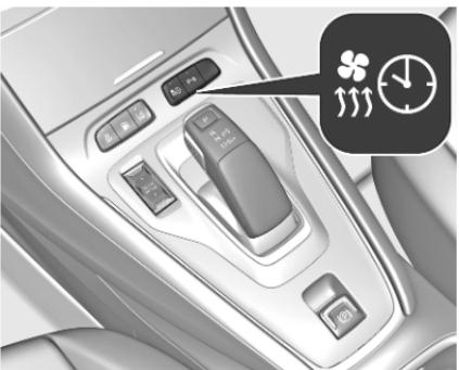
Lo stato operativo del riscaldatore da parcheggio è indicato da un indicatore dotato di LED.
