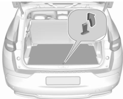
È possibile sollevare e rimuovere la copertura del pavimento posteriore. Sollevare la copertura sull'angolo e rimuovere.
