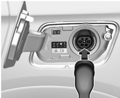
5. Inserire la presa del veicolo del cavo di carica nella presa di carica sul veicolo.
