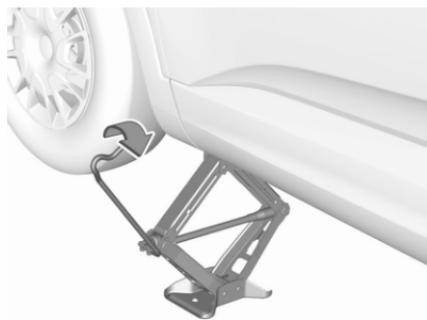
Con il martinetto correttamente allineato, ruotare la chiave ruota fino a quando la ruota non poggia più per terra.
