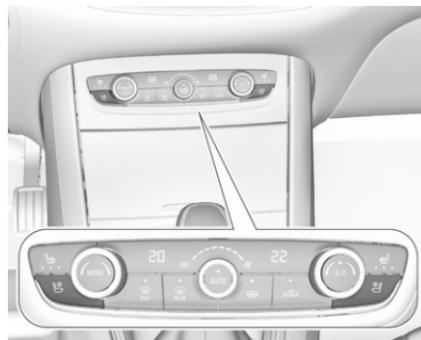
Attivare il sistema di ventilazione premendo del relativo sedile anteriore.
