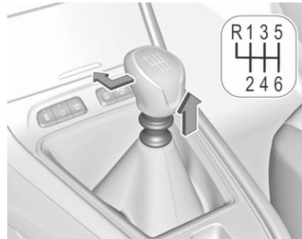
Per inserire la retromarcia con un cambio a 6 marce, premere il pedale della frizione, tirare l'anello situato sotto alla leva del cambio e portare quest'ultima completamente a sinistra e in avanti.
