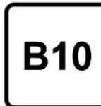
Carburante diesel conforme alla norma EN16734 mescolato con un biocombustibile conforme alla norma EN14214 (possibilmente con una percentuale di estere metilico di acidi grassi superiore al 10%).
