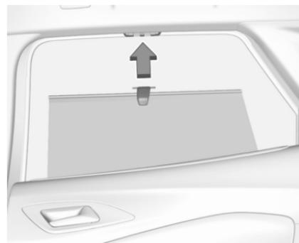
Per ridurre l'irraggiamento solare sui sedili della seconda fila, sollevare la tendina parasole mediante l'impugnatura e agganciarla nella parte superiore del telaio della portiera.
