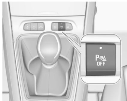
Il sistema si disattiva disinserendo la retromarcia. Premere per disattivare manualmente il sistema. Il LED del pulsante si accende quando il sistema viene disattivato. Se il sistema viene disattivato manualmente, non si riattiverà automaticamente la prossima volta che si inserisce l'accensione.
