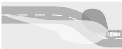
LED speciali, basati su angolo di sterzata e velocità, vengono azionati in aggiunta per migliorare l'illuminazione nelle curve. Questa funzione si attiva a una velocità compresa tra 40 km/h e 70 km/h.
