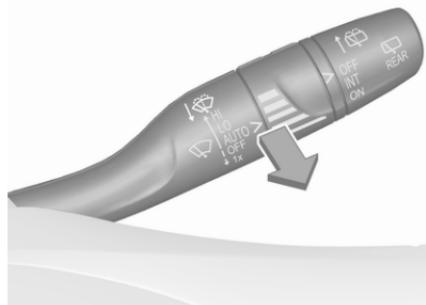
Tirare la leva. Il liquido di lavaggio viene spruzzato sul parabrezza e il tergilustrini effettua alcuni passaggi.
