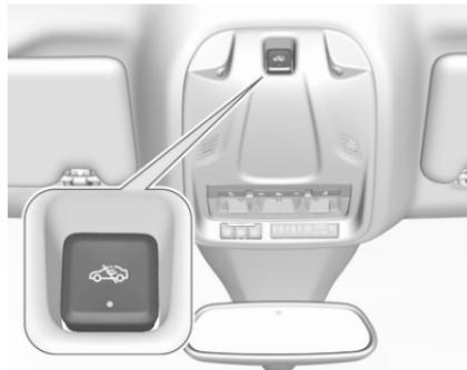
Disattivare la funzione di controllo dell'abitacolo e dell'inclinazione del veicolo se persone o animali sono all'interno del veicolo a causa dei forti segnali a ultrasuoni e della possibile attivazione dell'allarme provocata dai movimenti. Disattivare anche se il veicolo viene trasportato su un traghetto o su un treno.
