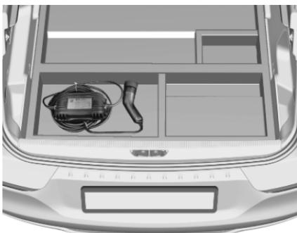
Un cavo di carica portatile utilizzato per caricare la batteria ad alta tensione del veicolo viene conservato sotto la copertura del vano portaoggetti del pianale posteriore ⇨ 212. Il cavo di carica è compatibile con la presa elettrica domestica del rispettivo Paese. Include una scatola di comando con indicatori di stato della ricarica.
