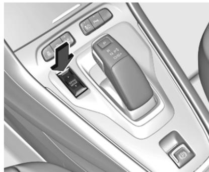
Le modalità di guida possono essere selezionate mediante il selettori della modalità di guida. La modalità di guida selezionata viene indicata nel Driver Information Center e nel Visualizzatore Info. Selezionare una modalità di guida è possibile solo a condizione che **READY** venga visualizzato nel quadro strumenti.
