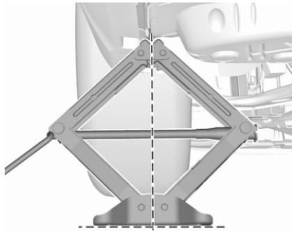
4. Regolare il martinetto all'altezza necessaria. Posizionarlo direttamente sotto il punto di sollevamento del veicolo in modo che non scivoli.
