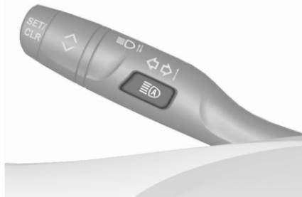
Attivare l'assistenza all'uso degli abbaglianti premendo . Il LED del pulsante si illumina se l'assistenza all'uso degli abbaglianti è attiva. Gli abbaglianti si attivano automaticamente ad una velocità superiore a 25 km/ora. Gli abbaglianti si spengono ad una velocità inferiore a 15 km/ora, ma l'assistente all'uso degli abbaglianti resta attivo.
