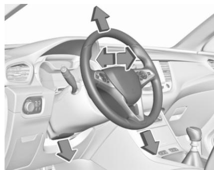
Sbloccare la leva, regolare la posizione del volante, quindi riportare la leva in posizione iniziale e accertarsi che sia completamente bloccata. Effettuare la regolazione del volante solo a veicolo fermo e bloccasterzo disinserito.
