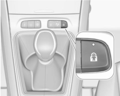
Sistema ad attivazione remota per impedire l'apertura delle portiere posteriori tramite le maniglie interne e l'utilizzo degli alzacristalli elettrici posteriori.
