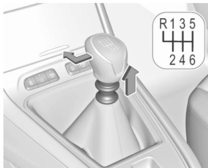
Per inserire la retromarcia con un cambio a 6 marce, premere il pedale della frizione, tirare l'anello situato sotto alla leva del cambio e portare quest'ultima completamente a sinistra e in avanti.
