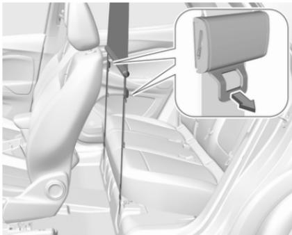
Tirare l'aletta del tenditore su entrambi i lati per liberare le fascette. Staccare i ganci dagli anelli. Sganciare le aste della rete di sicurezza dalle aperture di montaggio nel telaio del tetto.
