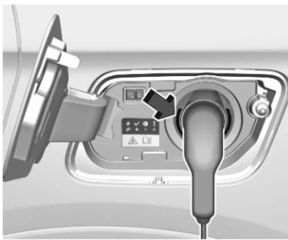
L'inizio della ricarica viene indicato dalla luce verde lampeggiante dell'indicatore di stato della presa di carica e nella scatola di comando del cavo di ricarica.
