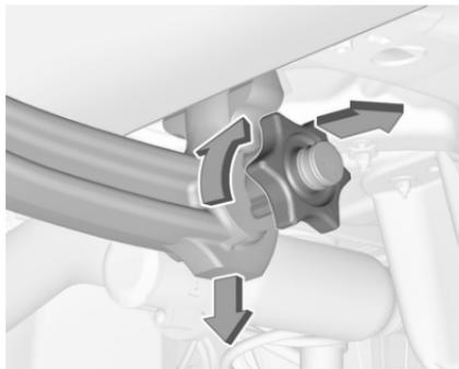
Aprire il coperchietto di protezione e ruotare la chiave in posizione per bloccare la barra.
