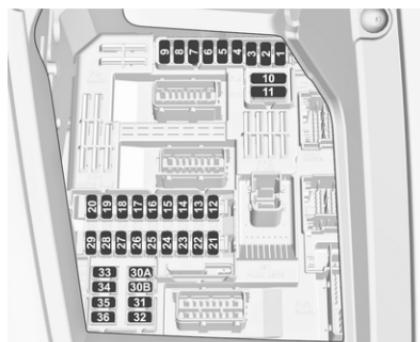
**N. Circuito****28** Modulo BTA**29** Infotainment**32** Accendisigari / presa di alimentazione anteriore**34** Lunotto termico riscaldato / Parabrezza riscaldato / Ricarica a induzione**35** Interruttore dei fari / Modulo del connettore diagnostico**36** Illuminazione
