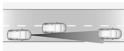
Se un altro veicolo entra nel percorso di guida, il cruise control adattivo considererà il veicolo solamente quando sarà totalmente sullo stesso percorso. È necessario essere pronti ad agire e premere il pedale del freno se è necessario frenare più velocemente.
