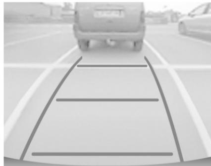
L'area dietro al veicolo viene mostrata sullo schermo. Le linee verticali corrispondono alla larghezza del veicolo con gli specchietti aperti. La direzione delle linee cambia a seconda della posizione del volante.
