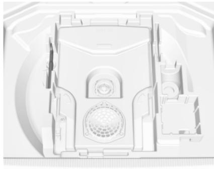
L'occhiello di traino e i cunei si trovano in una cassetta situata nel vano di carico sotto alla copertura del pianale.
