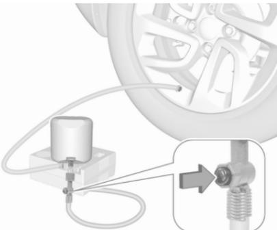
Scaricare la pressione in eccesso tramite il pulsante sul tubo dell'aria.
