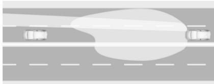
L'assistenza all'uso degli abbaglianti include una modalità speciale per autostrada. Quando si guida ad una velocità superiore a 115 km/ora in autostrada, il fascio di luce si rimpicciolisce per evitare di abbagliare i veicoli provenienti in senso opposto. Quando si seguono o si superano dei veicoli, l'abbagliamento nei loro confronti è ridotto.
