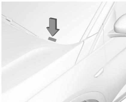
Il numero di telaio potrebbe essere stampato in rilievo sul cruscotto, visibile attraverso il parabrezza, o nel vano motore sul pannello carrozzeria di destra.
