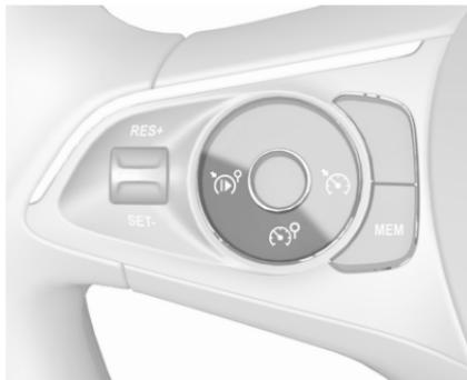
Premere  $\text{↑}$  per attivare il limitatore di velocità.
