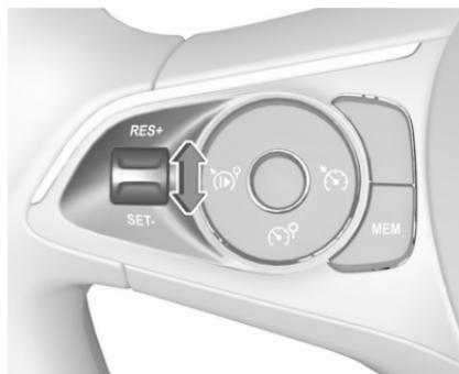
Accelerare fino alla velocità desiderata e spostare brevemente l'interruttore rotante verso **SET/-** una volta sola. La velocità corrente viene memorizzata e mantenuta. Il pedale dell'acceleratore può essere rilasciato.
