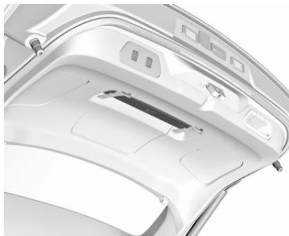
Riporre il triangolo d'emergenza nell'apposito spazio nel portello posteriore e fissarlo con il nastro in Velcro®.
