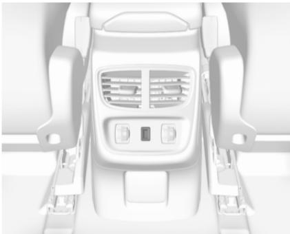
Nella consolle posteriore potrebbe trovarsi una porta USB aggiuntiva. Le porte USB possono essere utilizzate per ricaricare dispositivi esterni e per stabilire una connessione dati con il sistema di Infotainment. Per ulteriori informazioni, consultare il manuale Infotainment.
