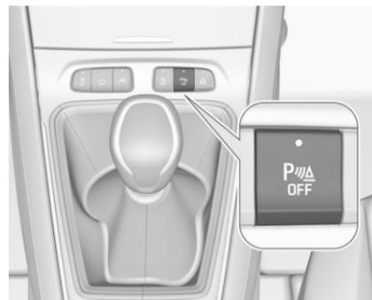
Il sistema è pronto ad entrare in funzione quando il LED del pulsante del sistema di ausilio al parcheggio **P<sub>RA</sub> OFF** non si accende.
