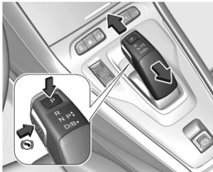
**P** : posizione di parcheggio, le ruote anteriori sono bloccate, innestare solo a veicolo fermo e con il freno di stazionamento azionato
