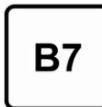
Carburante diesel conforme alla norma EN590 mescolato con un biocombustibile conforme alla norma EN14214 (possibilmente con una percentuale di estere metilico di acidi grassi superiore al 7%).
