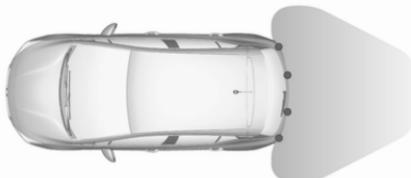
Il sistema è dotato di sensori di parcheggio ad ultrasuoni ubicati nel paraurti posteriore.
