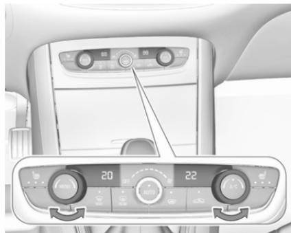
Impostare le temperature preselezionate separatamente per il lato guida e il lato passeggero anteriore sul valore desiderato mediante l'anello destro e sinistro. L'anello sul lato passeggero varia la temperatura di quel lato. L'anello sul lato del conducente cambia la temperatura di quel lato o di entrambi i lati a seconda dell'attivazione della sincronizzazione **MONO** nel menu di impostazioni del clima. Premere **MENU** per accedere al menu.
