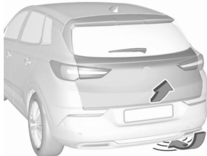
Per aprire o chiudere il portellone posteriore, muovere avanti e indietro il piede sotto il paraurti posteriore nell'area sotto alla targa. Non mantenere il piede in tale posizione troppo a lungo o non muoverlo troppo lentamente sotto il paraurti. La chiave elettronica deve trovarsi all'esterno del veicolo, in un raggio d'azione di ca 1 m dal portellone posteriore.
