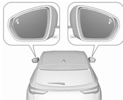
Se il sistema rileva un veicolo nell'angolo morto laterale durante la marcia in avanti, un LED si accende nel rispettivo specchietto.
