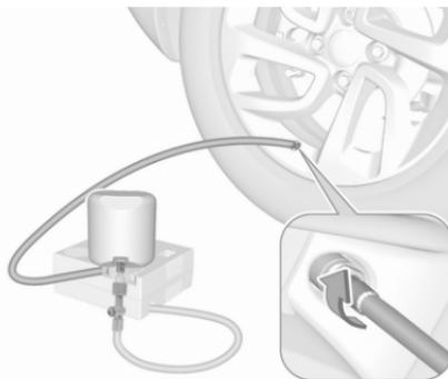
7. Avvitare il flessibile del sigillante sulla valvola del pneumatico.
