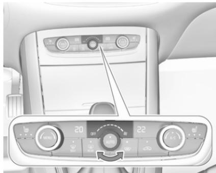
Regolare il flusso dell'aria ruotando l'anello sulla velocità desiderata.
