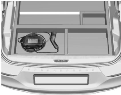
3. Aprire il portellone posteriore. Sollevare la copertura del vano portaoggetti del pianale posteriore e rimuovere il cavo di carica.
