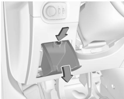
Nei veicoli con guida a sinistra, la scatola portafusibili si trova dietro un pannello del quadro strumenti, sul lato sinistro. Aprire la copertura e rimuoverla premendo il dispositivo di blocco.
