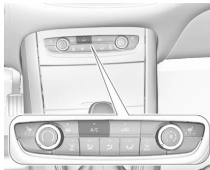
Premere **A/C** per inserire il raffreddamento. Il LED del pulsante si illumina per indicare l'attivazione. Il raffreddamento funziona solamente con il motore acceso e la ventola inserita.
