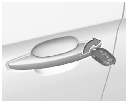
Bloccare manualmente la portiera del conducente inserendo e ruotando la chiave nella serratura.
