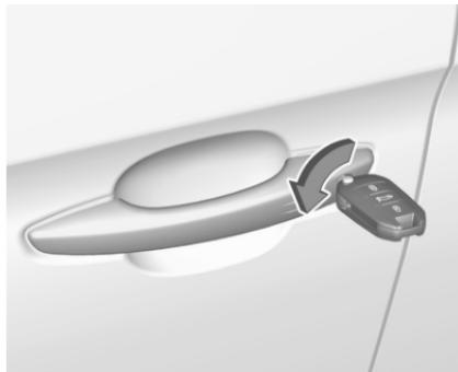
Sbloccare manualmente la portiera del conducente inserendo e ruotando la chiave nella serratura.
