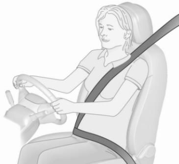
Le cinture di sicurezza sono bloccate durante le accelerazioni e decelerazioni brusche del veicolo, per mantenere gli occupanti dell'auto in posizione corretta. Pertanto il rischio di lesioni si riduce notevolmente.
