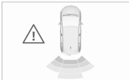
Inoltre, il Visualizzatore Info 109 visualizza la distanza dagli ostacoli posteriori modificando le linee di distanza. Quando l'ostacolo è molto ravvicinato, il simbolo di pericolo viene visualizzato.
