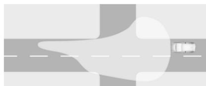
Attivata automaticamente ad una velocità superiore a 55 km/ora e in situazioni con illuminazione ambientale esterna. La luce è ampia e simmetrica. Se si viaggia ad una velocità inferiore a 30 km/h, i fari vengono ruotati leggermente verso l'esterno per permettere al conducente di individuare più rapidamente pedoni e oggetti al lato della strada. Una conformazione speciale del fascio luminoso è stata ideata per evitare l'abbagliamento di altri utenti della strada.
