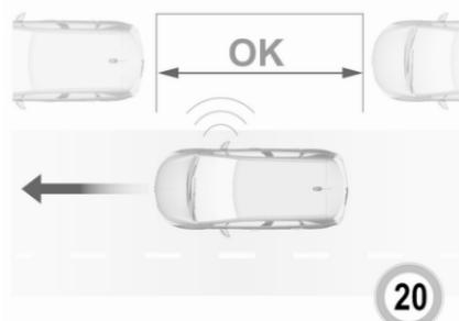
Al rilevamento di uno spazio libero, il sistema emette una segnalazione visiva nel Visualizzatore Info e un primo segnale acustico. Avanzare lentamente. Al secondo segnale acustico, arrestare il veicolo, inserire la retromarcia, lasciare il volante e
