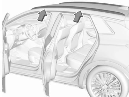
Fissare il portapacchi sopra ai punti di montaggio dei mancorrenti sul tetto, situati su ciascun telaio della portiera della carrozzeria.
