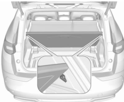
Per fissare la copertura del vano di carico in posizione verticale, sollevarla oltre i fermi retrattili.
