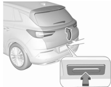
Per aprire il portellone posteriore, tenere premuto il pulsante finché il portellone non si muove. Se il veicolo è bloccato, la chiave elettronica deve trovarsi all'esterno del veicolo, in un raggio d'azione di ca 1 m dal portellone posteriore.
