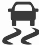
Il sistema ESC e il sistema di controllo della trazione sono operativi dopo ogni avvio del motore appena la spia si spegne.
