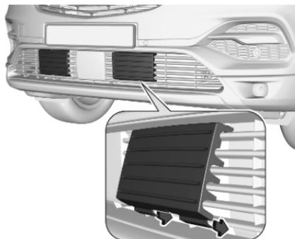
2. Premere la parte inferiore del coperchio di protezione contro la barra della griglia. Assicurarsi che la copertura di protezione sia fissata saldamente.
