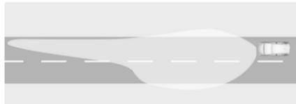
Attivata automaticamente ad una velocità compresa tra 55 km/h e 115 km/h quando si guida in zone rurali. L'illuminazione della carreggiata che si sta percorrendo e del bordo stradale sono migliorate. I veicoli che precedono e provenienti in senso opposto alla direzione di marcia non vengono abbagliati.
