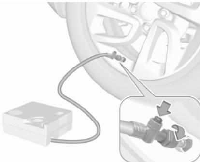
16. Proseguire immediatamente la guida, in modo da distribuire uniformemente il sigillante nel pneumatico. Dopo aver percorso circa 5 km ma non oltre 10 minuti di viaggio, fermarsi e controllare la pressione dei pneumatici. Nel fare questo, avvitare direttamente il tubo dell'aria sulla valvola dello pneumatico. Gonfiare lo pneumatico come indicato in precedenza. Scaricare la pressione in eccesso tramite il pulsante sul tubo dell'aria.
