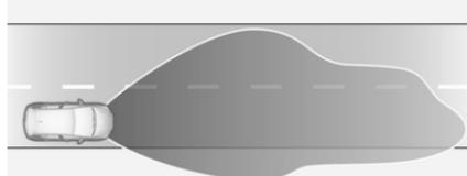
Si attiva automaticamente ad una velocità superiore a 115 km/h. L'illuminazione si adatta alla maggiore velocità a cui si viaggia in autostrada.
