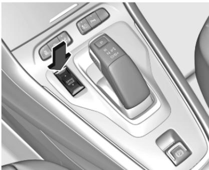
La modalità di trazione integrale può essere attivata utilizzando l'interruttore della modalità di guida. L'attivazione viene visualizzata nel Driver Information Center e sul Visualizzatore Info.
