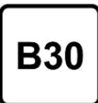
Con il motore diesel del proprio veicolo è consentito l'utilizzo di carburante B20 o B30 conforme alla norma
