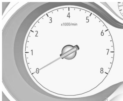
Indica la velocità di rotazione del motore.
