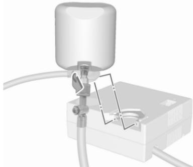
4. Avvitare i flessibili dell'aria del compressore sul raccordo della bombola del sigillante.
