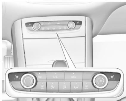
Regolare il riscaldamento sul livello desiderato premendo del relativo sedile una o più volte. La spia nel pulsante indica la regolazione selezionata.
