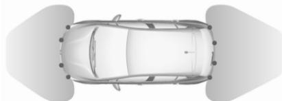
Il sistema è dotato di sensori di parcheggio ad ultrasuoni ubicati nel paraurti posteriore e in quello anteriore.
