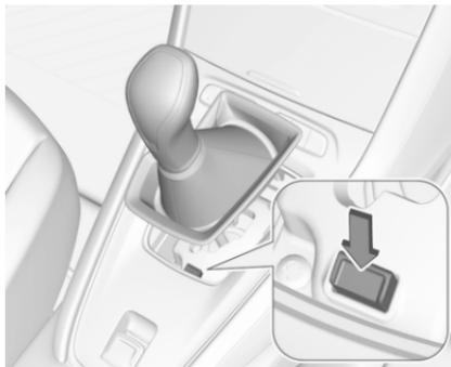
3. Spingere in basso il pulsante e far uscire la leva del cambio da P. Rivolgersi ad un'officina per eliminare la causa dell'interruzione dell'alimentazione elettrica.
