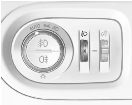
Per regolare la profondità delle luci in base al carico del veicolo e non abbagliare i conducenti dei veicoli in avvicinamento, ruotare l'interruttore rotante nella posizione desiderata.
