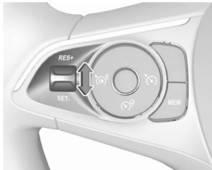
Accelerare fino alla velocità desiderata e spostare brevemente l'interruttore rotante verso **SET/-** una volta sola. La velocità attuale è memorizzata come velocità massima.
