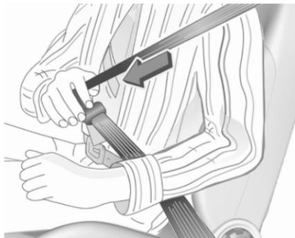
Estrarre la cintura di sicurezza dal riavvolgitore, farla passare sul corpo, accertando che non sia attorcigliata, e inserire la linguetta di chiusura nella fibbia bloccandola in posizione. Accertarsi che la cintura poggi sulla spalla e aderisca perfettamente al corpo durante la guida.
