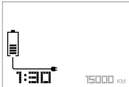
Il tempo di ricarica residuo viene visualizzato nel Driver Information Center. Quando la procedura di carica è completata **0:00** verrà visualizzato nel Driver Information Center o il Driver Information Center si spegnerà.
