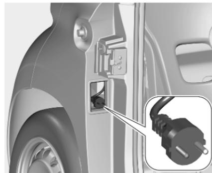
Il cavo di carica è sempre collegato al veicolo. È stivato all'interno del telaio della portiera di destra.
