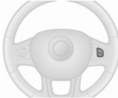
Premere **O**; il controllo automatico della velocità di crociera è disattivato e la spia verde
