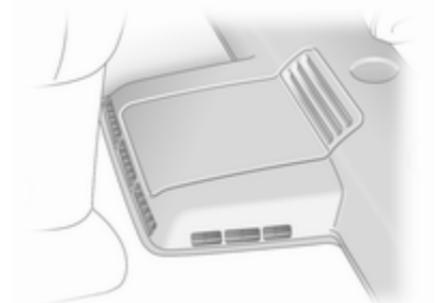
La ventola di riscaldamento posteriore fornisce aria alla zona posteriore dell'abitacolo tramite le bocchette posteriori.
