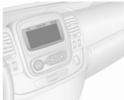
Nei veicoli con sistema di navigazione, il display della videocamera posteriore potrebbe essere mostrato sullo schermo del display del sistema Infotainment (a seconda della versione).
