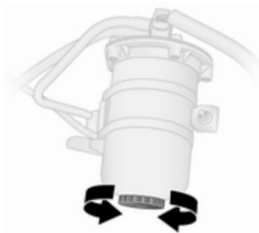
Eliminare l'acqua dal filtro ad ogni sostituzione dell'olio motore.
