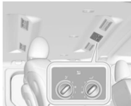
La ventola di climatizzazione posteriore fornisce aria alla zona posteriore dell'abitacolo tramite le bocchette posteriori. La quantità di aria immessa è determinata dalla ventola.
