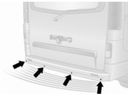
Il sistema è costituito da quattro sensori di parcheggio ad ultrasuoni ubicati nel paraurti posteriore.
