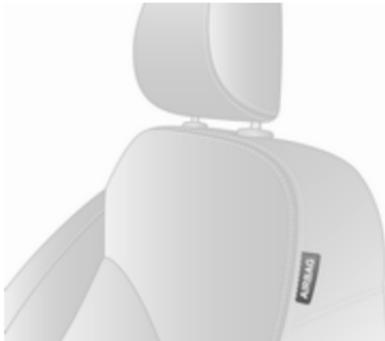
Il sistema airbag laterale è composto da un airbag nello schienale di ciascun sedile anteriore. La loro presenza potrebbe essere segnalata dalla scritta **AIRBAG**.
