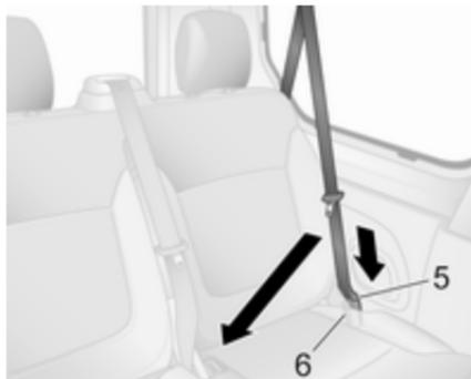
Prima di allacciare la cintura di sicurezza del sedile esterno posteriore, assicurarsi che la linguetta inferiore **5** sia completamente allacciata alla relativa fibbia **6**.
