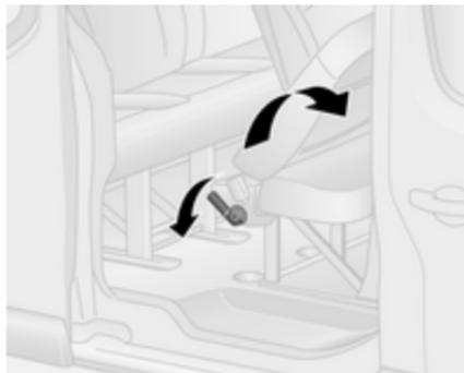
Per agevolare l'accesso ai sedili della 3ª fila (ove siano presenti), aprire la portiera laterale scorrevole e abbassare la leva di sblocco del sedile ribaltabile di accesso della 2ª fila e piegare lo schienale del sedile in avanti. Se necessario, slacciare le cinture di sicurezza dalle relative fibbie.
