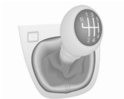
Per inserire la retromarcia, premere il pedale della frizione a veicolo fermo, sollevare il collare sulla leva del cambio e inserire la marcia in senso contrario alla resistenza.
