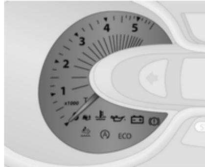
Indica la velocità di rotazione del motore.
