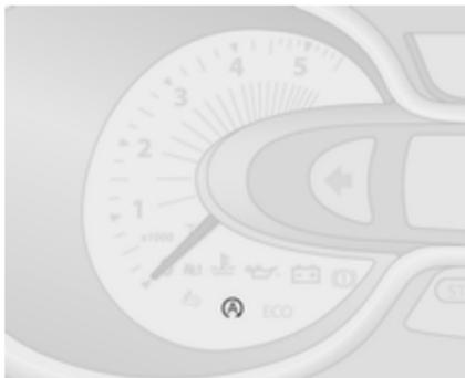
**(A)** si accende in nel quadro strumenti per segnalare un Autostop ↗ 106.
