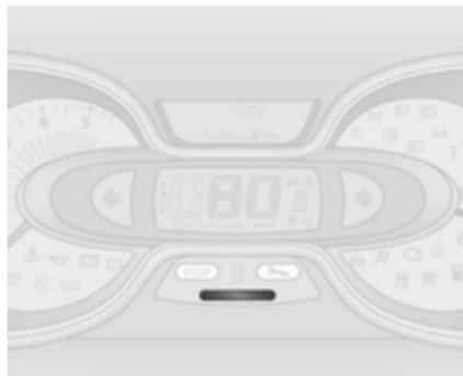
A seconda della versione, l'indicatore del risparmio carburante (o "spia dello stile di guida") fornisce il calcolo istantaneo dell'efficienza del carburante, in base allo stile di guida corrente).
