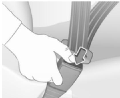
Per slacciare la cintura, premere il pulsante rosso sulla fibbia della cintura. La cintura di sicurezza si riavvolge automaticamente.
