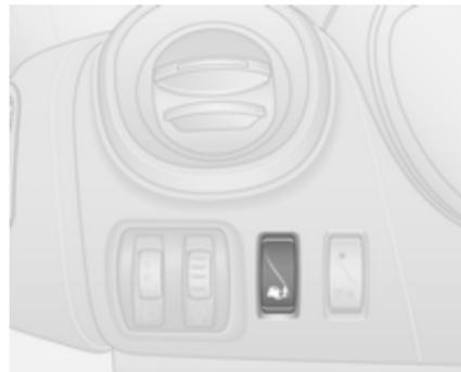
Se necessario, in caso di terreno molle, fango o neve su strada, è possibile disattivare il sistema ESP®Plus per potenziare la trazione: Premere
