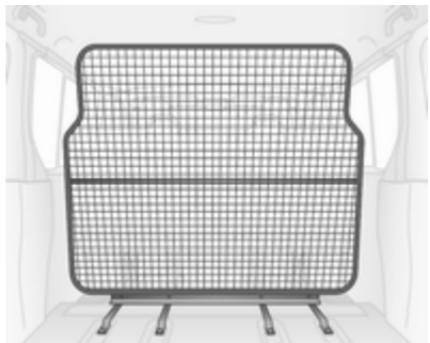
I veicoli Combi possono essere dotati di una grata di contenimento dietro la seconda fila di sedili.
