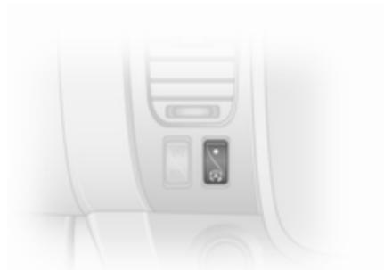
Disattivare manualmente il sistema stop-start premendo
