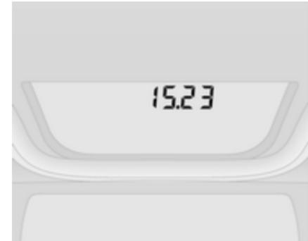
Visualizzare la funzione di regolazione dell'orologio premendo ripetutamente il tasto sull'estremità della leva del tergicristalli.
