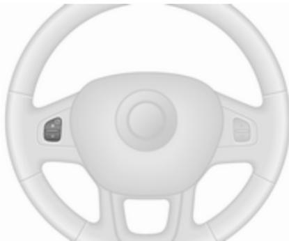
Accelerare fino alla velocità desiderata e premere **+** o **-**. La velocità attuale viene memorizzata e mantenuta; il pedale dell'acceleratore può essere rilasciato.
