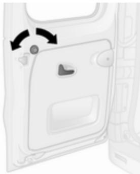
Girare l'interruttore di bloccaggio in senso orario per bloccare la portiera posteriore sinistra dall'interno del vano di carico. Per disinserire il blocco, ruotare l'interruttore in senso antiorario.
