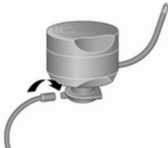
3. Avvitare il flessibile dell'aria al connettore del flacone di sigillante.
