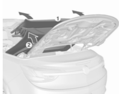
12. Ištraukite medžiaginę stogą, pakeldami priekinį lanką (1) ir tuo pat metu – abiejose pusėse – įtempimo lanką (2).
