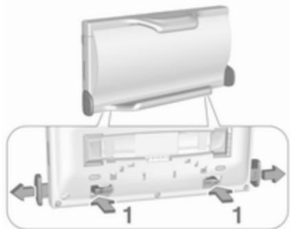
1. Trykk inn begge brakettene (1) på baksiden for å løsne holderne for breddejustering, og trekk dem ut.
