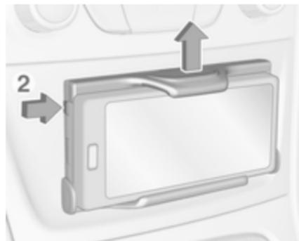
2. Trykk inn knappen (2) øverst på venstre side for å løsne holderen for høydejustering.
