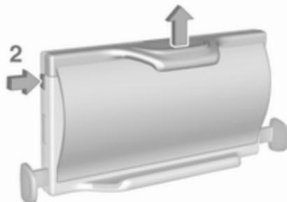
2. Trykk inn knappen (2) øverst på venstre side for å løsne holderen for høydejustering.
