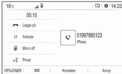
Berør **Micro off** for å slå av infotainmentsystemets mikrofon.
