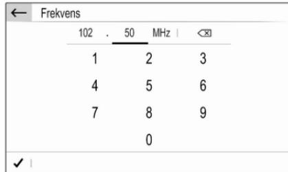
Tastaturer for inntasting av tall kan bestå av flere inntastingsfelt. I det illustrerte eksempelet må du først berøre inntastingsfeltet bak desimalpunktet før du kan angi desimaltallene.
