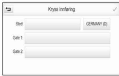
Berør et av inntastingsfeltene ved siden av deladressene. Et tastatur vises.
