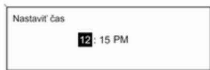
Otočením multifunkčným gombíkom zmeňte aktuálnu hodnotu nastavenia.
