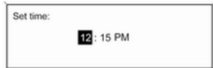
Otočením multifunkčným gombíkom zmeňte aktuálnu hodnotu nastavenia. Stlačením multifunkčného gombíka potvrdte nastavenú hodnotu.
