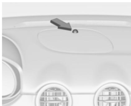
Varnostni LED indikator je integriran v senzor na armaturni plošči.
