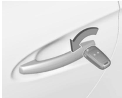
Odkenlite voznikova vrata z obratom ključa v ključavnici. Vključite kontakt in pritisnite stikalo ☱ za odklepanje sovoznikovih vrat, prtljažnika in lopute rezervoarja goriva.
