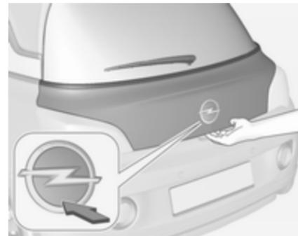
Za odklepanje in odpiranje vrat prtljažnika pritisnite na spodnjo polovico avtomobilske značke.
