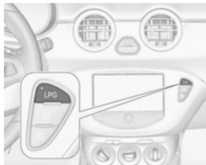
Pritisnite **LPG** za preklapljanje med pogonom na bencin in pogonom na utekočinjen naftni plin. Trenutni način delovanja označuje LED dioda v tipki.
