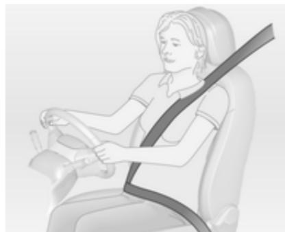
Izvlecite varnostni pas in ga zataknite v zaklep. Bočni del pasu ne sme biti zvit na nobenem delu in se mora tesno prilegati k telesu. Naslonjalo naj ne bo nagnjeno preveč nazaj (priporočen kot nagiba: največ 25°).
