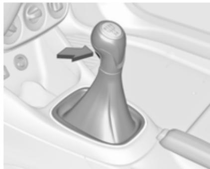
Vzvratna prestava: ko vozilo miruje, pritisnite pedal sklopke, nato pritisnite gumb na prestavnici ročici in prestavite.
