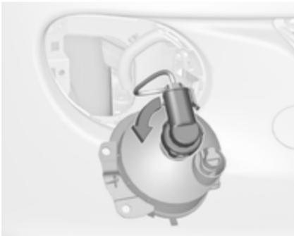
4. Sprostite držalo žarnice in ga snemite z vrtenjem na levo.
