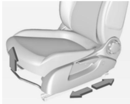
Potegnite ročico, pomaknite sedež, sprostite ročico. Sedež poskušajte pomakniti naprej in nazaj, da preverite, ali je pritrjen v ustrezem položaju.
