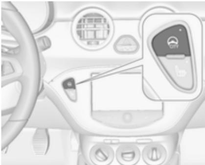
Medtem ko teče motor, pritisnite . Sistem deluje od mirovanja do hitrosti 35 km/h in v vzvratni prestavi. Po prekoračitvi te hitrosti sistem preklopi v normalni način. Če je mestni način vključen, se samodejno vklopi pri hitrosti pod 35 km/h.
