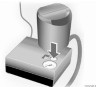
Če predpisani tlak ni dosežen v roku desetih minut, odstranite komplet za popravilo pnevmatik. Premaknite vozilo za en obrat kolesa. Ponovno priklopite komplet za popravilo pnevmatik in nadaljujte s postopkom polnjenja pnevmatike še dodatnih deset
