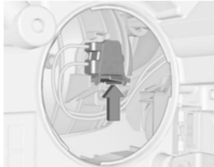
2. Pritisnite zaponko, da se sprosti držalo žarne. Izvlecite nosilec z žarne iz žarometa.
