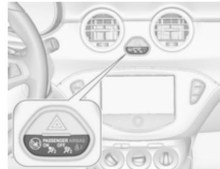
Če kontrolna lučka  $\text{A}_2$  po vključitvi kontakta vžiga sveti pribl. 60 sekund, je sistem varnostnih blazin na sovoznikovi strani aktiven in se bo v primeru trka sprožil.
