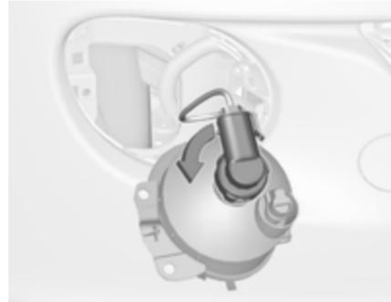
3. Sprostite držalo žarnice in ga snemite z vrtenjem na levo.
