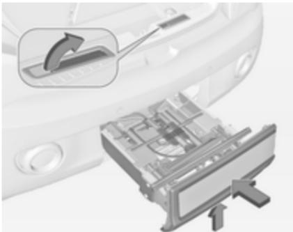
Potisnite zaklepni vzvod navzgor in zadržite. Sistem rahlo dvignite in ga potisnite v odbijač, da se zaskoči.
