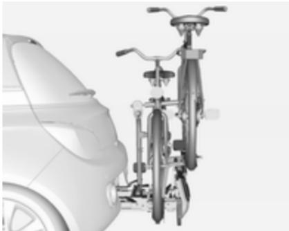
Zadnji nosilec (Flex-Fix sistem) omogoča nameščanje enega kolesa na raztegljiv nosilec, ki je integriran v dnu vozila. Adapter omogoča pritrditev dodatnega kolesa. Prevoz drugih stvari ni priporočljiv.
