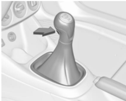
Za vklop vzvratne prestave pritisnite pedal sklopke, pritisnite sprostilni gumb na izbirni ročici in prestavite.
