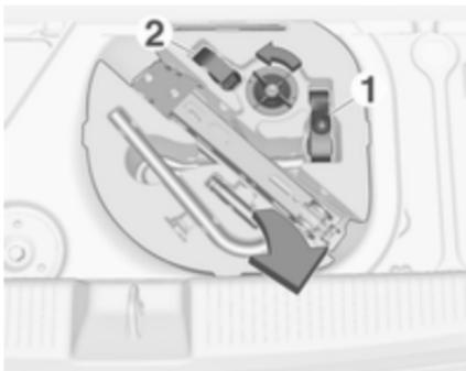
2. Odvijte krilno matico in odstranite škatlo z orodjem.
