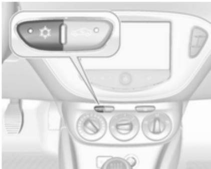
Za vklop hlajenja pritisnite ☀. Vklop signalizira LED indikator v stikalu. Hlajenje deluje samo, kadar teče motor in je vključen ventilator sistema za ogrevanje, prezračevanje, hlajenje.
