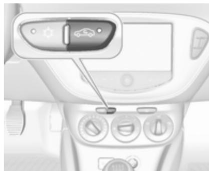
Za vklop kroženja zraka pritisnite ☁. Vklop signalizira LED indikator v stikalu.
