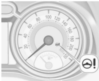
V primeru napake v sistemu zasveti in na voznikovem informacijskem zaslonu se pojavi sporočilo.
