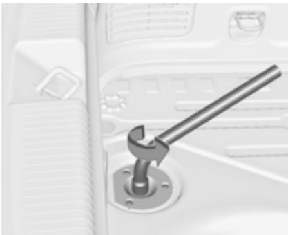
3. Namestite ključ za kolesa na vijak s šestrobno glavo zraven kompleta orodja in ga obrnite v levo, dokler ne občutite upora.
