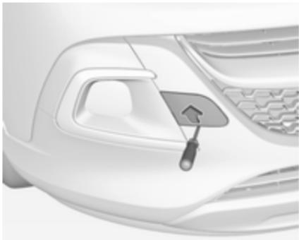
1. Sprostite mali pokrov z izvijačem v označenem položaju.
