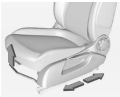
Potegnite ročico, pomaknite sedež, sprostite ročico. Sedež poskušajte pomakniti naprej in nazaj, da preverite, ali je pritrjen v ustrezнем položaju.
