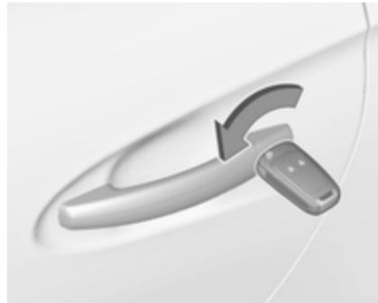
Odkenite voznikova vrata z obratom ključa v ključavnici. Vključite kontakt in pritisnite stikalo ☱ za odklepanje sovoznikovih vrat, prtljažnika in lopute rezervoarja goriva.
