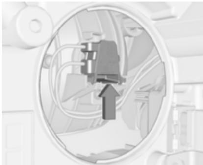
2. Pritisnite zaponko, da se sprosti držalo žarneice. Izvlecite nosilec z žarneico iz žarometa.
