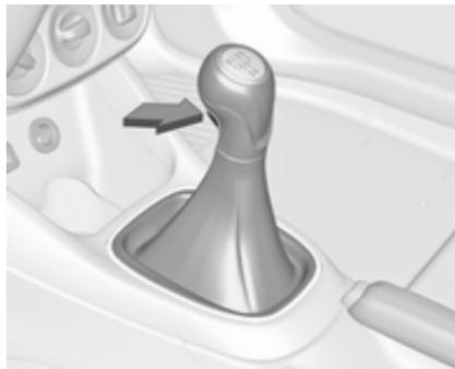
Vzvratna prestava: ko vozilo miruje, pritisnite pedal sklopke, nato pritisnite gumb na prestavnih ročicah in prestavite.
