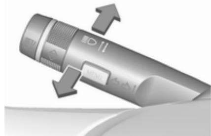
Preklop s kratkih na dolge luči: stikalno ročico potisnite naprej.
