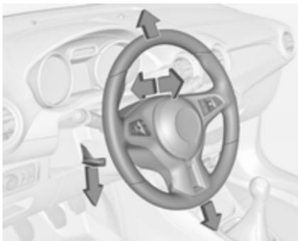
Sprostite ročico, nastavite volan, zataknite ročico v zavarovan položaj. Volana ne nastavljamte pri premikajočem vozilu in/ali blokiranem volanu.
