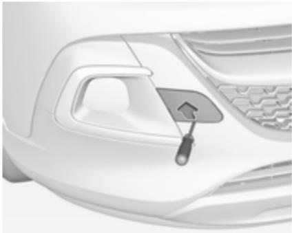
1. Okoli konice ploskega izvijača ovijte krpo, da preprečite poškodbo laka. Sprostite mali pokrov z izvijačem v označenem položaju.
