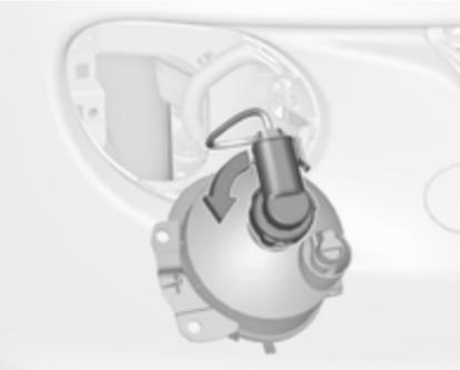
3. Sprostite držalo žarnice in ga snemite z vrtenjem na levo.
