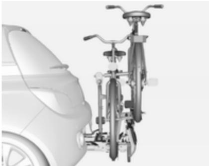
Zadnji nosilec (Flex-Fix sistem) omogoča nameščanje enega kolesa na raztegljivi nosilec, ki je vgrajen v dno vozila. Adapter omogoča pritrditev dodatnega kolesa. Prevoz drugih stvari ni priporočljiv.
