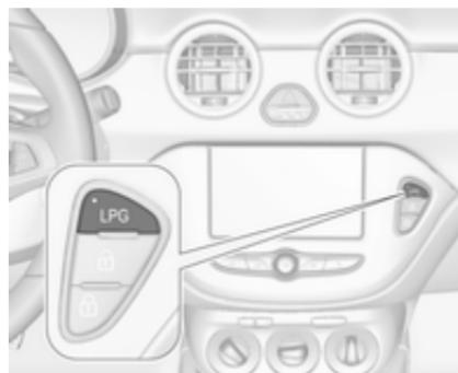
Po pritisku **LPG** se preklop med bencinskim in plinskim pogonom izvrši, takoj ko so izpolnjeni zahtevani pogoji (temperatura hladilne tekočine, temperatura plina in minimalno število vrtljajev motorja). Ti pogoji so običajno izpolnjeni po približno 60 sekundah (odvisno od
