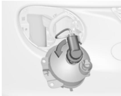
4. Sprostite držalo žarnice in ga snemite z vrtenjem na levo.
