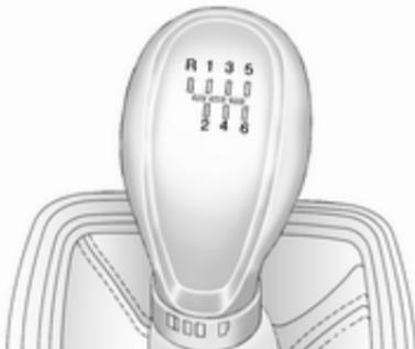
Vzvratna prestava: ko vozilo miruje, pritisnite pedal sklopke, tako počakajte 3 sekunde in prestavite.
