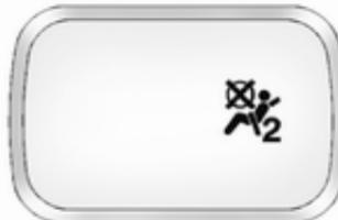
Kontrolne lučke za sistem sovoznikovih varnostnih blazin so na sovoznikovi strani armaturne plošče.
