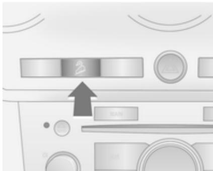
Pri hitrosti pod približno 50 km/h pritisnite tipko . Zelena kontrolna lučka v instrumentni plošči utripa v opozorilo, da je sistem DCS aktivен. DCS se ne vklopi pri hitrosti nad 50 km/h, tudi če pritisnete tipko.
