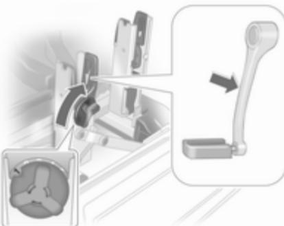
V primeru koles z izbočenimi ojnicami pedal obrnite vložek za pedal navznoter (položaj 1).
