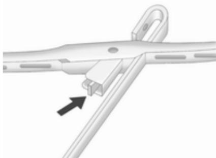
Dvignite ročico brisalca, pritisnite in držite zaskočko ter odstranite metlico brisalca.
