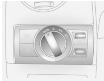
Če je vključen samodejni vklop luči med delovanjem motorja, se kratke luči samodejno vključijo v odvisnosti od zunanjih svetlobnih pogojev.
