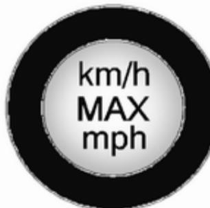
10. Priložena nalepka na posodi prikazuje maksimalno dovoljeno hitrost, s katero se sme vozilo po popravljeni pnevmatiki premikati. Nalepko nalepite v voznikovo vidno polje.
