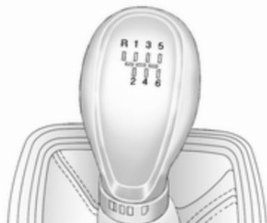
Vzvratna prestava: ko vozilo miruje, pritisnite pedal sklopke, tako počakajte 3 sekunde in prestavite.
