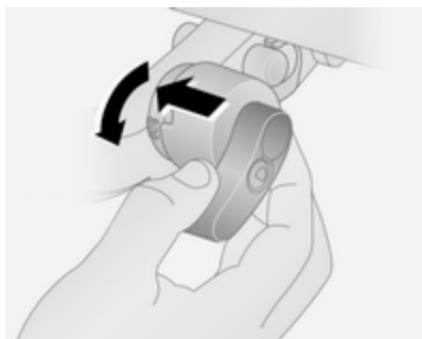
Odklenite vlečno kljuko in izvlecite ključ. Potisnite ročico na levo proti vlečni kljuki in jo obrnite navzdol. Izvlecite vlečno kljuko iz priklopnega ohišja.
