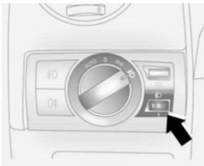
Pri vključenih kratkih lučeh nastavite višino žarometov glede na obremenitev vozila. Pravilna nastavitevi višine žarometov zmanjša slepljenje drugih udeležencev v prometu.
