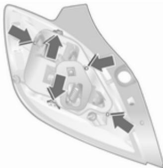
5. Z izvijačem odvijte tri vijake. Pritisnite pritrilne sponke ob straneh nosilca žarnic navznoter in nosilec z žarnicami odstranite.
