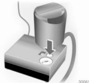
13. Predpisana vrednost tlaka mora biti dosežena v 10-ih minutah. Tlak v pnevmatikah  $\varnothing$  243. Ko je ustrezna vrednost tlaka dosežena, kompresor izklopite. Če predpisan tlak ni dosežen v roku 10-ih minut, odstranite komplet za popravilo pnevmatik. Premaknite vozilo za en obrat kolesa. Ponovno priklopite komplet za popravilo pnevmatik in nadaljujte s postopkom polnjenja
