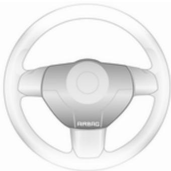
Varnostna meha s pirotehničnim polnilcem se nahajata v volanu in v armaturni plošči na desni strani. Označena sta z napisom **AIRBAG**.
