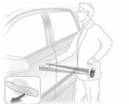
Če imate elektronski oddajnik pri sebi, odklenete vozilo in odprete vrata s preprostim potegom kljuke na vratih. Za odpiranje vrat prtljažnika pritisnite gumb pod prijemkom.
