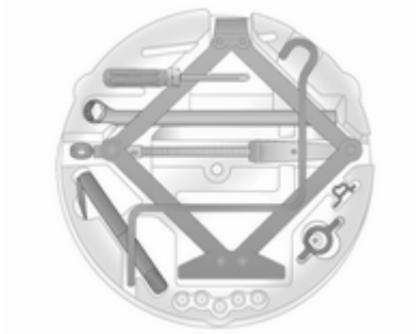
Dvigalka in orodja so spravljeni v prtlačniku v prostoru pod rezervnim kolesom. Rezervno kolo ↪ 202
