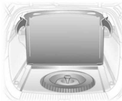
Odstranite vmesne elemente in kljukice iz vodil na stranskih stenah prtljažnika. Privzdignite pritrdilna ušesca na zadnjem delu talne obloge, talno oblogo nato dvignite v navpični položaj, da jo zadrži zgornji okvir vrat prtljažnika. Pri nameščanju talne obloge vstavite pritrdilna ušesca v (skozi) reže v talni oblogi. Vozila s tovorno škatlo: odstranitev ⇨ 74.
