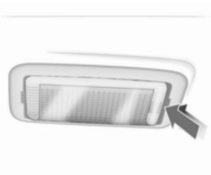
1. Luč iztaknite z izvijačem.
