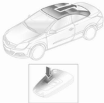
Pri mirujočem vozilu odklenite vozilo. Tipko
