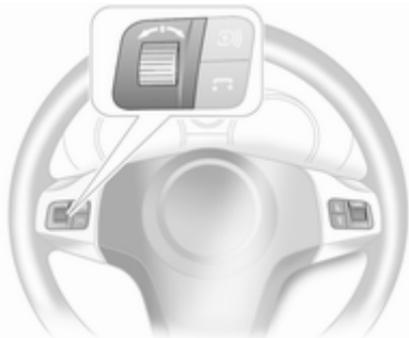
Pritisk na narebričeno kolesce priključuje meni potovalnega računalnika **BC**. V meniju **BC** služi za rokovanje s stoparico in za ponastavitev meritve ali izračunavanja.
