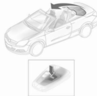
Pri mirujočem vozilu zaklenite vozilo. Tipko
