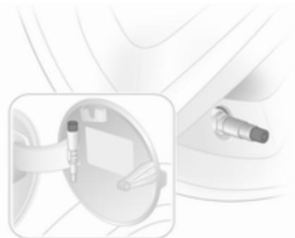
Pri vozilih s sistemom nadziranja tlaka v pnevmatikah je v ključu za pokrovček adapter.
