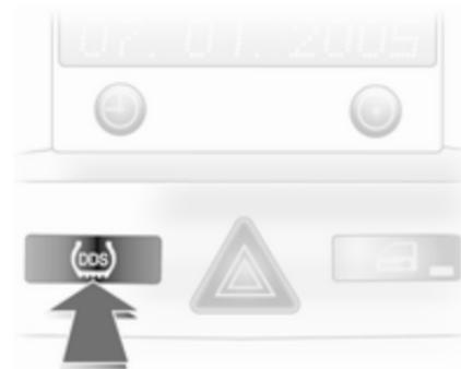
Po zamenjavi kolesa/pnevmatike morate sistem ponastaviti: Napolnite pnevmatike na predpisan tlak, vključite kontakt, tipko **DDS** pridržite pritisnjeno približno 4 sekunde; kontrolna lučka (⚠) utripne trikrat.
