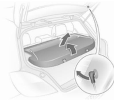
Iztaknite nosilni vrvice z vrat prtljažnika. Prekrivalo izvlecite iz stranskih vodil.
