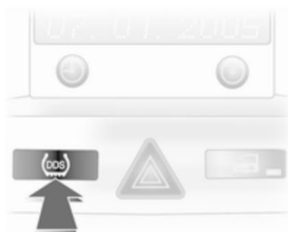
Po popravku tlaka v pnevmatikah ali po zamenjavi kolesa/pnevmatike morate sistem ponastaviti: Vključite kontakt, tipko **DDS** pridržite pritisnjeno približno 4 sekunde; kontrolna lučka (⚠) utripne trikrat.
