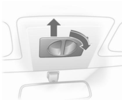
Odstiranje stropne obloge: Obrnite ročico v desno in pomaknite stropno oblogo nazaj v zeleni položaj.
