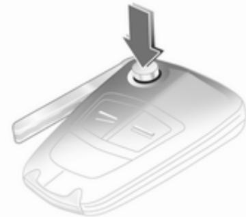
Za izskok ključeve brade pritisnite gumb. Za preklon ključeve brade pritisnite isti gumb.
