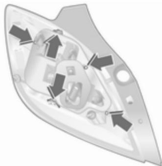
5. S pritrdilnega vijaka snemite tesnilo. Pritisnite pritrdilne sponke ob straneh nosilca žarnic ob straneh nosilca žarnic navzven in nosilec z žarnicami odstranite.
