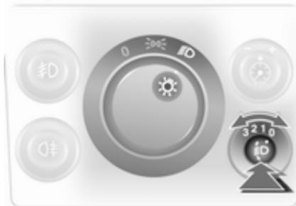
Za prilagoditev višine svetlobnega snopa, da ne slepite ostalih udeležencev v prometu: Pritisnite gumb, da izskoči in ga obrnite v željeni položaj.
