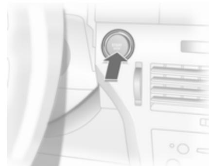
Pritisnite gumb **Start/Stop**. Kontakt je vključen. Istočasno se deaktivira elektronska blokada zagona motorja in elektro-mehanski zaklep volana.
