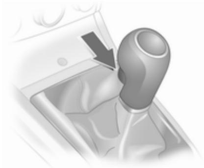
Vzratna prestava: ko vozilo miruje, pritisnite pedal sklopke, tako počakajte 3 sekunde, potegnite vzvod (gumb) navzgor in prestavite.
