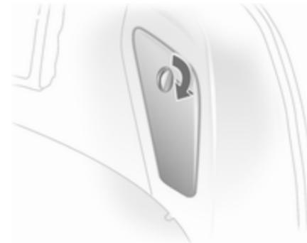
1. Pri zamenjavi žarnice na desni strani: s kovancem obrnite zaklep pokrova in pokrov preklonite navzdol.
