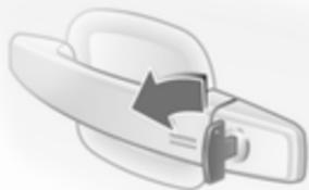
Z zasilnim ključem lahko odklepete/zaklepete le voznikova vrata. Odklepanje celotnega vozila ⇨ 24. V primeru vozila z alarmno napravo se utegne pri odklepanju sprožiti alarm. Izklopite alarm z vključitvijo kontakta.
