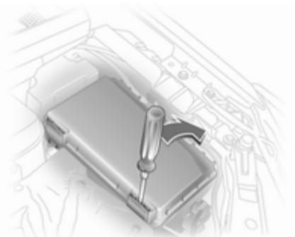
Vstavite izvijač v odprtino do konca in ga potisnite v stran. Pokrov dvignite navzgor in odstranite.
