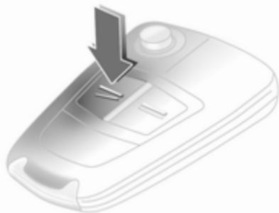
Pri centralno zaklenjenem vozilu pokrova prtljažnika ni možno odkleniti prek tipke
