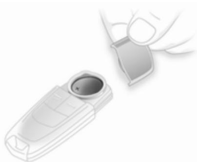
Za zamenjavo baterije pritisnite zaklepni mehanizem na spodnji strani oddajnika in snemite pokrov z rahlim pritiskom na pokrov. Pritisnite pokrov na drugi strani navzven.
