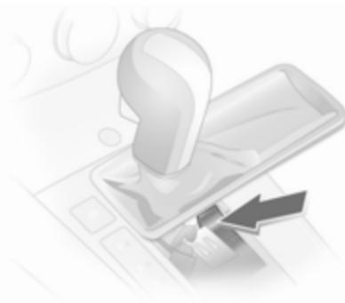
3. Z izvijačem potisnite rumeni zaklopec naprej in pretaknite izbirno ročico iz položaja **P**.
