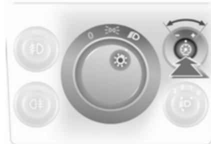
Nastavitev jakosti osvetlitve je mogoča pri prižganih zunanjih lučeh vozila. Pritisnite stikalo ☀️, da izskoči iz ohišja, nato ga rahlo obrnite v levo ali desno in pridržite, dokler ni nastavljena zelena jakost.
