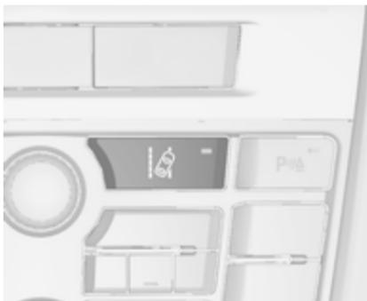
Sistem za opozorilo o nenamerni menjavi voznega pasu se aktivira s pritiskom gumba . LED v stikalnu označuje, da je sistem vključen. Kadar kontrolna lučka na instrumentni tabli sveti zeleno, je sistem pripravljen na delovanje.
