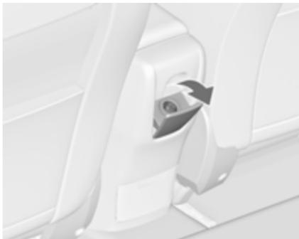
Dodatna 12-voltarna električna vtičnica se nahaja v zadnji konzoli. Pokrov preklopite navzdol.
