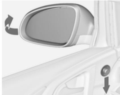
Obrnite stikalo v **0**, nato pritisnite stikalo navzdol. Obe zunanjti ogledali se preklopita.
