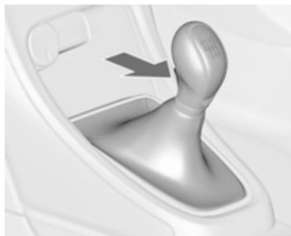
Vzvratno prestavo vklopite, ko vozilo miruje: pritisnite pedal sklopke, pritisnite gumb na prestavnici ročici in prestavite.
