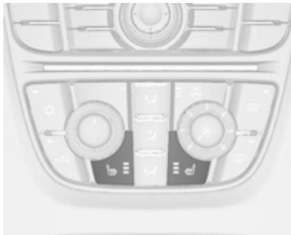
Nastavite želeno stopnjo ogrevanja s pritiskom ustreznega stikala enkrat ali večkrat pri vključenem kontaktu. Indikator v stiku označuje nastavitev.
