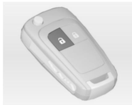
V ta namen pritisnite pri izključenem kontaktu tipko ④. Vrata prtljažnika se odklenejo in jih lahko odprete z dotikom tipke pod prijemkom na vratih.
