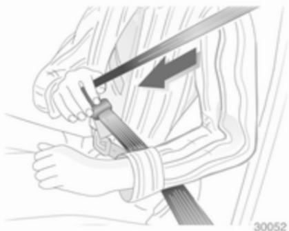
Enakomerno potegnite pas iz navijalca, ga nezvitega namestite čez telo in vstavite zaponko v zaklep, da se slišno zaskoči. Med vožnjo si pas na diagonalnem delu večkrat zategnite. Opozoril za pripenjanje varnostnega pasu  $\diamond$  92.
