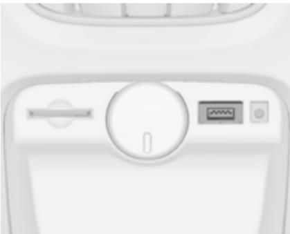
V sredinski konzoli je USB vtičnica za priklop zunanjih avdio podatkovnih naprav.
