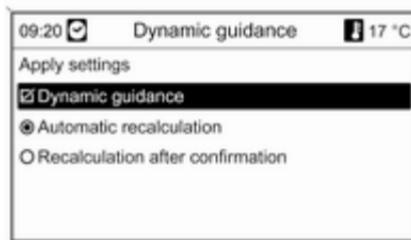
Izberite **Dynamic guidance** (**dinamično vodenje**) za vključitev/izključitev dinamičnega vodenja po poti.
