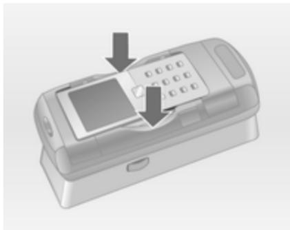
Z odprtimi strankimi nosilci vmesnika spustite telefon v vmesnik navpično, kot prikazuje zgornja slika, da se stranska nosilca zatakneta.
