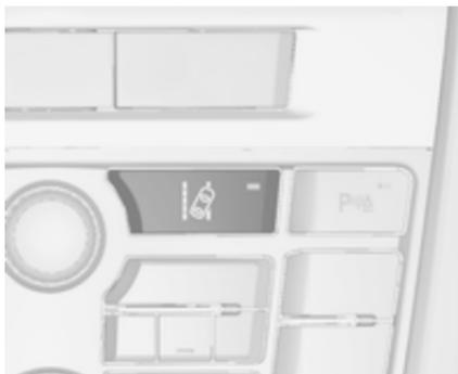
Sistem za opozorilo o nenamerni menjavi voznega pasu se aktivira s pritiskom gumba **L**. LED v stikalu označuje, da je sistem vključen. Kadar kontrolna lučka **L** na instrumentni tabli sveti zeleno, je sistem pripravljen na delovanje.
