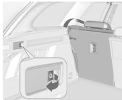
Za preklop zelenega dela zadnjega sedeža povlecite stikalo na desni bočni steni prtljažnega prostora.
