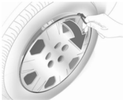
1. Pokrove vijakov odstranite s pomočjo izvijača. S kavljem iztaknite in snemite okrasni pokrov kolesa. Orodje vozila ↗ 190.
