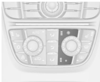
Pritisnite spodnjo tipko za zmanjšanje ali zgornjo tipko za povečanje hitrosti ventilatorja, kot kaže slika. Na zaslonu prikaže število segmentov izbrano stopnjo hitrosti ventilatorja.
