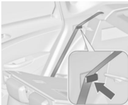
Če nameravate natovarjati vozilo skozi zadnja vrata, iztaknite varnostni pas iz vodila, ga navijte navzgor in vstavite za stransko držalo, kot prikazuje slika.
