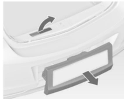
Potegnite zaklepni vzvogar. Sistem se sprostí in izskočí iz odbijača.
