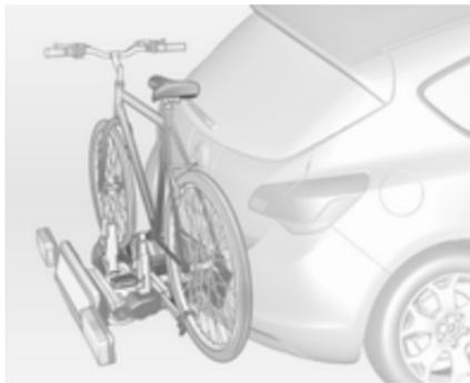
Zadnji nosilec (Flex-Fix sistem) omogoča nameščanje dveh koles na raztegljiv nosilec, ki je integriran v dno vozila.
