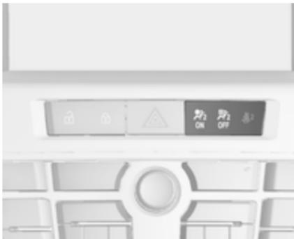
Če kontrolna lučka
