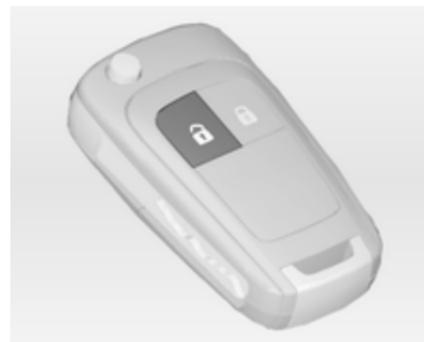
V ta namen pritisnite pri izključenem kontaktu tipko
