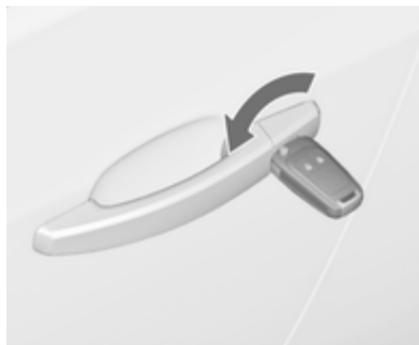
Odklenite voznikova vrata z obratom ključa v ključavnici. Vključite kontakt in pritisnite stikalo
