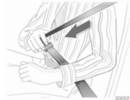
Enakomerno potegnite pas iz navijalca, ga nezvitega namestite čez telo in vstavite zaponko v zaklep, da se slišno zaskoči. Med vožnjo si pas na diagonalnem delu večkrat zategnite. Opozoril za pripenjanje varnostnega pasu ⇨ 94.
