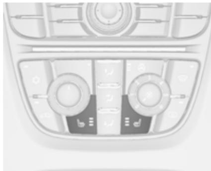
Nastavite želeno stopnjo ogrevanja s pritiskom ustreznega stikala
