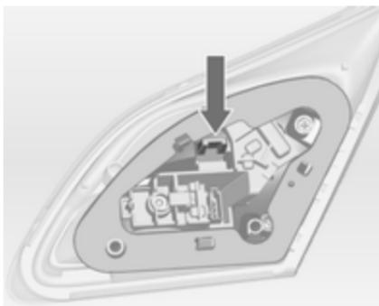
4. Pritisnite pritrdilno zaponko in odstranite nosilec žarnic iz luči.
