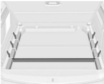
Vstavite drog v vodila na bočnih stenah.
