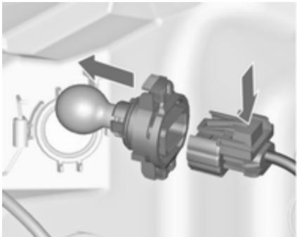
3. Nosilec z žarnico razvlecite s kabelskega priključka s pritiskom pritrilne zaponke.
