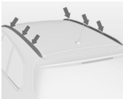
Za nameščanje strešnega prtljažnika vstavite pritrdilne vijke v odprtine, prikazane na ilustraciji.
