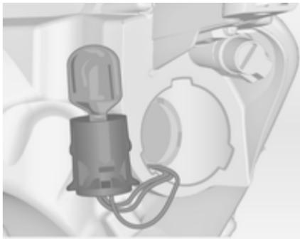
3. Iz nosilca izvlecite žarnico in vstavite novo.
