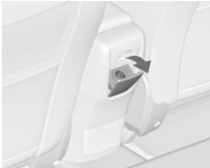
Dodatna 12-voltarna električna vtičnica se nahaja v zadnji konzoli. Pokrov preklopite navzdol.
