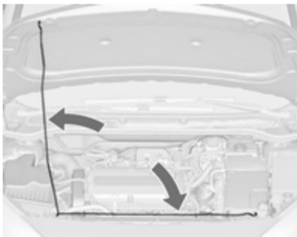
Zataknite podporno prečko.
