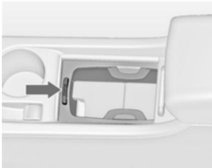
Za odstranitev okvira držala za pijačo pritisnite gumb. Okvir lahko pospravite v sovoznikov predal.
