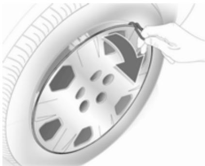
1. Pokrove vijakov odstranite s pomočjo izvijača. S kavljem iztaknite in snemite okrasni pokrov kolesa. Orodje vozila  $\diamond 200$ .
