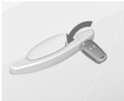
Odklenite voznikova vrata z obratom ključa v ključavnici. Vključite kontakt in pritisnite stikalo
