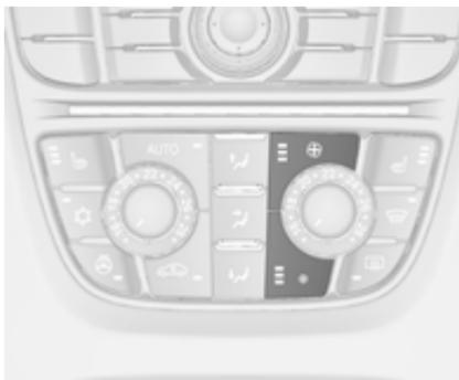
Pritisnite spodnjo tipko za zmanjšanje ali zgornjo tipko za povečanje hitrosti ventilatorja, kot kaže slika. Na zaslonu prikaže število segmentov izbrano stopnjo hitrosti ventilatorja. Daljši pritisk spodnje tipke izklopi ventilator in hlajenje. Daljši pritisk zgornje tipke vklopi najvišjo stopnjo ventilatorja.
