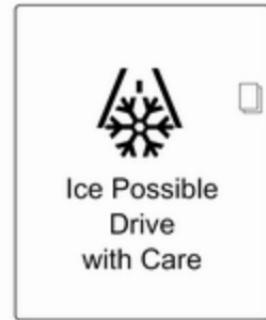
Če se zunanja temperatura zniža na 3 °C, se na voznikovem informacijskem zaslonu višje stopnje prikaže opozorilo.
