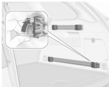
Ročico (vzvod) adapterja preklopite navzgor, adapter vstavite v zgornjo in spodnjo režo vodila in ga pomaknite v želeni položaj. Za pririditev adapterja obrnite vzvod navzgor. Za odstranitev obrnite vzvod navzdol in ga izvlecite iz vodila.
