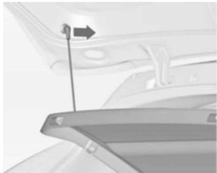
Iztaknite nosilni vrvici z vrat prtljažnika.
