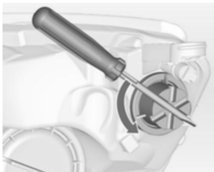
1. Zasukajte pokrov v nasprotno smer urinega kazalca in ga snemite. Za zasuk pokrova uporabite izvijač.
