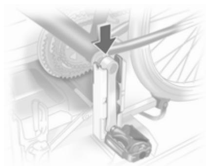
Postavite kolo na nosilec. Ojnicu pedala vstavite v odprtino v držalu za pedalo, kot je prikazano na zgornji sliki.
