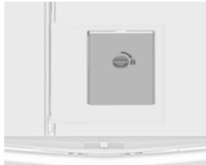
Zaprt pokrov lahko zavarujete s strani prtljažnega prostora. Obrnite gumb 90°:
