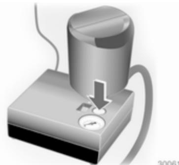
Če predpisani tlak ni dosežen v roku 10-ih minut, odstranite komplet za popravilo pnevmatik. Premaknite vozilo za en obrat kolesa. Ponovno priklopite komplet za popravilo pnevmatik in nadaljujte s postopkom polnjenja.
