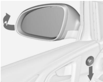
Obrnite stikalo v 0, nato pritisnite stikalo navzdol. Obe zunanji ogledali se preklopita.
