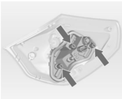
6. S kovancem odvijte tri vijke in demontirajte nosilec žarnic.
