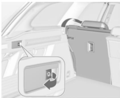
Za preklop želenega dela zadnjega sedeža povlecite stikalo na desni bočni steni prtljažnega prostora.
