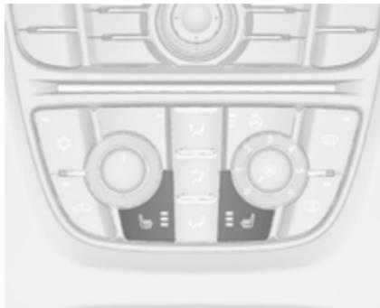
Nastavite želeno stopnjo ogrevanja s pritiskom ustreznega stikala enkrat ali večkrat. Indikator v stiku označuje nastavitev.
