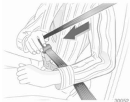
Enakomerno potegnite pas iz navjalca, ga nezvitega namestite čez telo in vstavite zaponko v zaklep, da se slišno zaskoči. Med vožnjo si pas na diagonalnem delu večkrat zategnjite. Opozoril za pripenjanje varnostnega pasu ⇨ 102.
