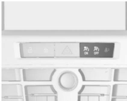
Če kontrolna lučka ✖ ne sveti, se sovoznikova varnostna blazina sproži v primeru trka.
