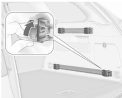
Ročico (vzvod) adapterja preklopite navzgor, adapter vstavite v zgornjo in spodnjo režo vodila in ga pomaknite v želeni položaj. Za pritrditev adapterja obrnite vzvod navzgor. Za odstranitev obrnite vzvod navzdol in ga izvlecite iz vodila.
