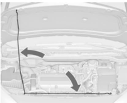
Zataknite podporno prečko.
