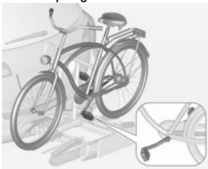
1. Obrnite pedala v položaj (ki je prikazan na sliki) in postavite kolo v prvo podporo za kolo.
