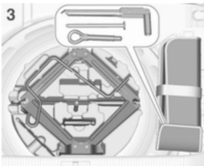
Dvigalko in orodje najdete v škatli z orodjem pod rezervnim kolesom v prtljažniku. Ključ za kolesa, obroček za vleko in dolgi vijak za pritrditev poškodovanega kolesa (samo vozila z zasilnim rezervnim kolesom) so v vreči za orodje, ki je spravljena v vdolbini za rezervno kolo zraven škatle z orodjem. Rezervno kolo  $\diamond$  275.
