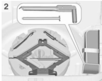
Dvigalka, orodje in obroček za vleko so v škatli z orodjem pod rezervnim kolesom v prtljažniku. Ključ za kolesa in dolgi vijak za pritrditev poškodovanega kolesa (samo vozila z zasilnim rezervnim kolesom) so v vreči za orodje, ki je spravljena v vdolbini za rezervno kolo zraven škatle z orodjem. Rezervno kolo ⌀ 275.
