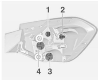
6. Odstranite držalo žarnice, tako da ga obrnete na levo. Novo žarnico previdno potisnite v držalo in jo obrnite na levo.
