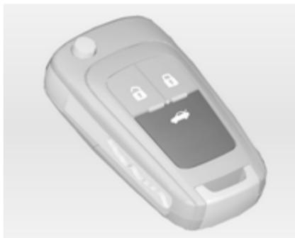
Za odklepanje pokrova prtljažnika pritisnite tipko na daljinskem upravljalniku za najmanj 2 sekundi ali - v potniški kabini - pritisnite tipko na sredinski konzoli; pokrov prtljažnika se rahlo odpre.
