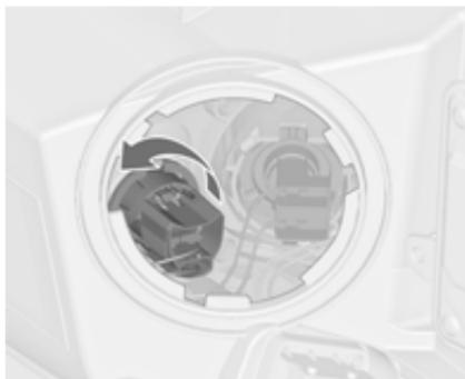
2. Obrnite držalo žarnice na levo, da se sprosti, in ga odstranite iz reflektorja.
