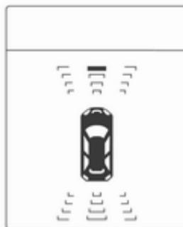
Pri izvedbi s kombiniranim zaslonom višje stopnje se razdalja od ovir pred in za vozilom vozilom prikazuje s spremenljajočimi se črtami okrog vozila.
