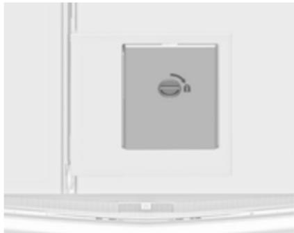
Zaprt pokrov lahko zavarujete s strani prtljažnega prostora. Obrnite gumb 90°:
