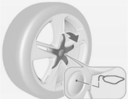
Aluminijasta platišča s središčnim pokrovom vijakov: Sprostite sredinski pokrov, tako da najprej vstavite izvlečni pripomoček v vdolbino avtomobilske značke, nato pa ga potegnete; orodje vozila ⇨ 260.
