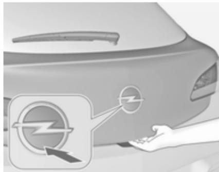
Za odklepanje in odpiranje vrat prtljažnika pritisnite tipko na radijskem daljinskem upravljalniku ali pritisnite na spodnjo polovico avtomobilske značke.
