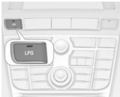
Po pritisku na tipko **LPG** se preklop med bencinskim in plinskim pogonom izvrši, takoj ko so izpolnjeni zahtevani pogoji (temperatura hladilne tekočine, temperatura plina in minimalno število vrtljajev motorja). Ti pogoji so običajno izpoljeni po približno 60 sekundah (odvisno od zunanje temperature) in prvem odločnejšem pritisku na pedal za plin. Stanje LED lučk opozarja na trenutni način delovanja.
