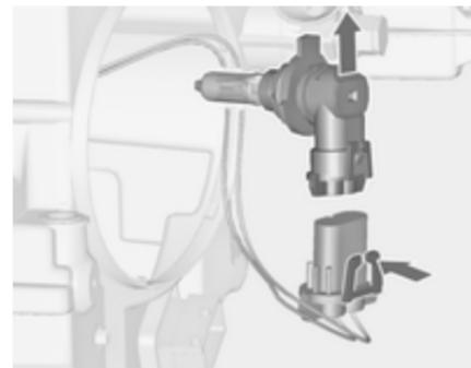
3. Nosilec z žarnico razvlecite s kabelskega priključka s pritiskom pritrdilne zaponke.
