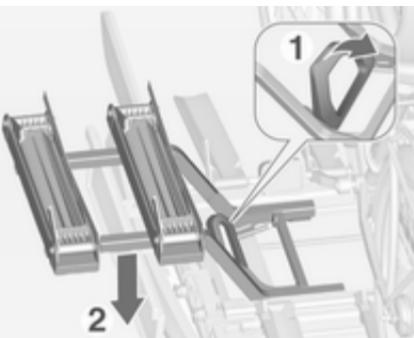
2. Obrnite ročico (1) naprej in jo držite, nato pa spustite adapter (2) v zadnjem delu.
