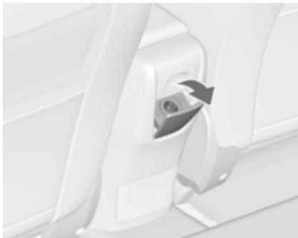
Dodatna 12-voltna električna vtičnica se nahaja v zadnji konzoli. Pokrov preklopite navzdol.
