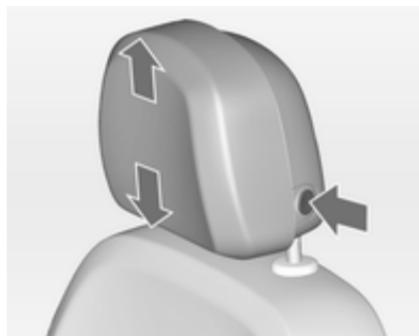
S pritiskom na gumb vzglavnik sprostite, nastavite višino in pustite, da se zaskoči v zavarovanem položaju.
