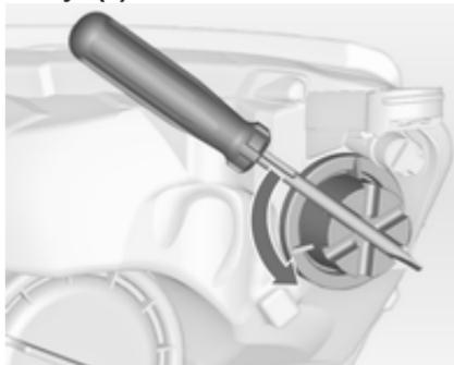
1. Zasukajte pokrov (3) v nasprotno smer urinega kazalca in ga snemite. Za zasuk pokrova uporabite izvijač.
