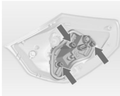
6. Odvijte tri vijke z izvijačem in odstranite nosilec žarnice iz sestava luči.
