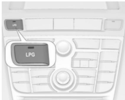
S pritiskom na gumb **LPG** preklapljate med pogonom na bencin in pogonom na utekočinjen naftni plin. Stanje LED-lučk ■ opozarja na trenutni način delovanja.
