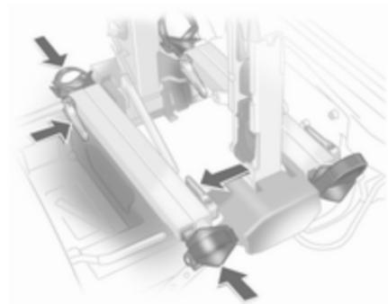
Pritisnite sprostitveni vzvod in potisnite pritrdilna vodila za zračnice do blokade.
