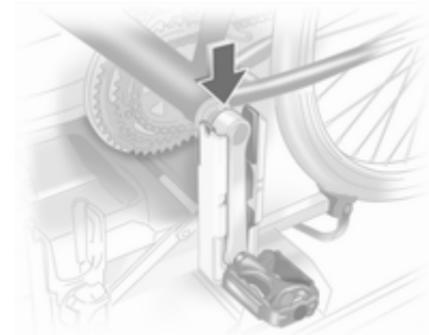
Postavite kolo na nosilec. Ojnice pedala vstavite v odprtino v držalu za pedalo, kot je prikazano na zgornji sliki.
