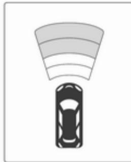
Pri izvedbi z zaslonom višje stopnje se razdalja od ovir pred vozilom prikazuje s spremenljajočimi se segmenti.
