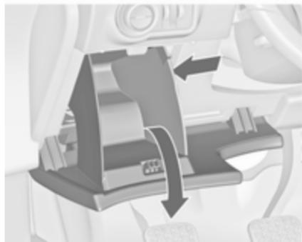
V modelih z volantom na desni: škatla varovalk se nahaja za prostorom za spravljanje v armaturni plošči.
