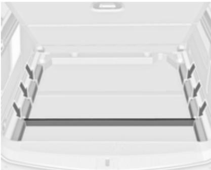
Vstavite drog v vodili na bočnih stenah.
