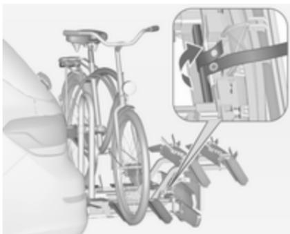
4. Napeljite trak, ki je pritrjen na adapterju, pod ročico za preklop nosilca na zadku vozila. Pritrdite trak.
