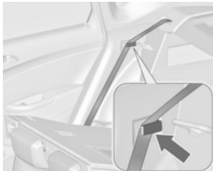
Če nameravate natovarjati vozilo skozi zadnja vrata, iztaknite varnostni pas iz vodila, ga navijte navzgor in vstavite za stransko držalo (kot kaže slika).
