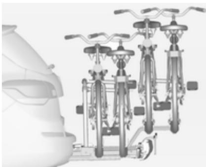
Nosilec na zadku vozila (Flex-Fix sistem) omogoča nameščanje dveh koles na raztegljiv nosilec, ki je vgrajen v podvozju. Adapter omogoča pritrditev dveh dodatnih koles. Prevoz drugih stvari ni priporočljiv.
