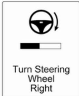
Predlog za parkirni prostor sistema je sprejet, ko voznik ustavi vozilo v 10-ih metrih po sporočilu za zaustavitev. Sistem izračuna optimalno pot na parkirno mesto. Nato vodi voznika na to mesto z natančnimi napotki.
