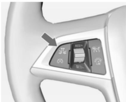
Pritisnite gumb **SET**. Trenutna nastavitev se prikaže na informacijskem centru voznika. Znova pritisnite gumb **SET**, da spremenite razdaljo sledenja. Nastavitev se prikaže tudi v zgornji vrstici voznikovega informacijskega zaslona.
