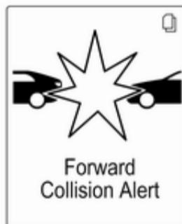
Če sistem zazna vozilo v smeri vožnje pred vami, se v instrumentni plošči prizge zelena kontrolna lučka za spredaj vočevo vozilo . Če se razdalja od spredaj vočevega vozila preveč zmanjša ali če se prehitro približujete drugemu vozilu in grozi neposredna nevarnost trka, se na voznikovem informacijskem zaslonu pojavi simbol za opozorilo pred trkom. Hkrati se oglasi tudi zvočni signal.
