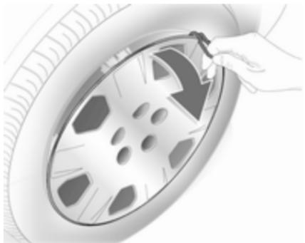
1. Pokrove vijakov odstranite s pomočjo izvijača. S kavljem iztaknite in snemite okrasni pokrov kolesa. Orodje vozila ⇨ 260.
