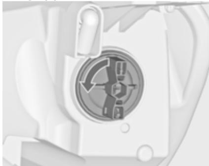
1. Držalo žarnice (2) obrnite v obratno smer urinega kazalca. Izvlecite držalo žarnice iz žarometa.
