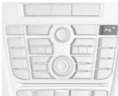
Parkirnega pomočnika lahko vklopite in izklopite s pritiskom na njegov gumb **P**▲. Če je vozilo dodatno opremljeno z naprednim parkirnim pomočnikom ⇨ 202, je le-ta opremljen s tipko **■**. V tem primeru upravljate oba sistema s tipko **■**.
