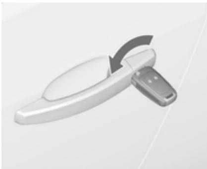
Odklenite voznikova vrata z obratom ključa v ključavnici. Vključite kontakt in pritisnite stikalo za odklepanje vseh ostalih vrat, prtljažnika in lopute rezervoarja goriva. Z vključitvijo vžiga se mehansko varovanje (zapah) izključi.
