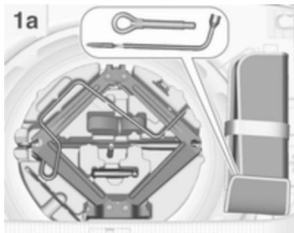
Dvigalka, orodja in jermen za pritrditev defektnega kolesa so spravljeni v škatli z orodjem pod rezervnim kolesom v prtljažniku. Ključ za kolesa in obroček za vleko sta v vreči za orodje, ki je spravljena v vdolbini za rezervno kolo zraven škatle z orodjem. Rezervno kolo ⌀ 275.
