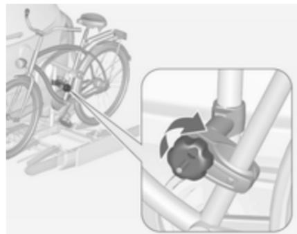
2. Pritrdite kratko pritrdilno konzolo na okvir kolesa. Zategnjte gumb z vrtenjem v smeri urnega kazalca.
