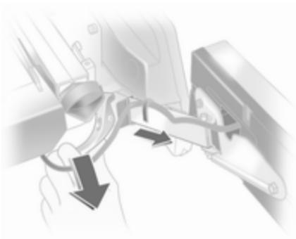
Zaklopec potisnite navzdol in potegnite oboja nosilca luči iz sidrišč.
