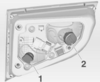
4. Odstranite držalo žarnice, tako da ga obrnete na levo. Novo žarnico previdno potisnite v držalo in jo obrnite na levo.
