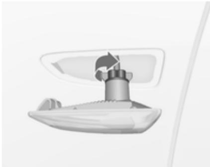
2. Obrnite držalo žarnice na levo in ga odstranite iz ohišja.
