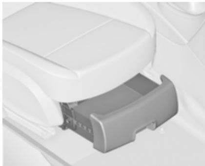
Pritisnite gumb v odprtini in izvlecite predal. Maksimalna nosilnost: 3 kg.
