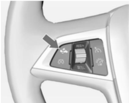
Pritisnite gumb . Trenutna nastavitev se prikaže na informacijskem centru voznika. Znova pritisnite gumb , da spremenite občutljivost opozorila.
