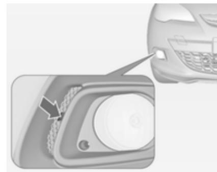
1. Vstavite izvijač v vdolbino in sprostite ter odstranite zaščitni pokrov.
