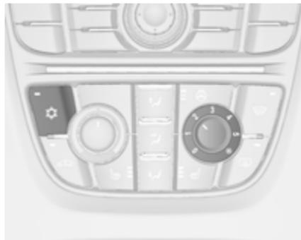
Za vklop hlajenja pritisnite tipko . Vklop signalizira LED indikator v stikalu. Hlajenje deluje samo, kadar teče motor in je vključen ventilator sistema za ogrevanje, prezračevanje, hlajenje.
