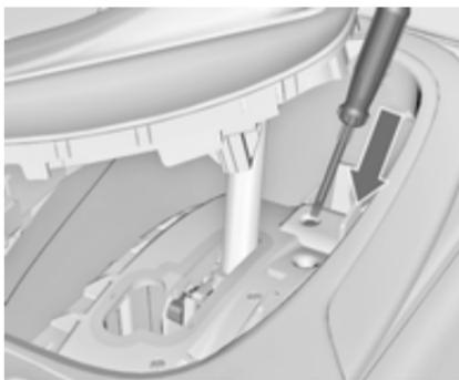
3. V odprtino vstavite izvijač do konca in premaknite izbirno ročico iz **P** ali **N**. Če pretaknete znova v **P** ali **N**, se ročica ponovno blokira. Vzrok prekiniteve napajanja dajte nemudoma odpraviti strokovnjakom v servisni delavnici.
