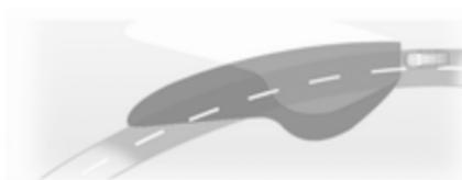
Zglobi žarometov se obračajo v odvisnosti od zavoja volana in hitrosti vozila za boljšo osvetlitev zavojev. Kontrolna lučka  $\Rightarrow \Delta 120$ .
