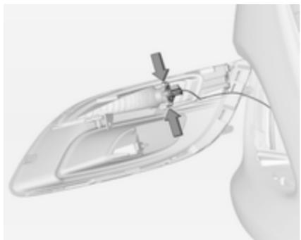
3. Držalo žarnice sprostite z reflektorja s pritiskom na obe pritrdirilni zaponki.
