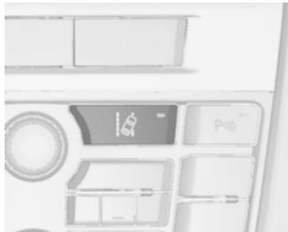
Sistem za opozorilo o nenamernej menjavi voznega pasu se aktivira s pritiskom gumba . LED v stikaluhu označuje, da je sistem vključen. Kadar kontrolna lučka na instrumentni tabli sveti zeleno, je sistem pripravljen na delovanje.
