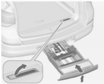
Povlecite zaklepni vzvod navzgor. Sistem rahlo dvignite in ga potisnite v odbijač, da se zaskoči.
