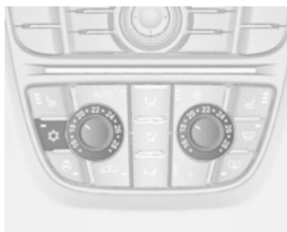
Za vklop hlajenja pritisnite
