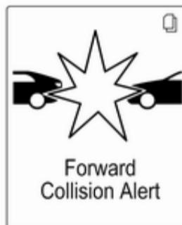
Če sistem zazna vozilo v smeri vožnje pred vami, se na instrumentni plošči prizge zelena kontrolna lučka za spredaj vočevo vozilo . Če se razdalja od spredaj vočevega vozila preveč zmanjša ali če se prehitro približujete drugemu vozilu in grozi neposredna nevarnost trka, se na voznikovem informacijskem zaslolu pojavi simbol za opozorilo pred trkom. Istočasno se ogledi zvočno opozorilo. Pritisnite zavorno stopalko, če to od vas zahteva situacija.
