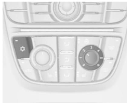
Za vklop hlajenja pritisnite . Vklop signalizira LED lučka v stikaluh. Hlajenje deluje samo, kadar teče motor in je vključen ventilator sistema za ogrevanje, prezračevanje, hlajenje.
