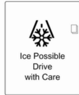
Če se zunanjna temperatura zniža na 3 °C, se na kombiniranem voznikovem informacijskem zaslonu višje stopnje prikaže opozorilo.
