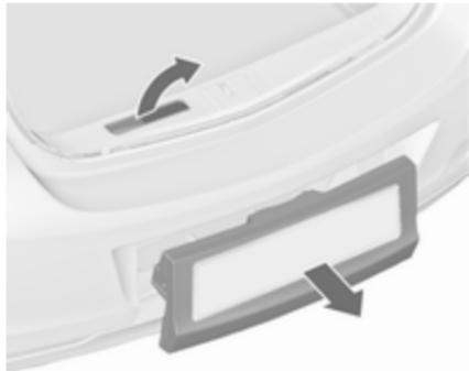
Potegnite zaklepni vzvod navzgor. Sistem se sprosti in izskoči iz odbijača.
