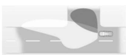
V ostrih zavojih ali pri zavijanju s ceste - odvisno od kota volana in/ali vklopa smernikov - se vklopi dodaten žaromet, ki osvetli cesto v pravem kotu v želeni smeri vožnje. Funkcija deluje le pod hitrostjo 40 km/h.
