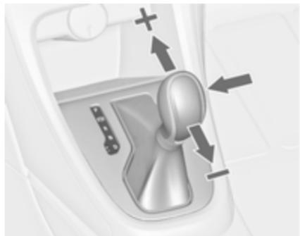
Izbirno ročico premaknite iz položaja D proti levi, da izberete ročni način M.
