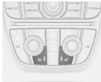
Nastavite želeno stopnjo ogrevanja s pritiskom na enkrat ali večkrat. Indikator v stikalu označuje nastavitev.
