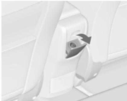
Dodatna 12-voltna električna vtičnica se nahaja v zadnji konzoli. Pokrov preklopite navzdol.
