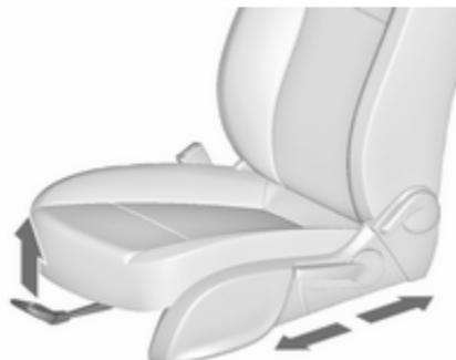
Potegnite ročico, pomaknite sedež, sprostite ročico. Sedež poskušajte pomakniti naprej in nazaj, da preverite, ali je pritrjen v ustreznom položaju.
