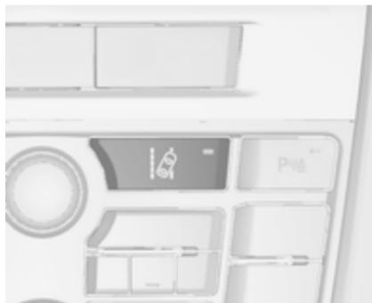
Sistem za opozorilo o nenamerni menjavi voznega pasu se aktivira s pritiskom . LED v stikalu označuje, da je sistem vključen. Kadar kontrolna lučka na instrumentni plošči sveti zeleno, je sistem pripravljen na delovanje.
