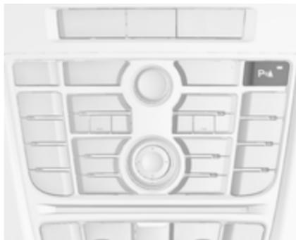
Parkirni pomočnik spredaj-zadaj je opremljen s tipko **P**▲. Če je vozilo dodatno opremljeno z naprednim parkirnim pomočnikom (glejte ločen opis v nadaljevanju), je sistem mogoče upravljati s tipko **■P**▲. V tem primeru upravljate oba sistema z **■P**▲.
