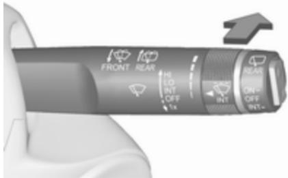
Potisnite ročično stikalo naprej. Šoba poškropi zadnje steklo, obenem brisalec nekajkrat obriše steklo.
