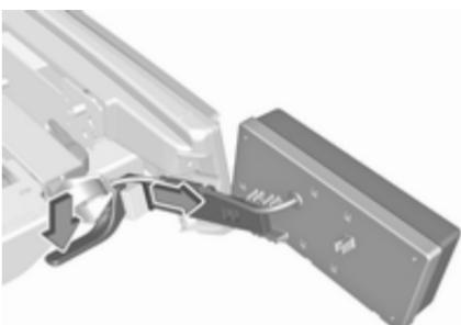
Zaklopec potisnite navzdol in potegnite oboja nosilca luči iz sidrišč.
