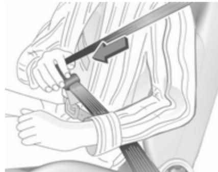
Enakomerno potegnite pas iz navijalca, ga nezvitega namestite čez telo in vstavite zaponko v zaklep, da se slišno zaskoči. Med vožnjo si pas na diagonalnem delu večkrat zategnjite.
