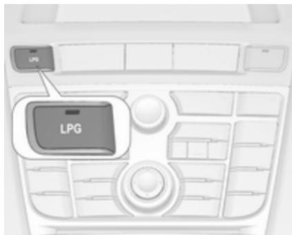
Pritisnite **LPG** za preklapljanje med pogonom na bencin in pogonom na utekočinjen naftni plin. Stanje LED-lučk — opozarja na trenutni način delovanja.
