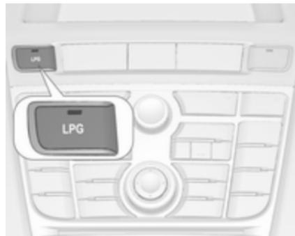
Po pritisku **LPG** se preklop med bencinskim in plinskim pogonom izvrši, takoj ko so izpolnjeni zahtevani pogoji (temperatura hladilne tekočine, temperatura plina in minimalno število vrtljajev motorja). Ti pogoji so običajno izpolnjeni po približno 60 sekundah (odvisno od zunanje temperature) in prvem odločnejšem pritisku na pedal za plin. Stanje LED lučk opozarja na trenutni način delovanja.
