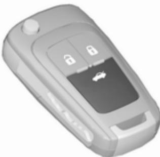
Za odklepanje pokrova prtljažnika pritisnite na daljinskom upravljalniku za najmanj 2 sekundi ali - v potniški kabini - pritisnite na sredinski konzoli; pokrov prtljažnika se rahlo odpre.
