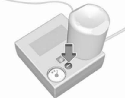
Če predpisani tlak ni dosežen v roku 10 minut, odstranite komplet za popravilo pnevmatik. Premaknite vozilo za en obrat kolesa. Ponovno priklopite komplet za popravilo pnevmatik in nadaljujte s postopkom polnjenja pnevmatike še dodatnih 10 minut. Če predpisani tlak tudi po naknadnih 10-ih minutah ni dosežen, je pnevmatika preveč poškodovana. Poiščite strokovno pomoč v servisni delavnici.
