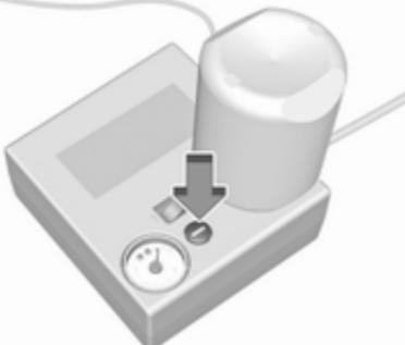
Če predpisani tlak ni dosežen v roku desetih minut, odstranite komplet za popravilo pnevmatik. Premaknite vozilo za en obrat kolesa. Ponovno priklopite komplet za popravilo pnevmatik in nadaljujte s postopkom polnjenja pnevmatike še dodatnih deset minut. Če predpisani tlak tudi po naknadnih 10-ih minutah ni dosežen, je pnevmatika preveč poškodovana. Poiščite strokovno pomoč v servisni delavnici. Presežek tlaka izpustite s pritiskom na gumb nad številčnico kompresorja.
