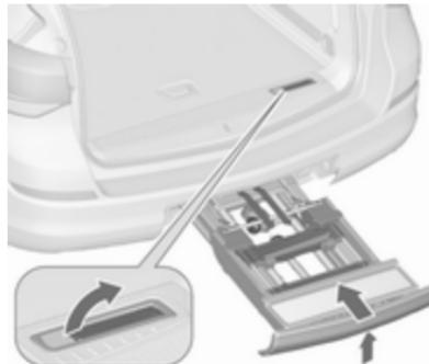
Povlecite zaklepni vzvod navzgor. Sistem rahlo dvignite in ga potisnite v odbijač, da se zaskoči.
