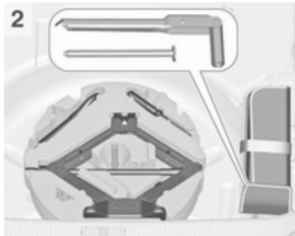
Dvigalka, orodje in obroček za vleko so v škatli z orodjem pod rezervnim kolesom v prtljažniku. Ključ za kolesa in dolgi vijak za pritrditev poškodovanega kolesa (samo vozila z zasilnim rezervnim kolesom) so v vreči za orodje, ki je spravljena v vdolbini za rezervno kolo zraven škatle z orodjem. Rezervno kolo  $\diamond 283$ .
