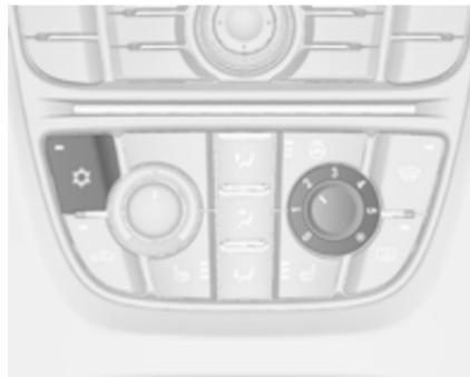
Za vklop hlajenja pritisnite . Vklop signalizira LED lučka v stikalnu. Hlajenje deluje samo, kadar teče motor in je vključen ventilator sistema za ogrevanje, prezračevanje, hlajenje.
