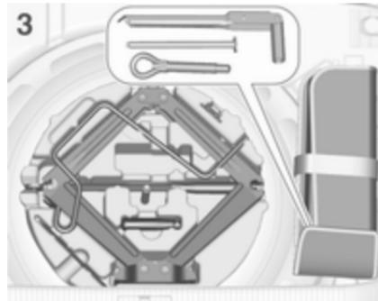
Dvigalka in orodje najdete v škatli z orodjem pod rezervnim kolesom v prtljažniku. Ključ za kolesa, obroček za vleko in dolgi vijak za pritrditev poškodovanega kolesa (samo vozila z zasilnim rezervnim kolesom) so v vreči za orodje, ki je spravljena v vdolbini za rezervno kolo zraven škatle z orodjem. Rezervno kolo  $\diamond 283$ .
