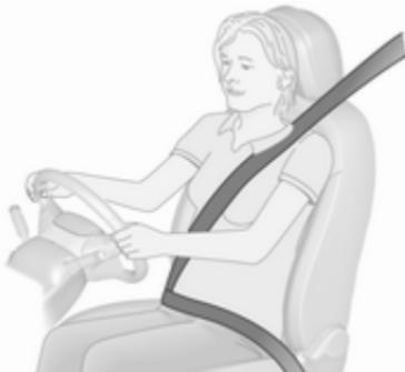
Izvlecite varnostni pas in ga zataknite v zaklep. Bočni del pasu ne sme biti zvit na nobenem delu in se mora tesno prilegati k telesu. Naslonjalo naj ne bo nagnjeno preveč nazaj (priporočen kot nagiba: največ 25°). Pas odpnete s pritiskom na rdeč gumb na zaklepu.
