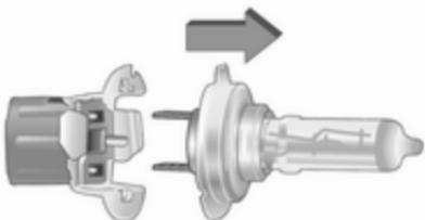
3. Žarnico iztaknite iz nosilca in vstavite novo.
