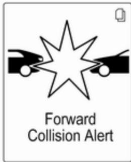
Če sistem zazna vozilo v smeri vožnje pred vami, se na instrumentni plošči priže zelena kontrolna lučka za spredaj vozeče vozilo . Če se razdalja od spredaj vozečega vozila preveč zmanjša ali če se prehitro približujete drugemu vozilu in grozi neposredna nevarnost trka, se na voznikovem informacijskem zaslonu pojavi simbol za opozorilo pred trkom. Hkrati se oglesi tudi zvočni signal. Pritisnite zavorno stopalko, če to od vas zahteva situacija.
