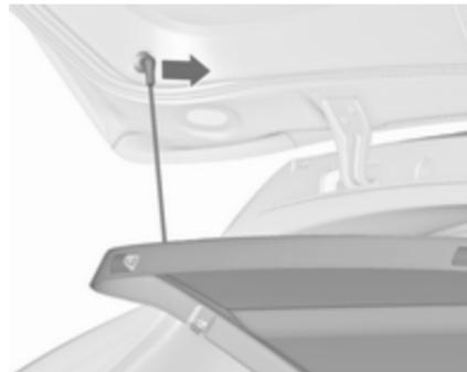
Iztaknite nosilni vrvici z vrat prtljažnika.
