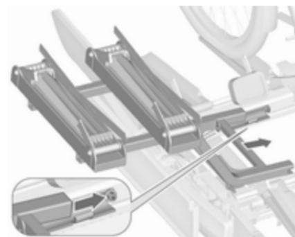
1. Namestite adapter na nosilec na zadku vozila, kot kaže slika.
