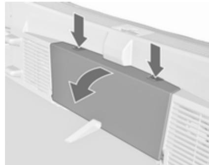
2. Samo 3-vratna kombilimuzina: odstranite zadnji predal za spravljanje s pritiskom na obe tipki. Preklopite pokrov navzdol in povlecite predal navzgor.
