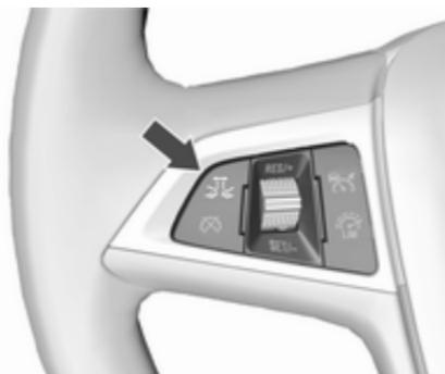
Pritisnite . Trenutna nastavitev se prikaže na voznikovem informacijskem zaslonu. Za spremembo občutljivosti opozorila znova pritisnite . Nastavitev se
