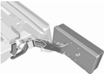
Zaklopec potisnite navzdol in potegnite oba nosilca luči iz sidrišč.
