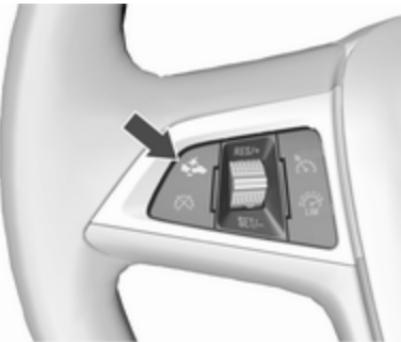
Pritisnite . Trenutna nastavitev se prikaže na voznikovem informacijskem zaslonu. Za spremembo občutljivosti opozorila znova pritisnite .
