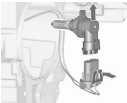
3. Nosilec z žarnico razvlecite s kabelskega priključka s pritiskom pritrdilne zaponke.
