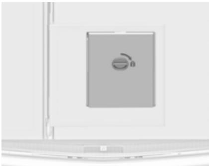
Zaprt pokrov lahko zavarujete s strani prtljažnega prostora. Obrnite gumb  $90^\circ$ :
