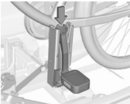
Postavite kolo na nosilec. Ojnice pedala vstavite v odprtino v držalu za pedal, kot je prikazano na zgornji sliki.
