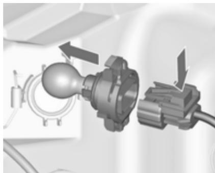
3. Držalo žarnice razvlecite s kabelskega priključka s pritiskom pritrdilne zaponke.
