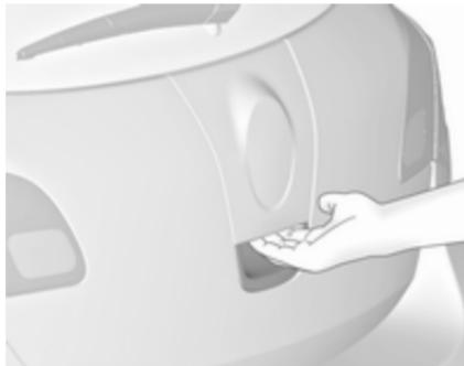
Za odpiranje vrat prtljažnika se dotaknite stikala pod značko znamke.
