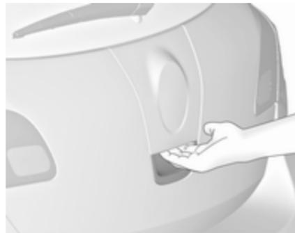
Za odpiranje vrat prtljažnika se dotaknite stikala pod značko znamke na vratih prtljažnika po odklepanju.
