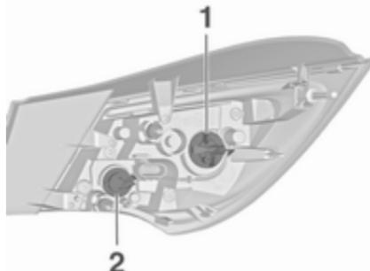
5. Odstranite držalo žarnice, tako da ga obrnete. Novo žarnico previdno potisnite v držalo in jo obrnite na levo.
