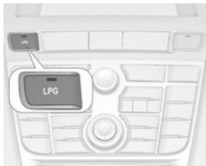
Po pritisku **LPG** se preklop med bencinskim in plinskim pogonom izvrši, takoj ko so izpolnjeni zahtevani pogoji (temperatura hladične tekočine, temperatura plina in minimalno število vrtljajev motorja). Ti pogoji so običajno izpolnjeni po približno 60 sekundah (odvisno od zunanje temperature) in prvem odločnejšem pritisku na pedal za plin. Stanje LED lučk opozarja na trenutni način delovanja.
