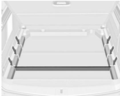
Vstavite drog v vodili na bočnih stenah.
