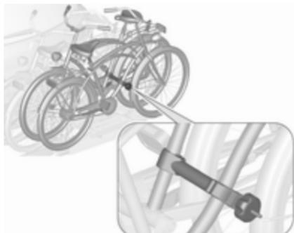
Za pritrditev četrtega kolesa na nosilec uporabite kratko dodatno pritrilnilno konzolo. Pritrilnilno konzolo morate pritrditi med okvirom tretjega in četrtega kolesa.
