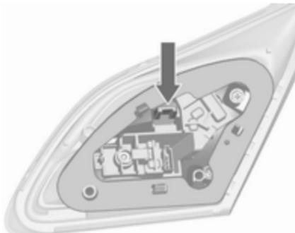
4. Pritisnite pritrdilno zaponko in odstranite nosilec žarnic iz luči.
