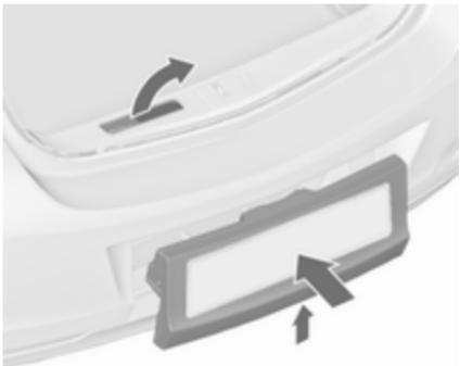
Povlecite zaklepni vzvod navzgor. Sistem rahlo dvignite in ga potisnite v odbijač, da se zaskoči.
