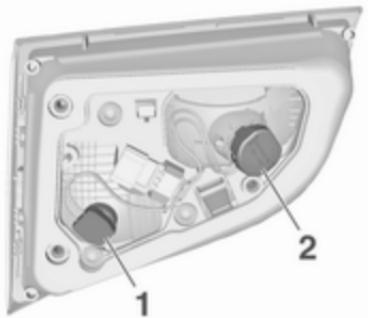
4. Odstranite držalo žarnice, tako da ga obrnete na levo. Novo žarnico previdno potisnite v držalo in jo obrnите na levo.
