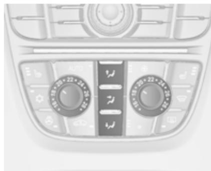
Pritisnite ustrezni gumb za želeno nastavitev. Vklop signalizira LED lučka v stikalnu.
