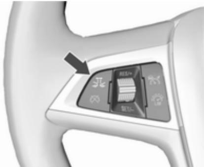
Pritisnite . Trenutna nastavitev se prikaže na voznikovem informacijskem zaslonu. Znova pritisnite , da spremenite razdaljo sledenja. Nastavitev se prikaže tudi v zgornji vrstici voznikovega informacijskega zaslona.
