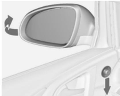
Obrnite stikalo v 0, nato pritisnite stikalo navzdol. Obe zunanjti ogledali se preklopita.
