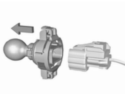
4. Ločite priključni vtič od držala žarnice s pritiskom na vpenjalni ježiček.
