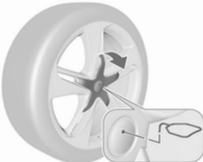
Aluminijasta platišča s središčnim pokrovom vijakov: Sprostite sredinski pokrov, tako da najprej vstavite izvlečni pripomoček v vdolbino avtomobilske značke, nato pa ga potegnete; orodje vozila ⇨ 267.
