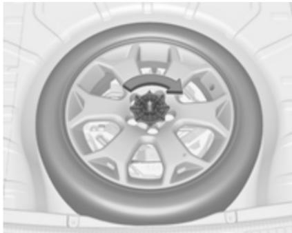
Poškodovano kolo polnih dimenzijs morate spraviti z navzgor obrnjeno zunanjim stranom v vdolbino za rezervno kolo in ga pritrdirti s krilnico.
