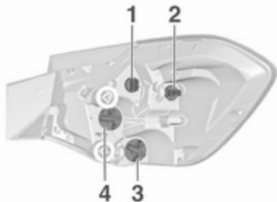
6. Odstranite držalo žarnice, tako da ga obrnete na levo. Novo žarnico previdno potisnite v držalo in jo obrnite na levo.
