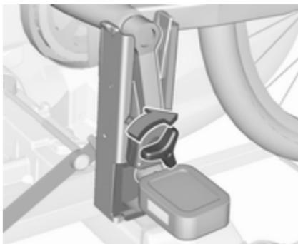
Pritrdite ojnice pedala z obračanjem pritrdilnega vijaka na nastavku za ojnicami.
