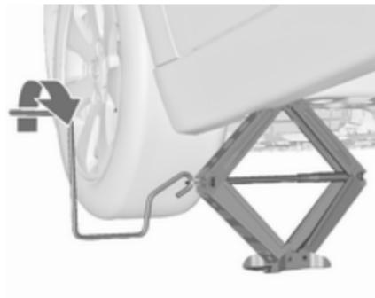
Namestite ročico dvigalke, dvigalko pravilno poravnajte in z vrtenjem ročice dvignite vozilo s tal.
