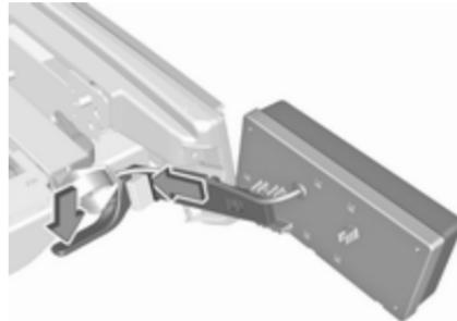
Pritisnite vpenjalno ročico navzdol in potisnite podporo luči v držalo, dokler se ne zaskoči.
