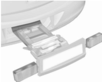
Preverite položaj ožičenja in luči in zagotovite, da so pravilno nameščene in zavarovane.
