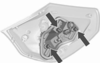
6. Odvijte tri vijke z izvijačem in odstranite nosilec žarnice iz sestava luči.
