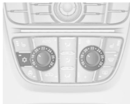
Za vklop hlajenja pritisnite ☀. Vklop signalizira LED lučka v stikalnu. Hlajenje deluje samo, kadar teče
