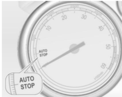
Funkcijo Autostop označuje kazalec v legi **AUTOSTOP** na števcu vrtljajev motorja.
