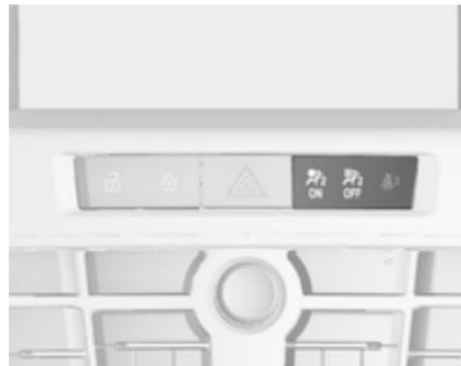
Če kontrolna lučka ✖ po vključitvi kontakta vziga sveti pribl. 60 sekund, je sistem varnostnih blazin na sovoznikovi strani aktivен in se bo v primeru trka sprožil.
