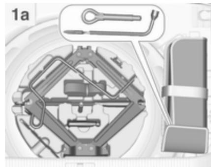
Dvigalka, orodja in jermen za pritrditev defektnega kolesa so spravljeni v škatli z orodjem pod rezervnim kolesom v prtljažniku. Ključ za kolesa in obroček za vleko sta v vreči za orodje, ki je spravljena v vdolbini za rezervno kolo zraven škatle z orodjem. Rezervno kolo ▷ 283.
