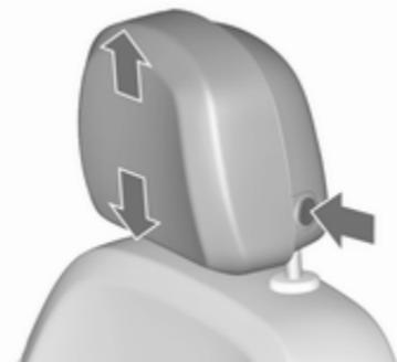
S pritiskom na gumb vzglavnik sprostite, nastavite višino in pustite, da se zaskoči v zavarovanem položaju.
