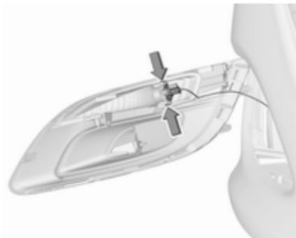
3. Držalo žarnice sprostite z reflektorja s pritiskom na obe pritrdilni zaponki.
