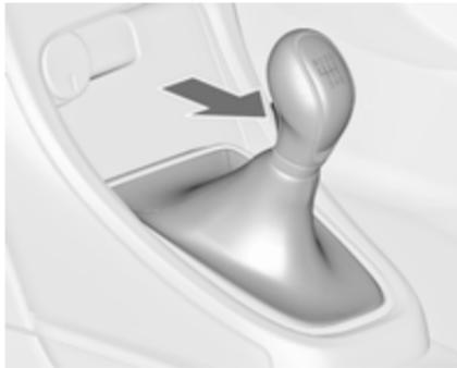
Za vklop vzvratne prestave, ko vozilo miruje, pritisnite pedal sklopke, pritisnite gumb na prestavnici ročici in prestavite.
