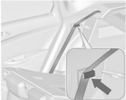
Če nameravate natovarjati vozilo skozi zadnja vrata, iztaknite varnostni pas iz vodila, ga navzgor in vstavite za stransko držalo (kot kaže slika).
