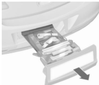
Potegnite zadnji nosilec do konca navzven, da se zaskoči.
